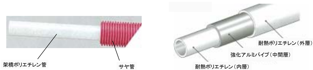
図 3.1.8 ポリエチレン管と外装例
