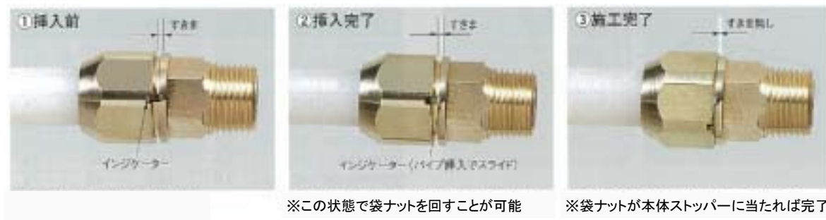
図 3.1.9 ポリエチレン管のメカニカル式継手接合例
