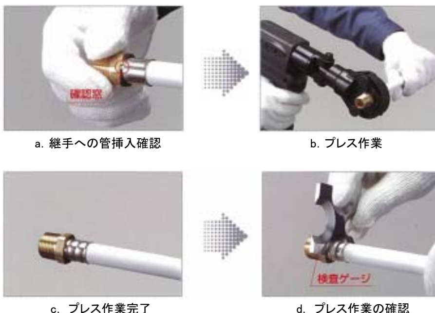
図 3.1.10 ポリエチレン管のプレス式継手接合例
