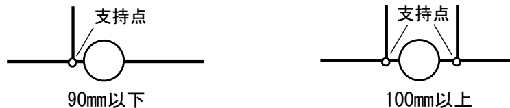
図 3.1.12 弁類などの支持点
