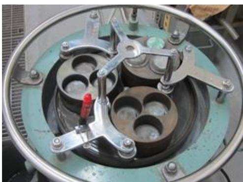
写真 2.3.1-21 養生後の端面研磨状況
