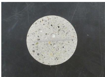
写真 2.3.1-25 界面有り供試体の端面状況上面
