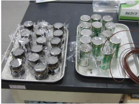
写真 2.3.1-13 打設完了後 1 日養生状況
