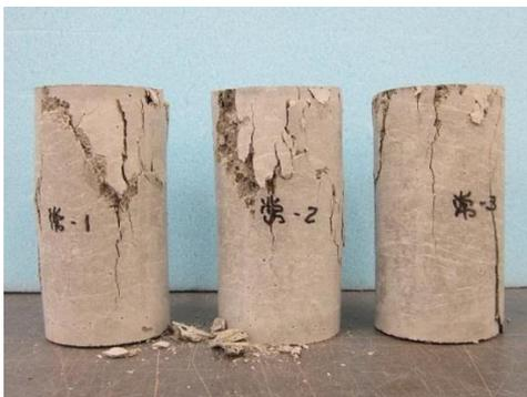
写真 2.3.1-29 常温養生 28 日強度試験破壊状況
