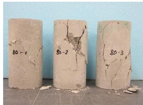
写真 2.3.1-30 80°C養生 28 日強度試験破壊状況
