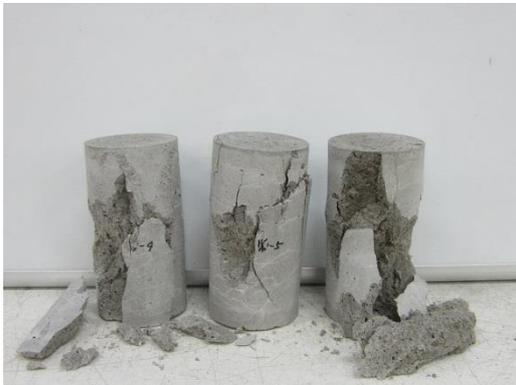
写真 2.3.1-31 常温養生 90 日強度試験
