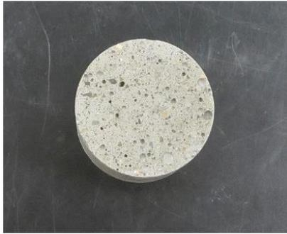
写真 2.3.1-27 界面無し供試体の端面状況上面
