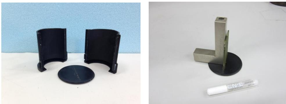
写真 2.2.1-2 プラスチックモールド（左）と底板への設置方法（右）
