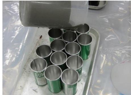
写真 2.3.1-10 一軸圧縮試験用モールド
