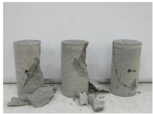
写真 2.3.1-32 80°C養生 90 日強度試験
