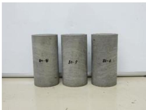
写真 2.3.1-22 一軸圧縮試験用
