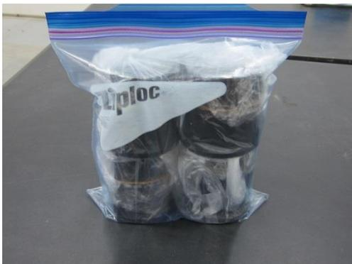
写真 2.3.1-16 透水・透気試験用モールド 2 重ビニール養生状況
