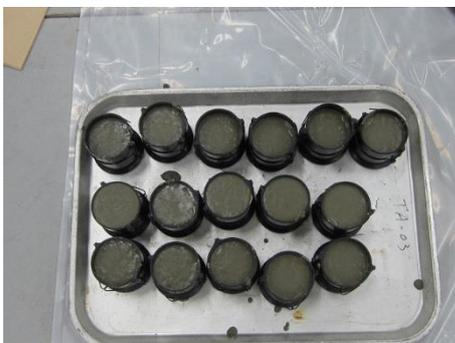
写真 2.3.1-11 透水・透気用モールド打設完了
