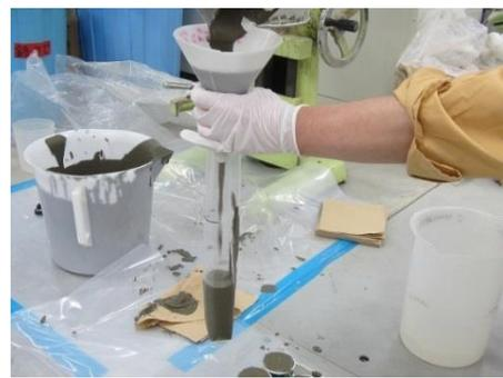
写真 2.3.1-8 一軸圧縮試験用モールド
