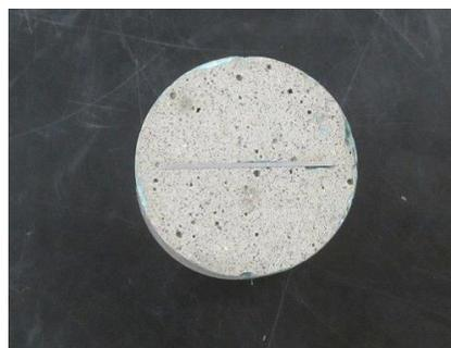
写真 2.3.1-26 界面有り供試体の端面状況下面
