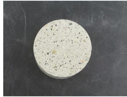
写真 2.3.1-28 界面無し供試体の端面状況下面
