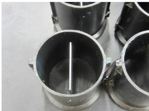
写真 2.3.1-3 金属板取付けモールド
