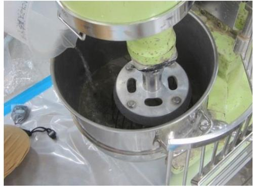
写真 2.3.1-6 ミキサー攪拌状況
