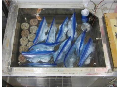
写真 2.3.1-19 熱水槽での 80℃養生状況
