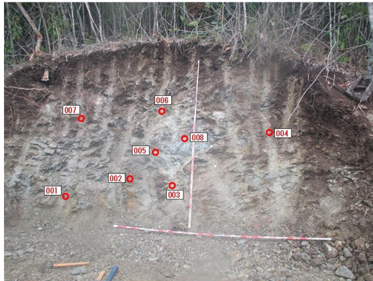
図 2.6.2-8 ストリッピング 3 壁面と(Rh)岩石試料採取位置
