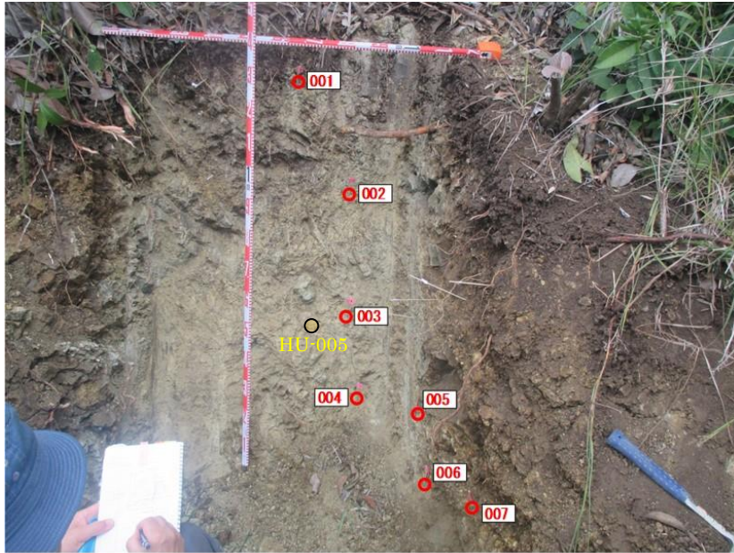
図 2.6.2-6 ストリッピング 2 壁面と(Rh 及び HU-005)岩石試料採取位置
