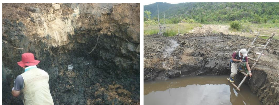
図 2.2.2-14 トレンチ 6 浸出水の採水 (左)、ガス濃度測定 (右)
