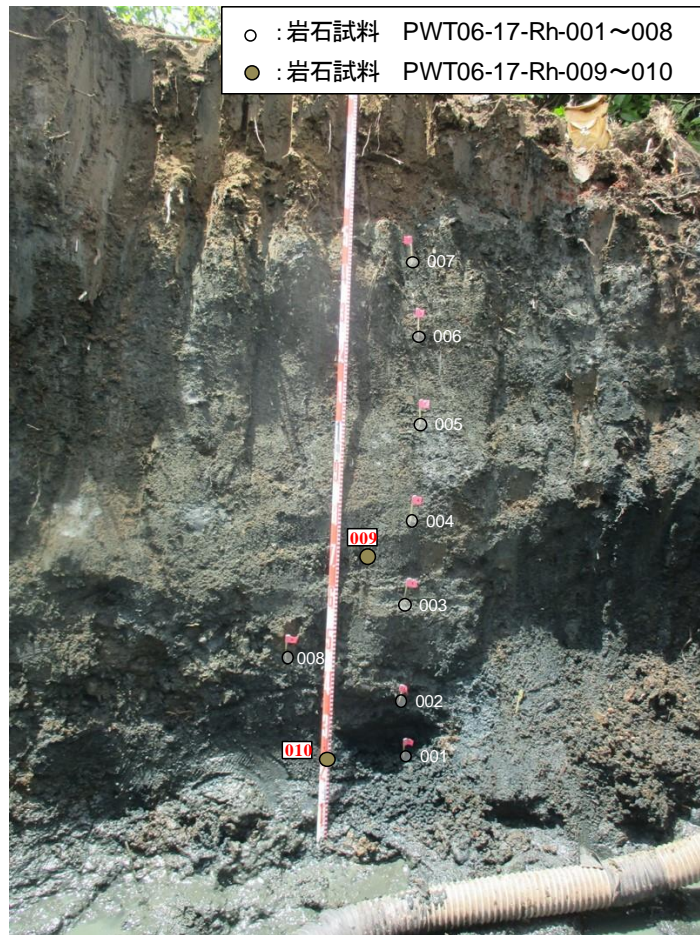
図 2.5.2-7 トレンチ 6 の北壁面と(Rh)岩石試料採取位置
