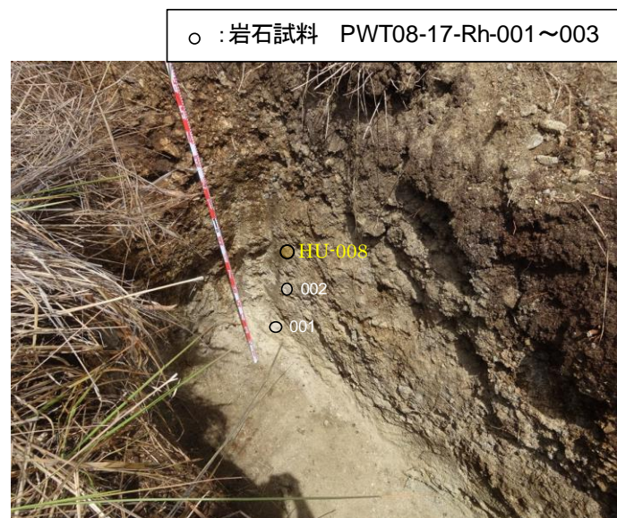
図 2.5.2-17 トレンチ 8 の南壁面～西壁面と(Rh-001~002 及び HU-008)岩石試料採取位置
