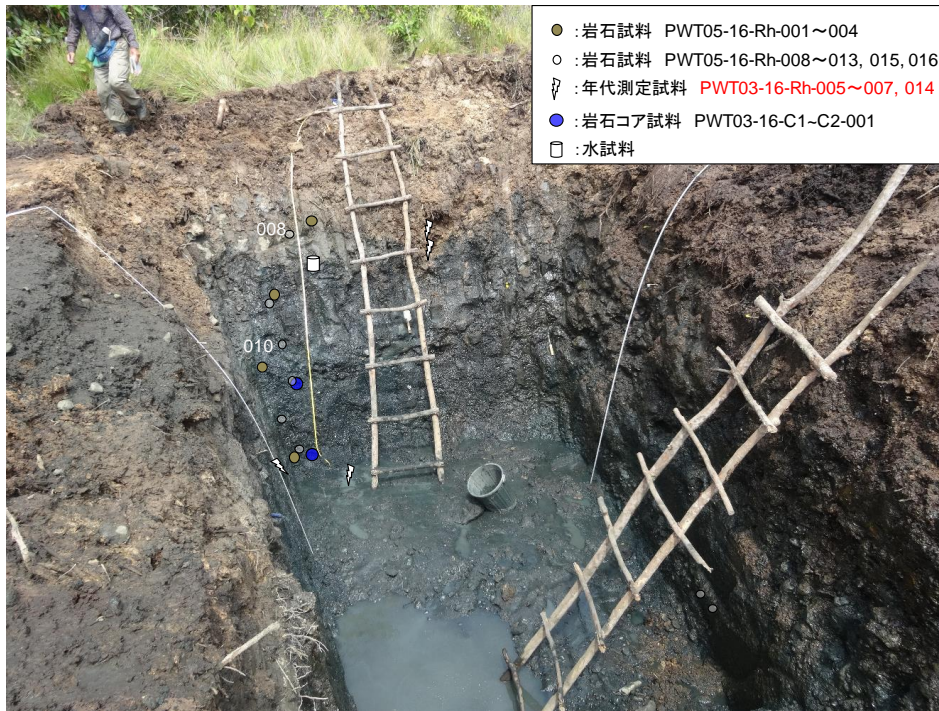
図 2.5.2-25 トレンチ 5 の南壁面の(Rh)岩石試料採取位置
