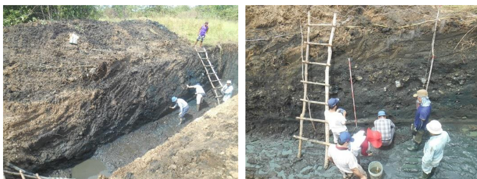
図 2.5.2-2 トレンチ 7 壁面壁面削りだし（右）、サンプリング（右）
