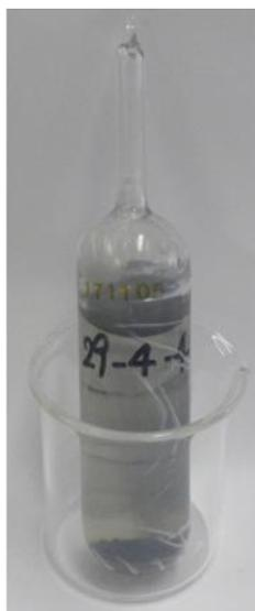
図 5.3.3-2 ガラスサンプル外観 (試験前：酸性)
