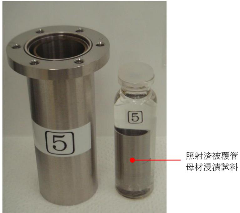
図 3.2.2-2 STEP I 照射済被覆管母材浸漬試料と浸漬容器
