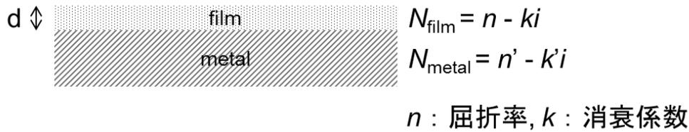
図 2.4.3-1 表面酸化物の構造モデル図と光学定数
