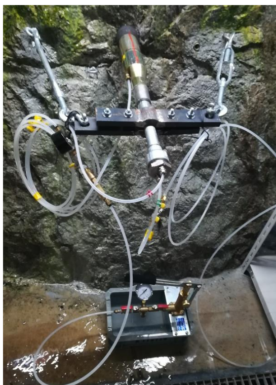
図26 孔内に水を注入するための装置を設置した時の様子
