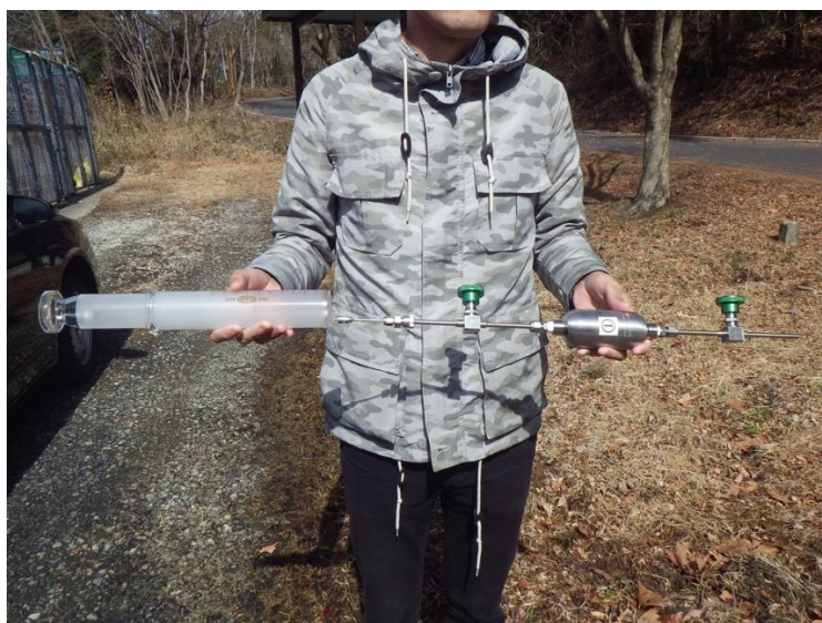
図 26 試料採取時に接続した容器とガラスシリンジ
