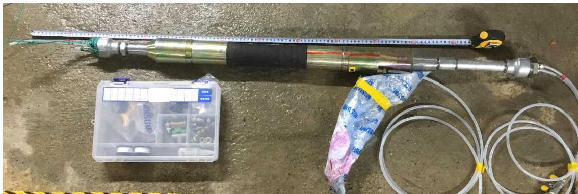
図25 孔内に水を注入するための装置
