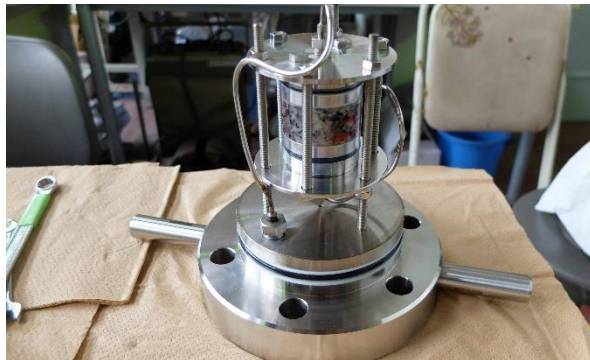
図 10 圧力容器のふたにセットした供試体
