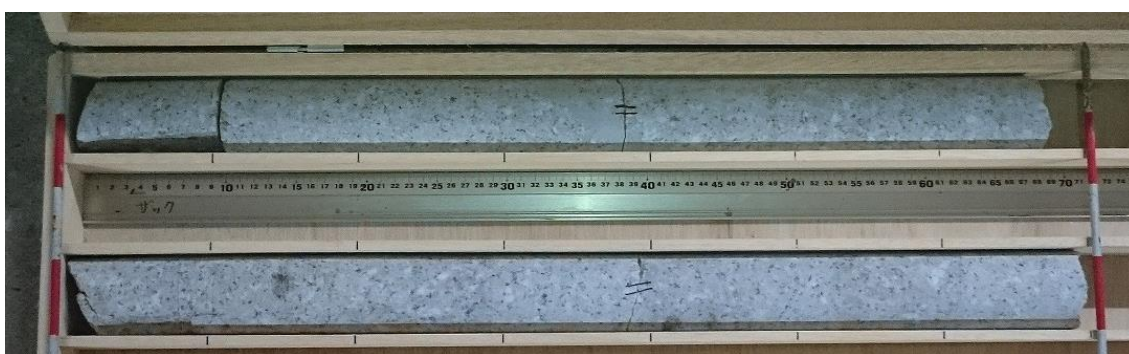
図23 ボーリング孔の掘削後に得られた岩石コアサンプル(直径60mm)
