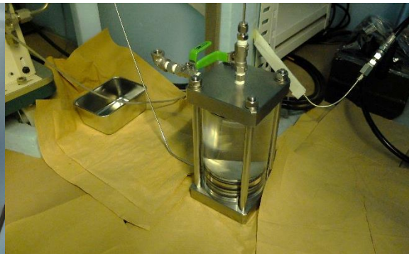
図 13 粘土懸濁水貯留タンク (粘土を攪拌した蒸留水を入れる容器)
