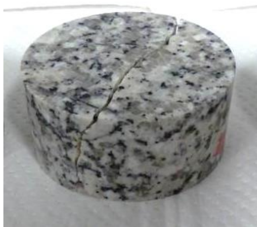
図1 巨視き裂を含む土岐花崗岩（直径50mm、厚さ25mm）
