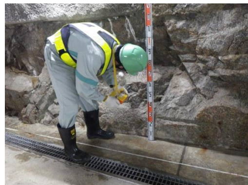
図 24 左)研究坑道概要図(濱ほか, 2014)とシュミットロックハンマーによる反発度測定箇所, 右)測定時の状況
