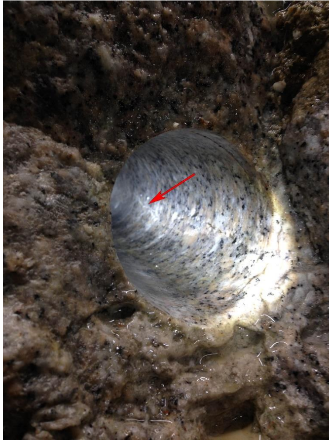
図 3 2 粘土を懸濁した水を用いた原位置透水試験後の孔内の様子. 赤矢印の部分において粘土が巨視き裂を充填している様子が示されている.
