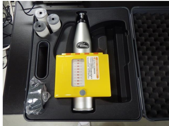
図 23 左)シュミットロックハンマーの構造図(地盤工学会, 2013), 右)測定に用いたシュミットロックハンマーの外観
