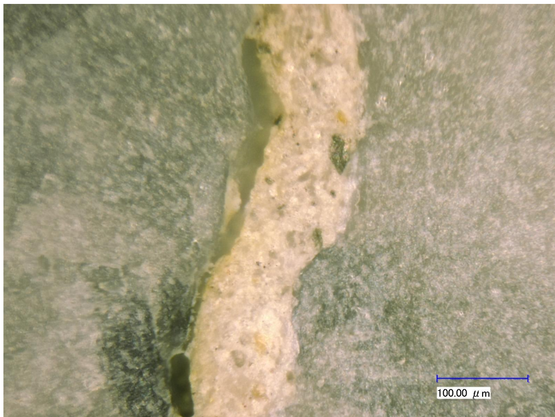
図17 花崗岩内の巨視き裂に集積した粘土
