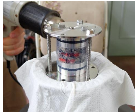
図 9 供試体を被覆している様子
