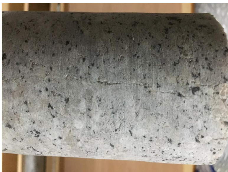
図24 岩石コアサンプルで認められた軸方向の巨視き裂(直径60mm)
