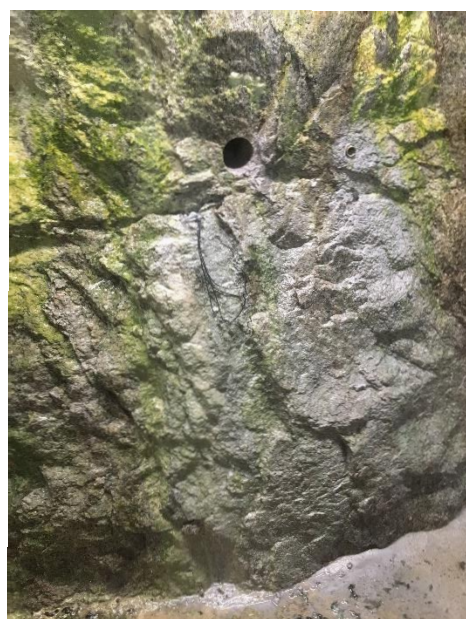
図22 掘削されたボーリング孔（試験前）
