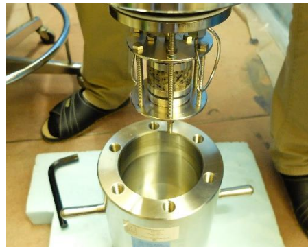
図 11 圧力容器に供試体を入れる様子
