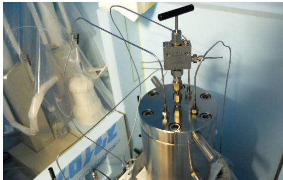
図 12 圧力容器に配管をつないだ写真
