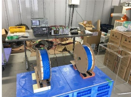
図 3.3.3-16 コイル間距離 500mm の給電試験状況 (伝送媒体なし)
