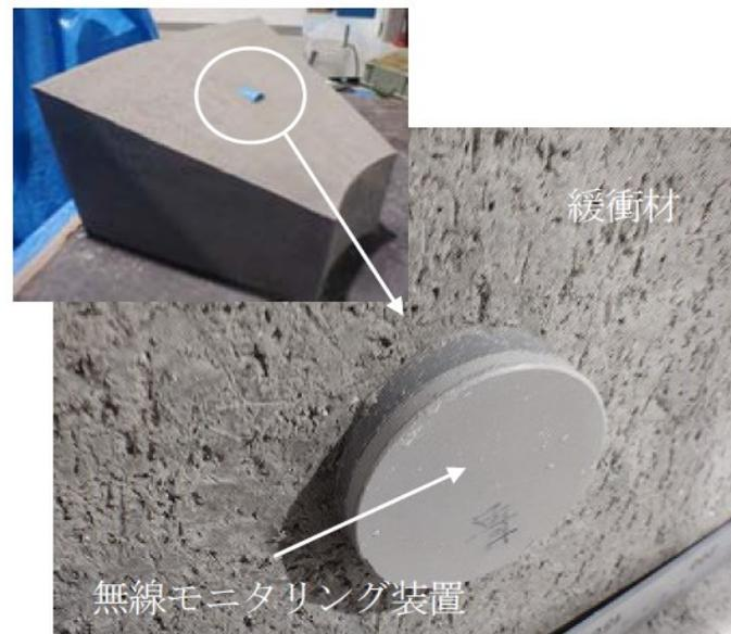
図 3.2.3-11 吹付工法による小型地中無線器の緩衝材への設置状況[24]
