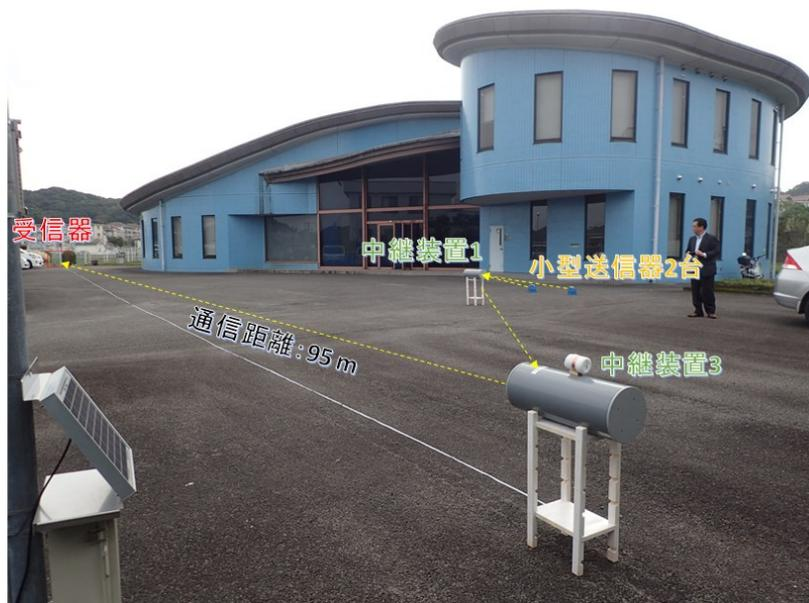
図 3.2.2-27 実距離通信試験状況（全体）
