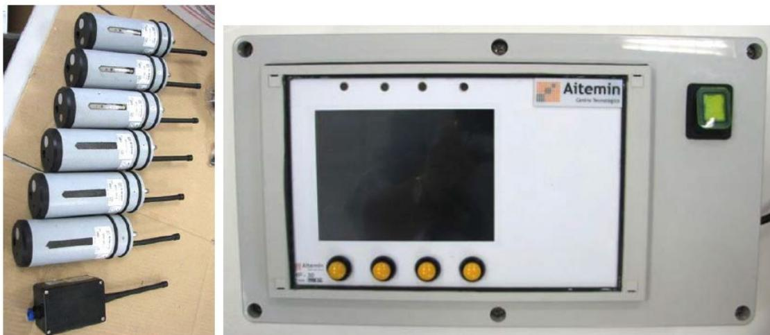
図 3.2.3-1 高周波無線通信システム (左：無線ノードと受信器、右：制御器) [5]
