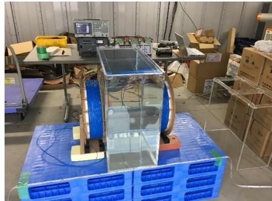
図 3.3.3-17 コイル間距離 300mm の給電試験状況 (左：水槽中身なし、右：水槽中身あり)
