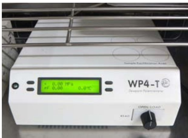
図 4.3.3-13 サイクロメータ及び恒温槽
