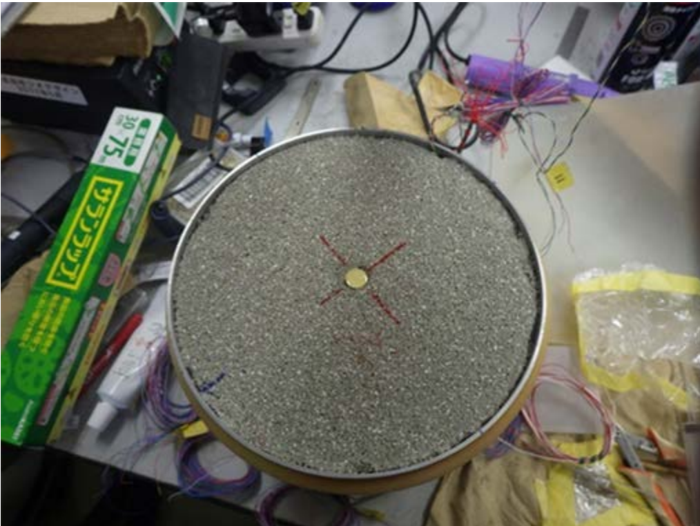
図 3.5.1-12 非接触変位計用ターゲット設置状況
