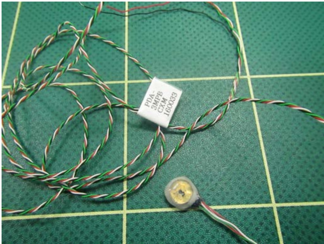
図 3.5.1-26 小型圧力計（東京測器製 PDA-3MPB）
