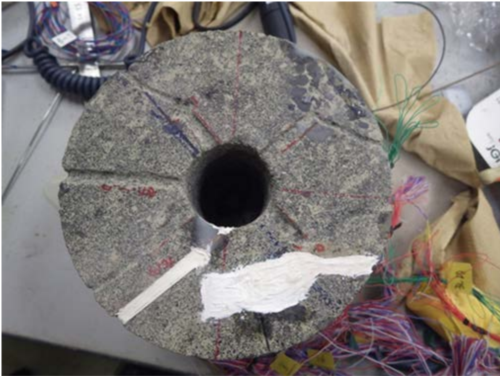
図 3.5.1-18 岩盤試料上端面の加工状況
