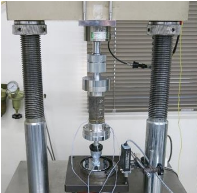
図 4.3.5-11 一軸引張り試験装置
