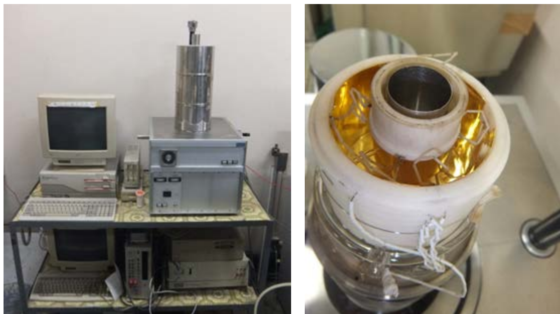
図 4.3.4-7 断熱走査型比熱測定装置
