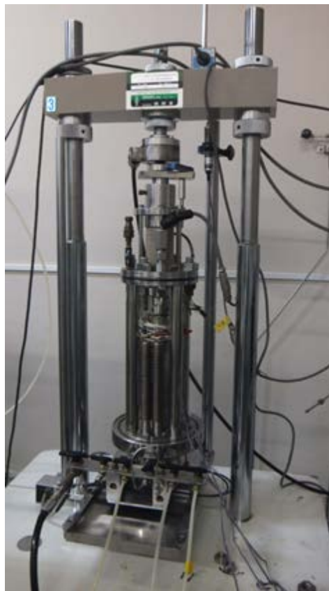
図 4.3.5-9 一軸圧縮試験装置
