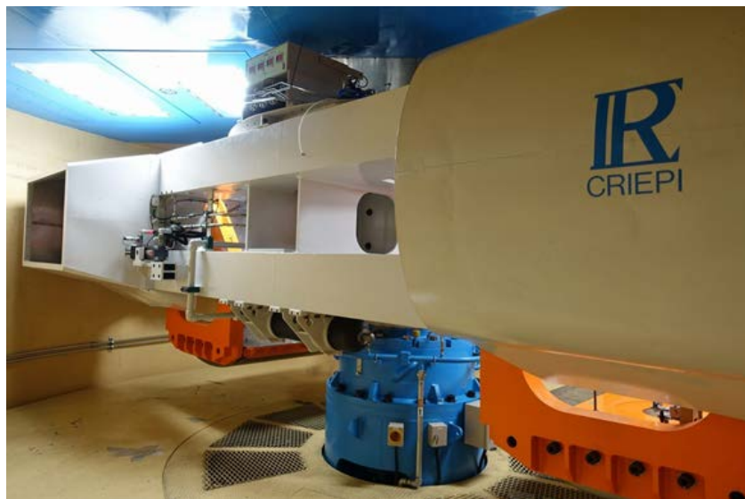
図 3.3.1-1 超長期遠心載荷岩盤実験装置の概略図(上)と装置全景(下)
