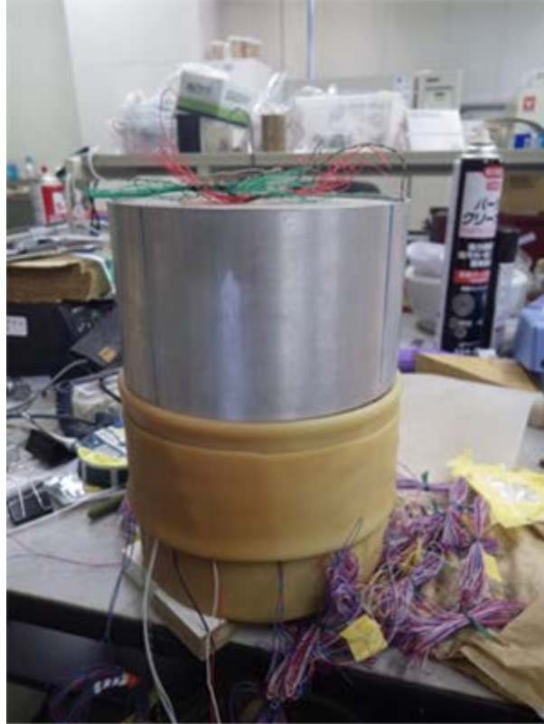
図 3.5.1-29 埋戻し材の設置状況
