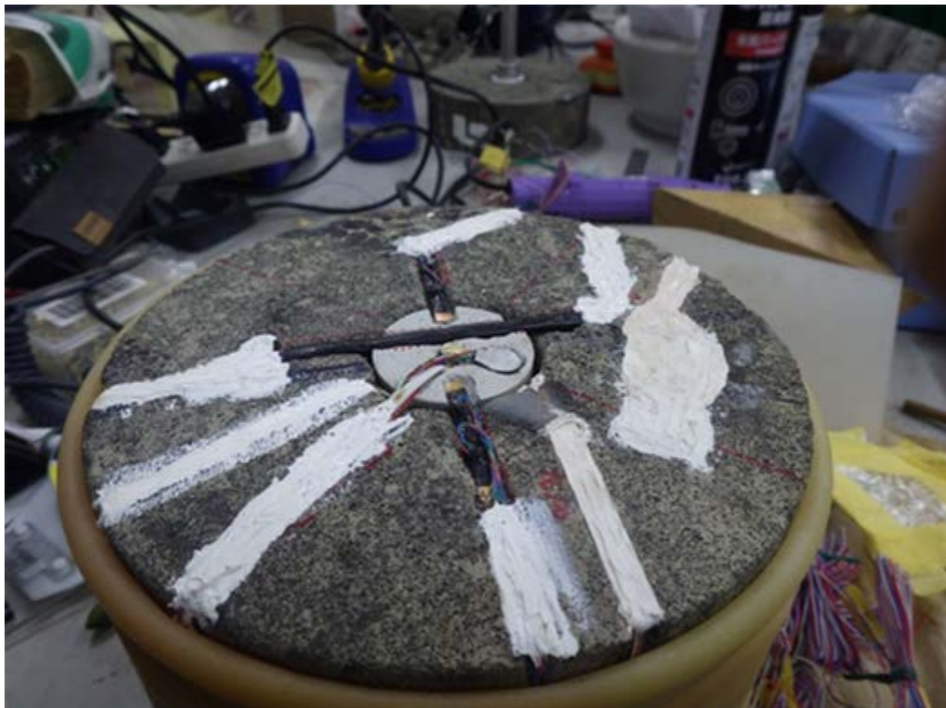
図 3.5.1-28 土圧計および膨出センサー設置状況
