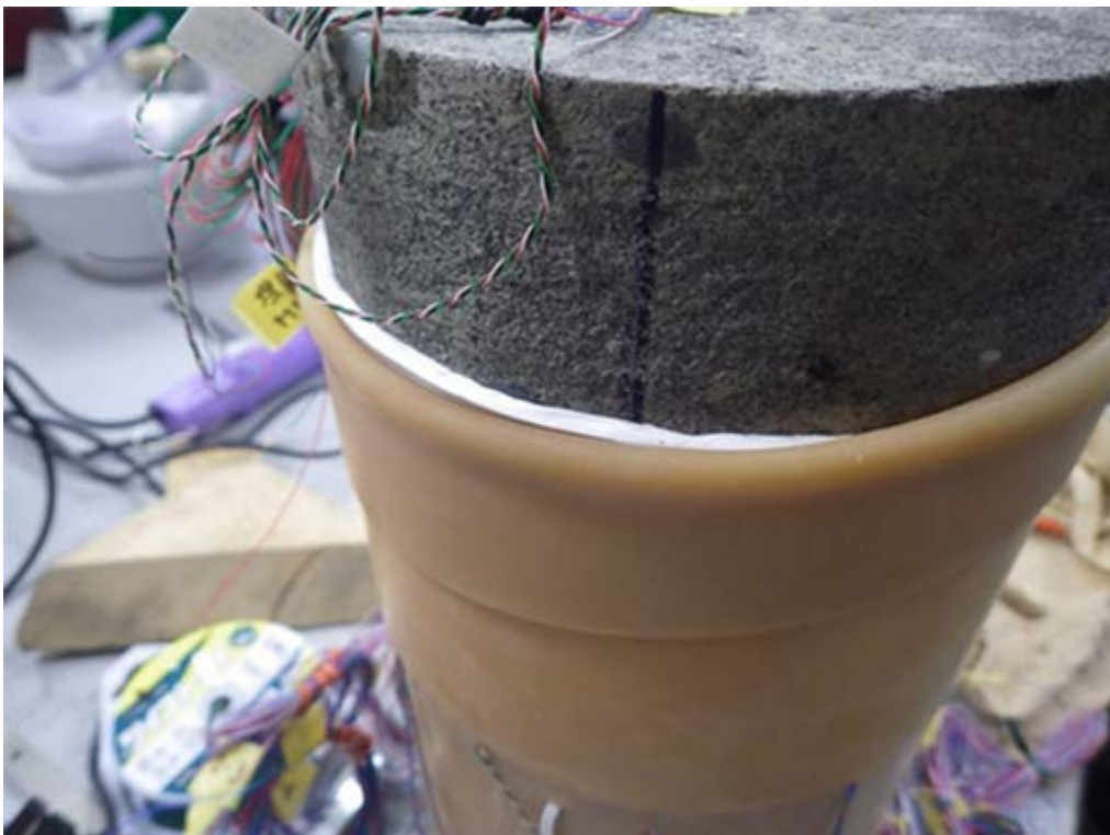
図 3.5.1-30 ガスケット材の設置状況
