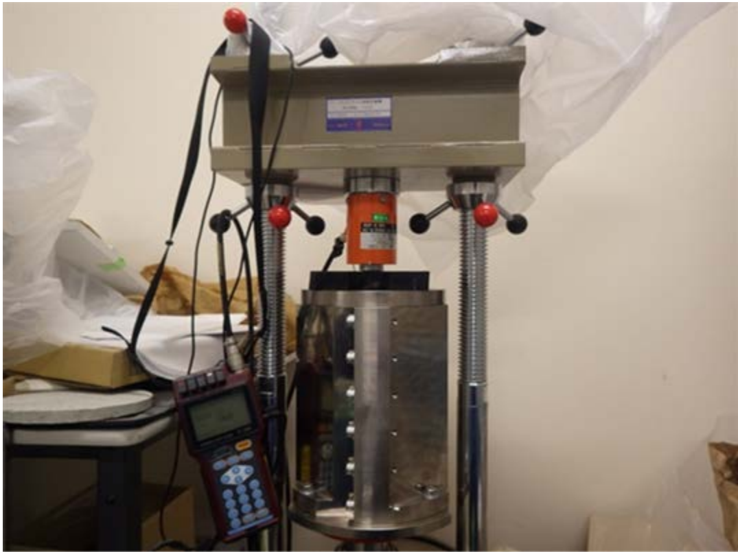
図 3.5.1-10 上部埋戻し材圧縮状況
