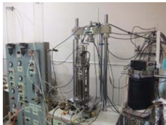
図 4.3.3-9 変水位透水特性の測定状況
