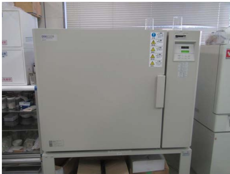
図 3.5.1-15 ADVANTEC DRK632DB 送風定温乾燥機
