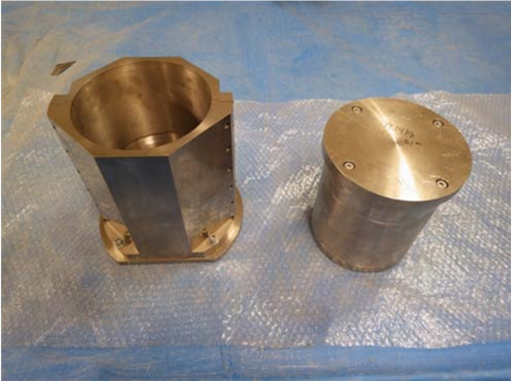
図 3.5.1-8 上部埋戻し材用圧縮容器
