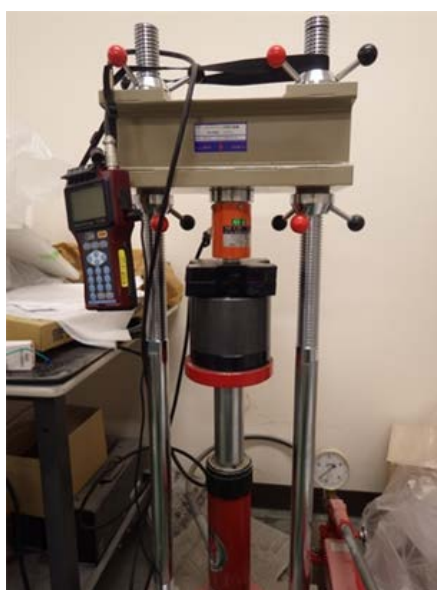
図 3.5.1-4 緩衝材および下部埋戻し材締固め機
