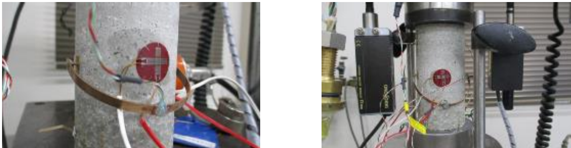
図 4.3.5-7 一軸圧縮試験時のひずみゲージ、横型 LDT の設置状況
