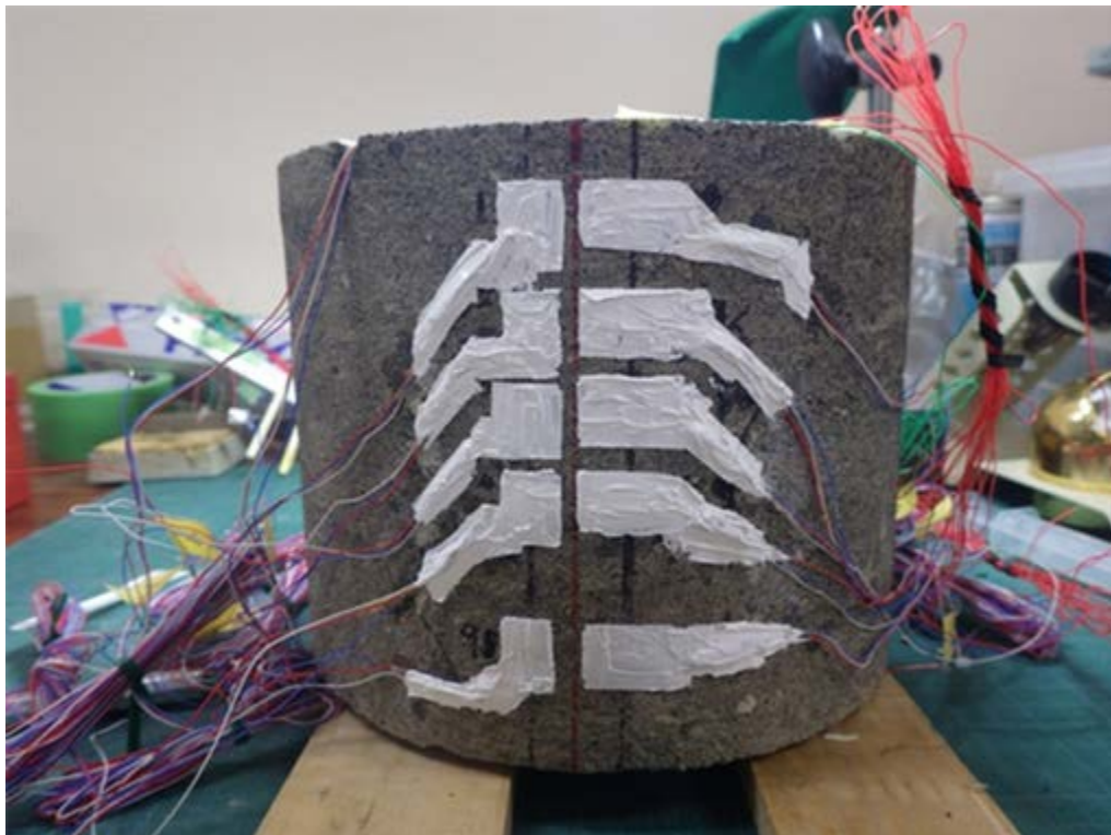
図 3.5.1-20 ひずみゲージ貼付部分へのコーティング状況
