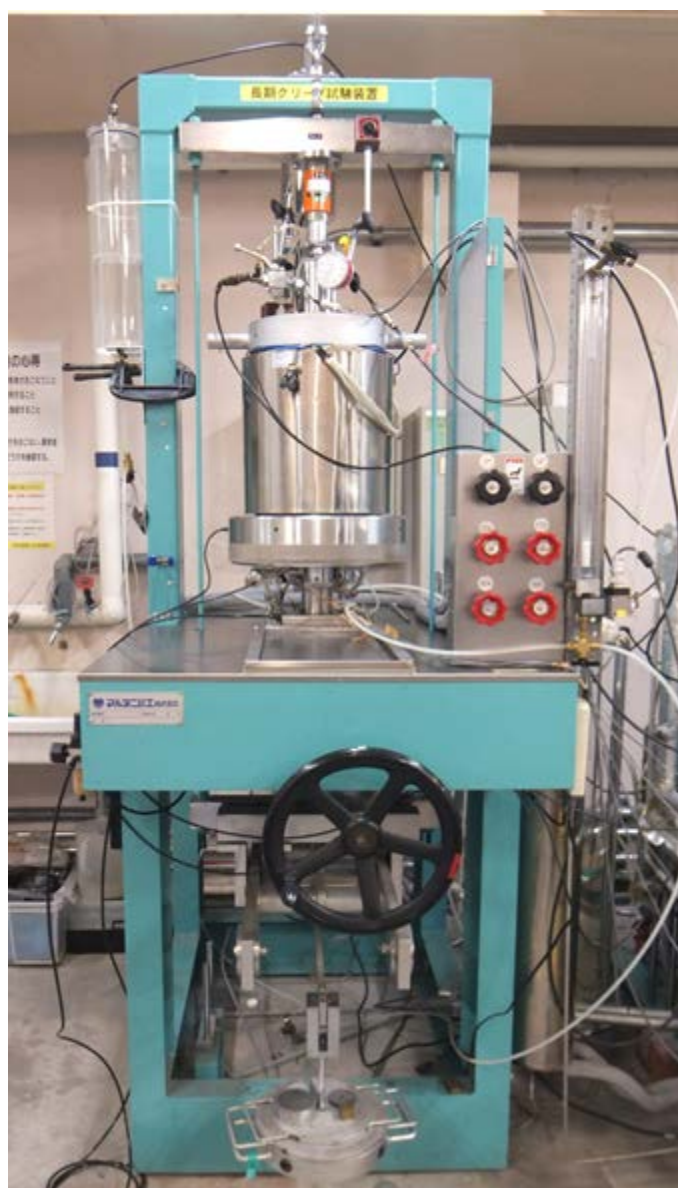
図 4.3.5-40 三軸クリープ試験装置
