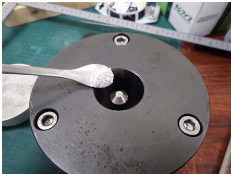
図 3.5.1-3 緩衝材・下部埋戻し材試料（クニゲル V1、70wt%、混合ケイ砂 30wt%）投入状況
