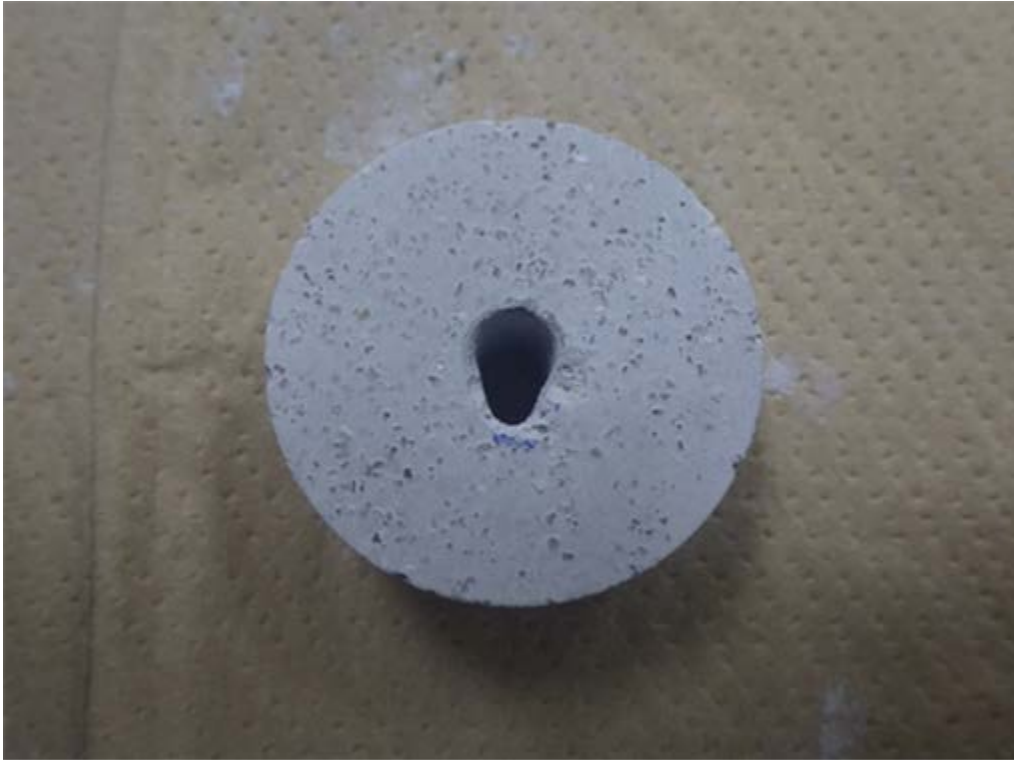
図 3.5.1-25 緩衝材ブロックの中心部加工状況
