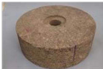
図 3.5.1-7 岩盤試料の整形状況
