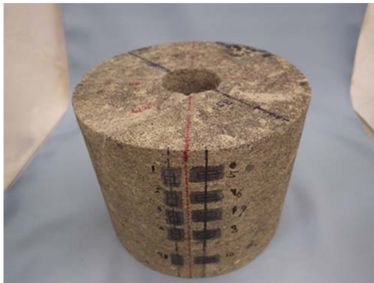
図 3.5.1-16 岩盤供試体へのマーキング状況
