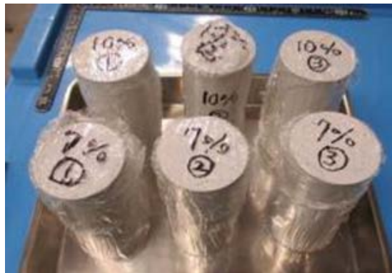
図 4.3.5-1 一軸圧縮試験の供試体（緩衝材）
