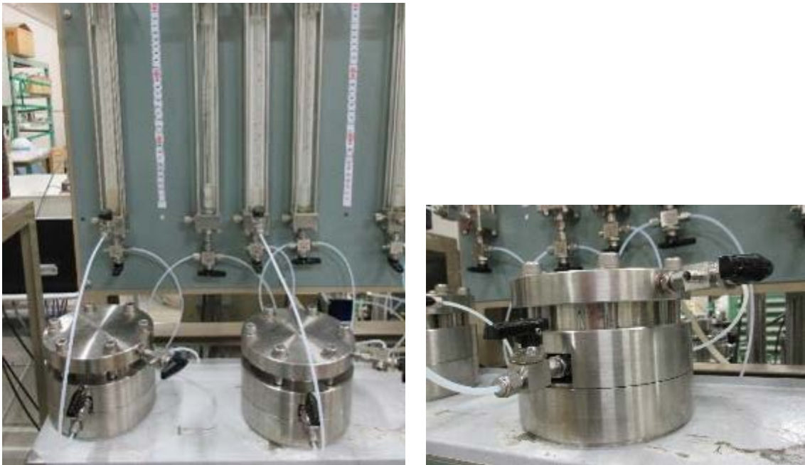
図 4.3.3-1 透水特性の測定状況（緩衝材、埋戻し材）
