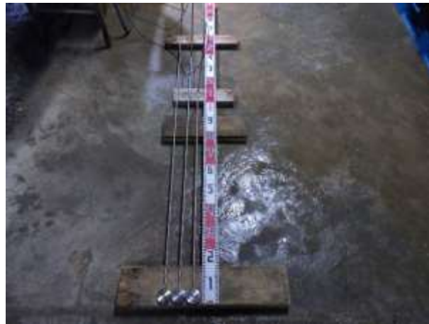
図 4.2.4-18 保護管に通した側部土圧計
