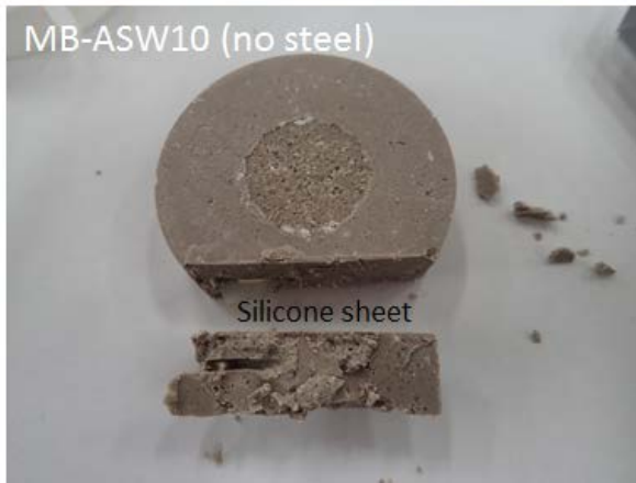
図 3.2.3-19 長期浸漬試験試料の回収時の様子
