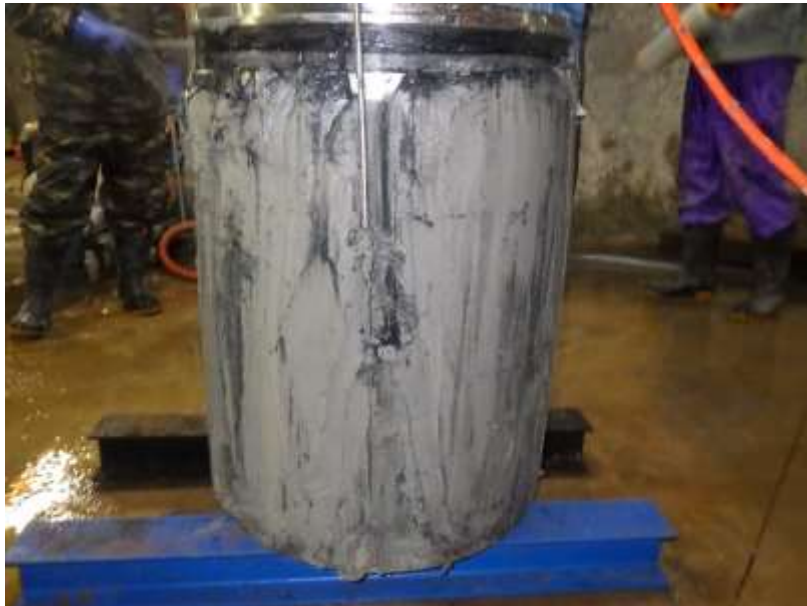
図 4.2.5-5 試験体回収時の緩衝材の外観（南面：側部土圧計設置側の面）
