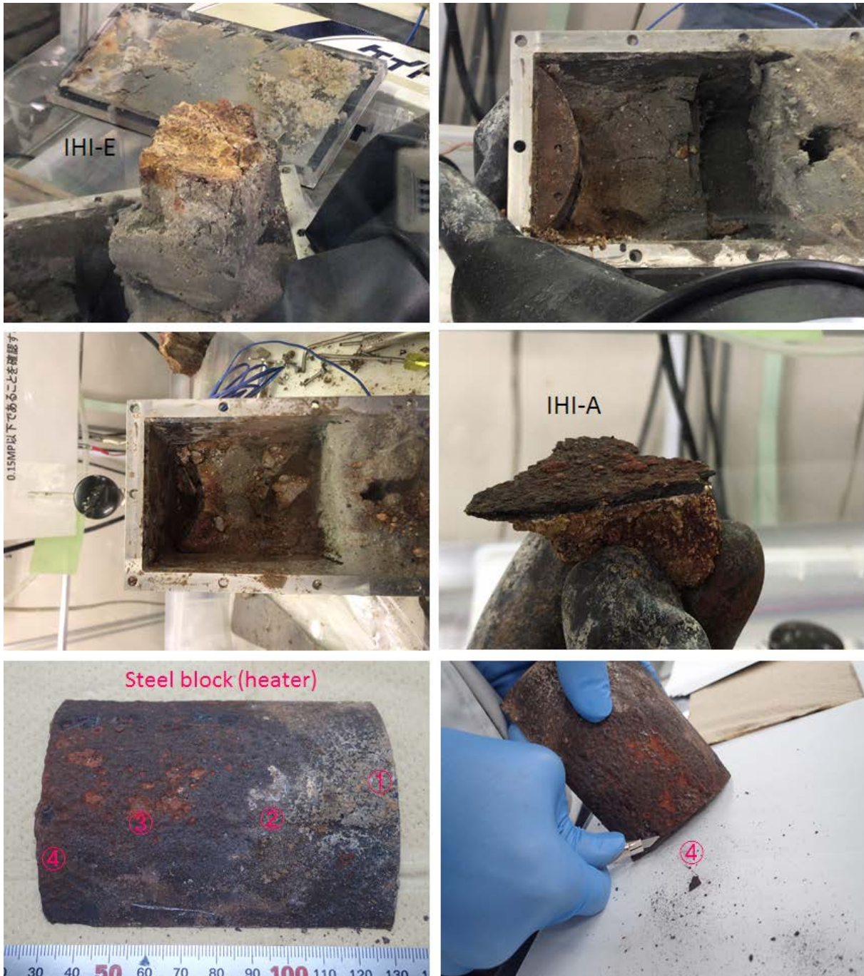
図 3.2.3-136 室内腐食試験試料の回収
