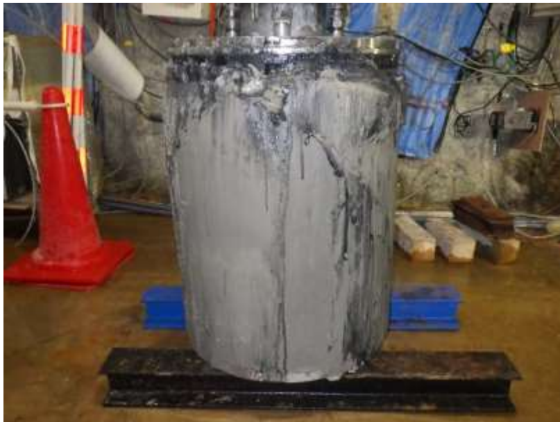
図 4.2.5-3 試験体回収時の緩衝材の外観（北面）
