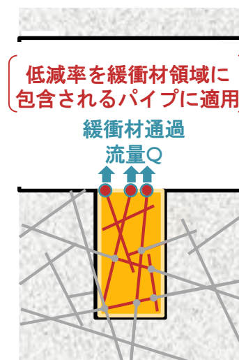
図 5.1.3-3 緩衝材定置のモデル化の概念図
