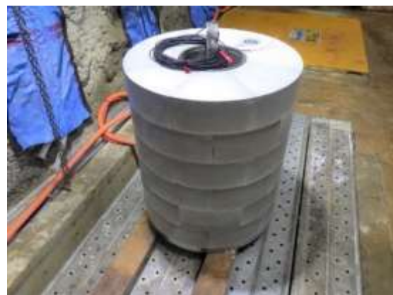
図 4.2.4-7 試験体の組立状況
