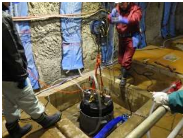
図 4.2.3-1 水理試験状況（止水プラグ設置状況）
