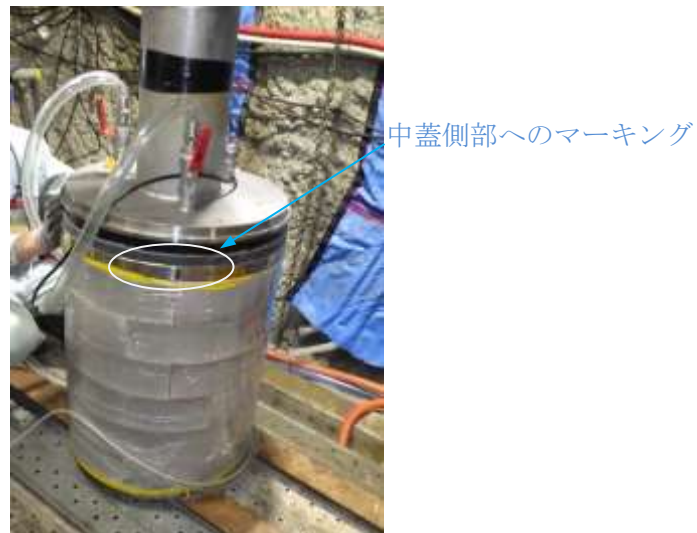
図 4.2.4-10 緩衝材ブロック間の中蓋側部へのマーキング状況
