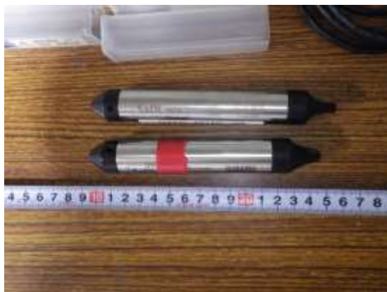
図 4.2.2-1 水位計 (S&DL mini およびバロメータ)
