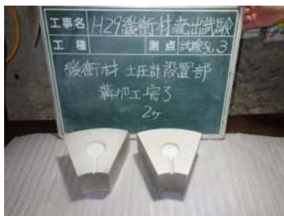
図 4.2.4-15 緩衝材ブロック溝加工状況
