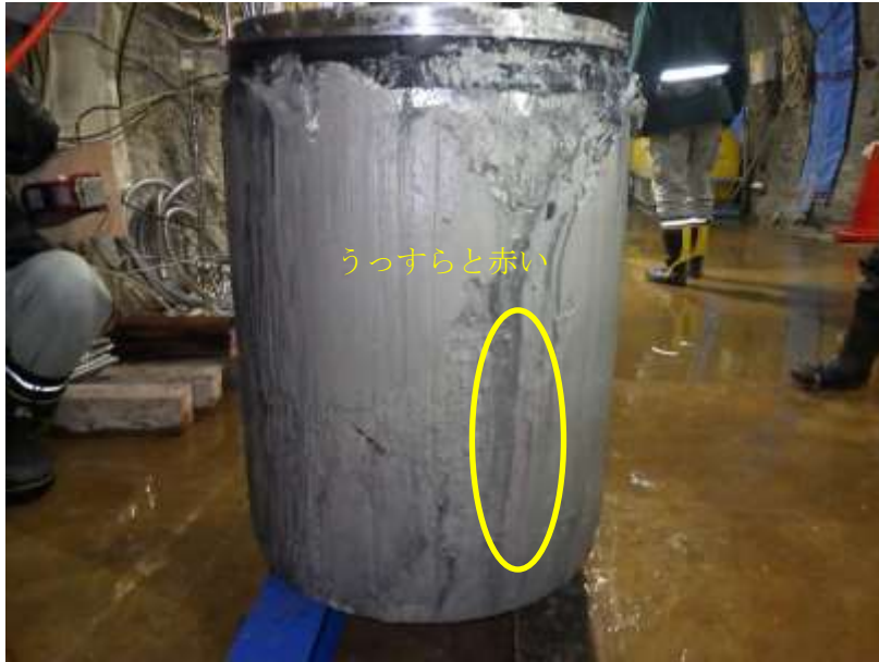
図 4.2.5-2 試験体回収時の緩衝材の外観（東面：注水孔側の面）
