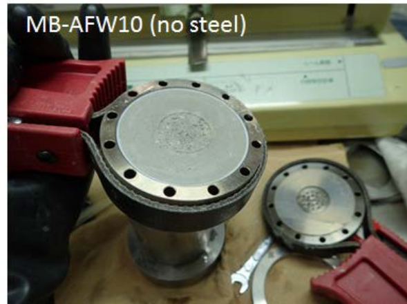
図 3.2.3-19 長期浸漬試験試料の回収時の様子
