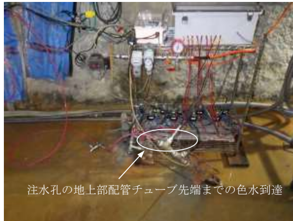
図 4.2.4-37 注水孔の地上部配管チューブ先端までの色水到達
