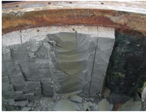
図 3.2.2-2 ブロックサンプリングによる変質部の採取
