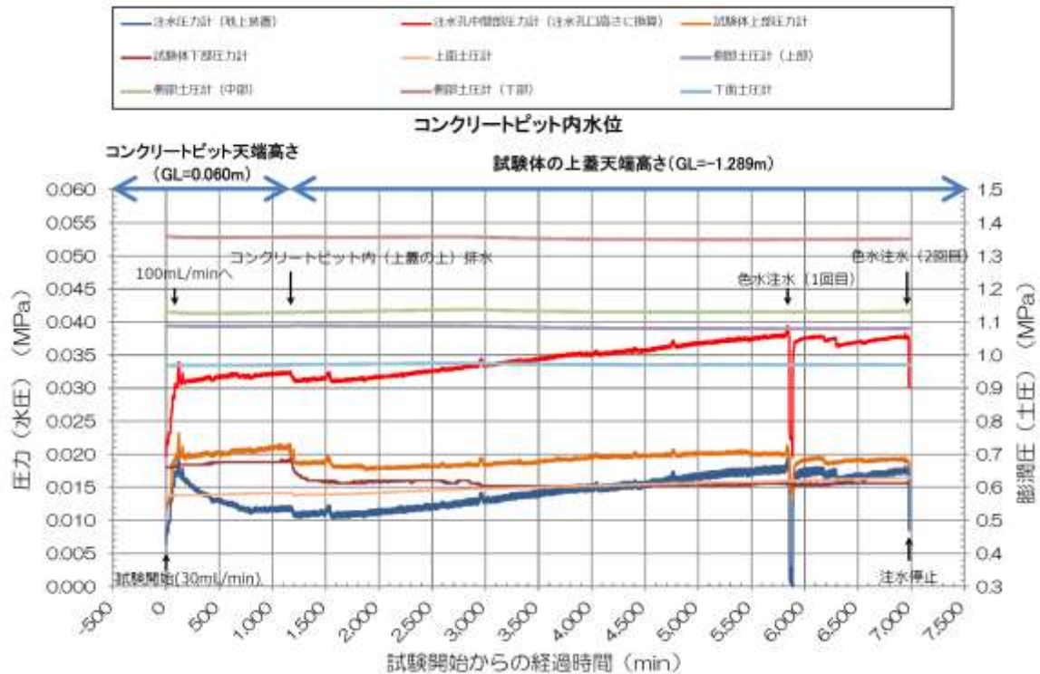
図 4.2.4-43 注水試験結果 (2回目、全体)・水圧と土圧
