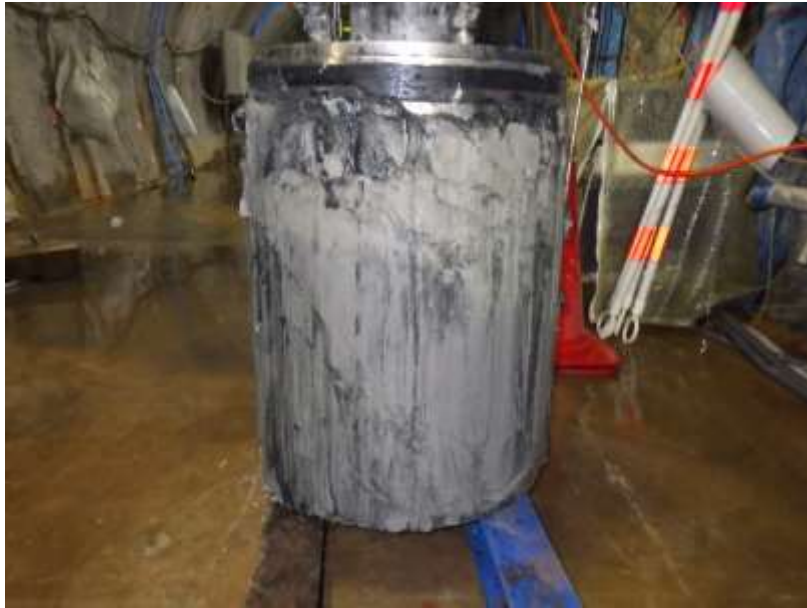
図 4.2.5-4 試験体回収時の緩衝材の外観（西面）
