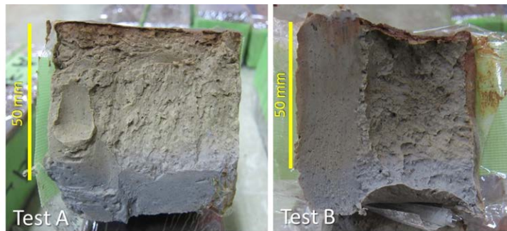
図 3.2.2-3 採取した鋼製モールドと接触した試料
