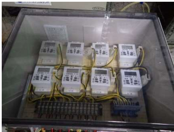
図 4.2.4-23 自動採水装置 タイマー
