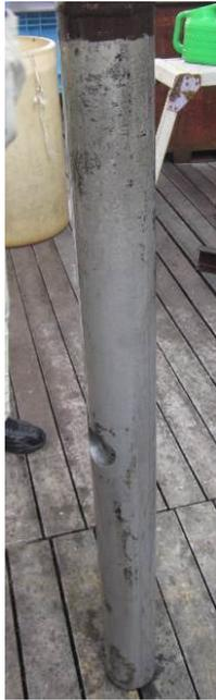
図 3.3.1-76 幌延 URL 工学規模試験 脱錆工程終了時の模擬オーバーパック（浸漬 5 分後）
