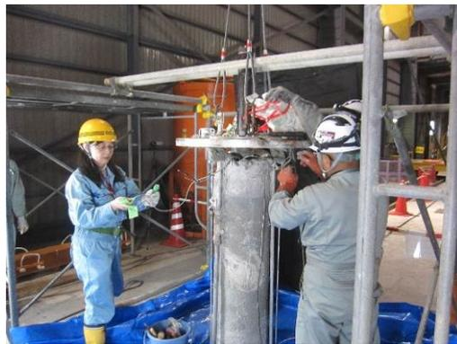
図 3.3.1-48 幌延 URL 工学規模試験 センサケーブル切断
