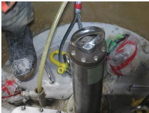
図 3.3.1-30 幌延 URL 工学規模試験 M12 アイボルト付模擬オーバーパック蓋取付け
