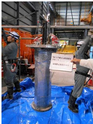
図 3.3.1-45 幌延 URL 工学規模試験 模擬オーバーパック転倒防止の取付け
