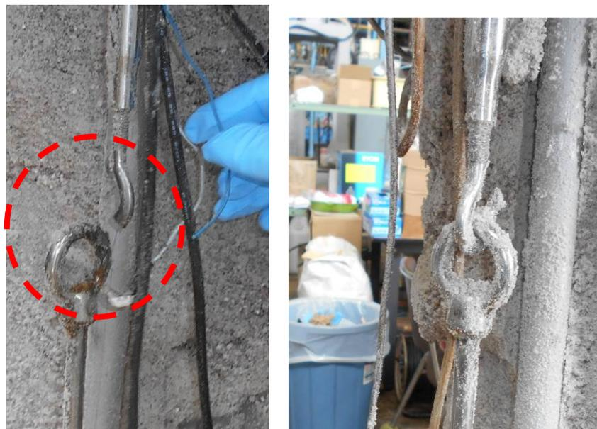
試験体の砂層を撤去した図 3.3.3-15 に砂層撤去後の試験体外観を示す。緩衝材ブロックは上段部ほど膨潤が大きく図 3.3.3-16 に示す様に上段部の膨潤が大きく、下へ向かうに従って膨潤が小さい結果となった。またに試験体下部緩衝材ブロック (No.1~No.4 付近) については小さくブロック間の境界および高さ方向にひびが確認できた。
