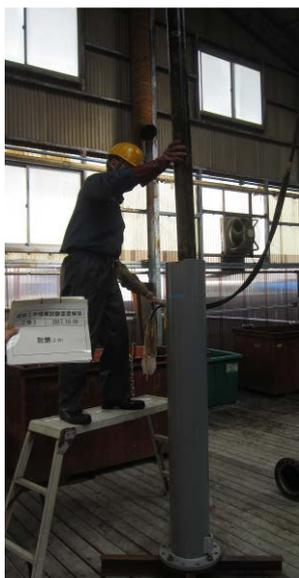
模擬オーバーパックの脱錆溶液への浸漬
