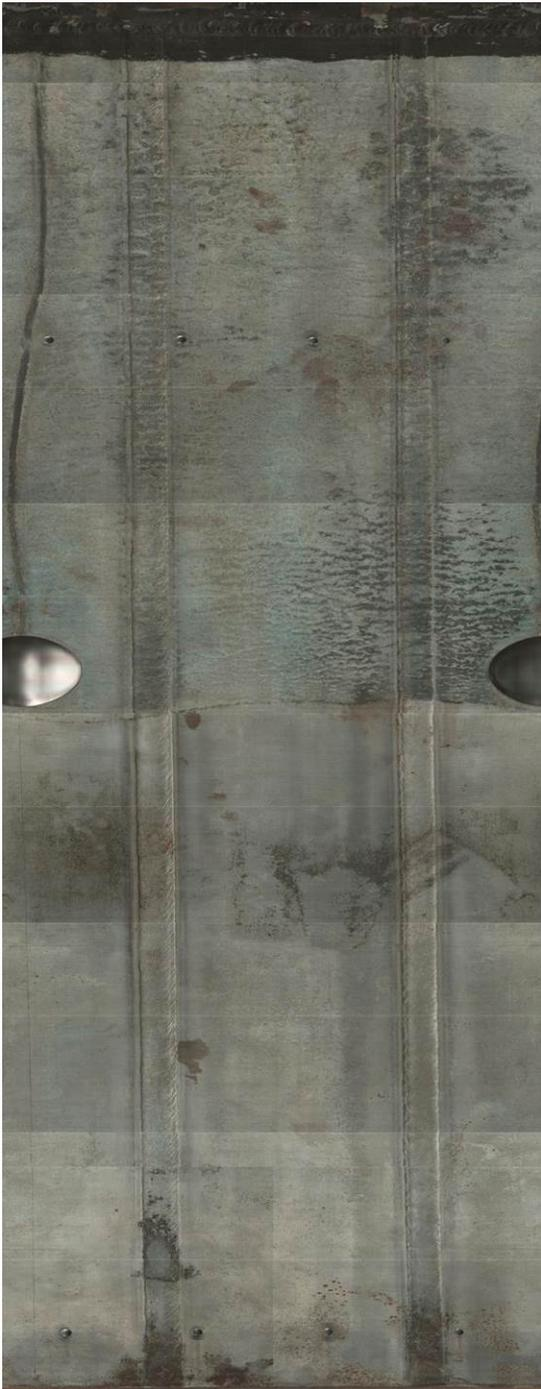
図 3.3.4-10 地上工学規模試験 酸洗後模擬オーバーパック試験体 腐食深さ分布と酸洗後表面
