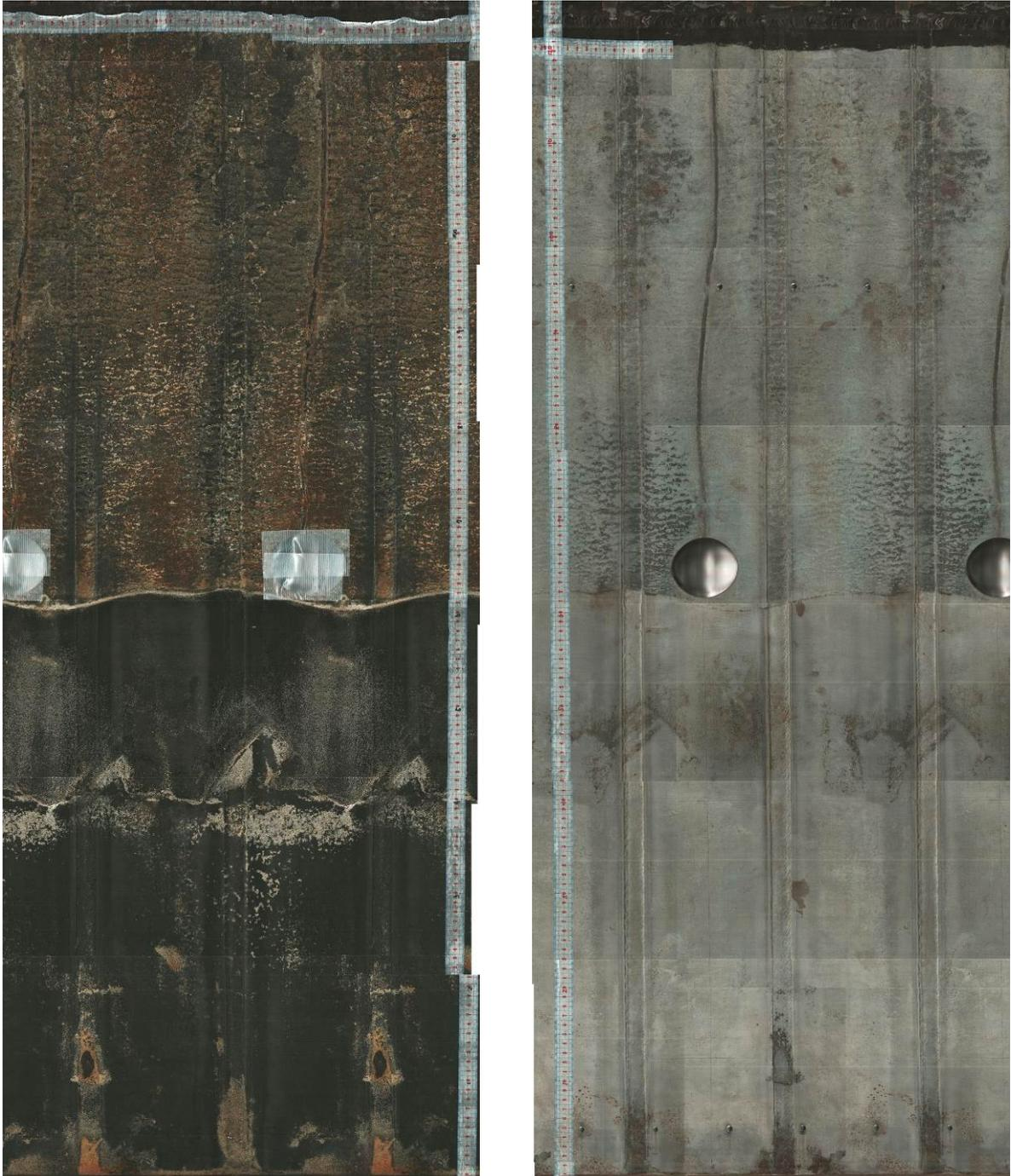
図 3.3.4-8 地上工学規模試験 模擬オーバーパック試験体 表面スキャン画像
