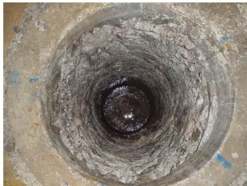
図 3.3.1-70 幌延 URL 工学規模試験 試験孔底部の珪砂・地下水の回収完了
