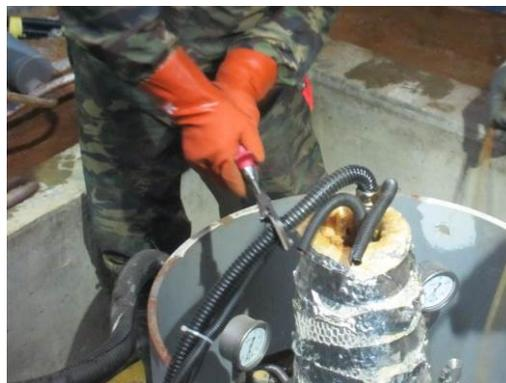
図 3.3.1-22 幌延 URL 工学規模試験 試験体側センサケーブル切断
