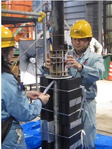
図 3.3.1-66 幌延 URL 工学規模試験 スキャナによる模擬オーバーパック表面撮影
