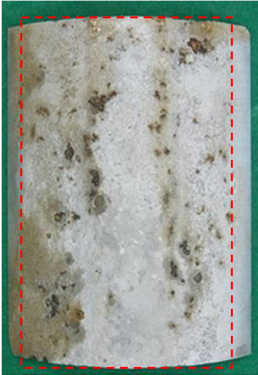
図 3.4.2-15 経時変化確認試験 試験後試験片の外観（試験開始後 18 ヶ月）
