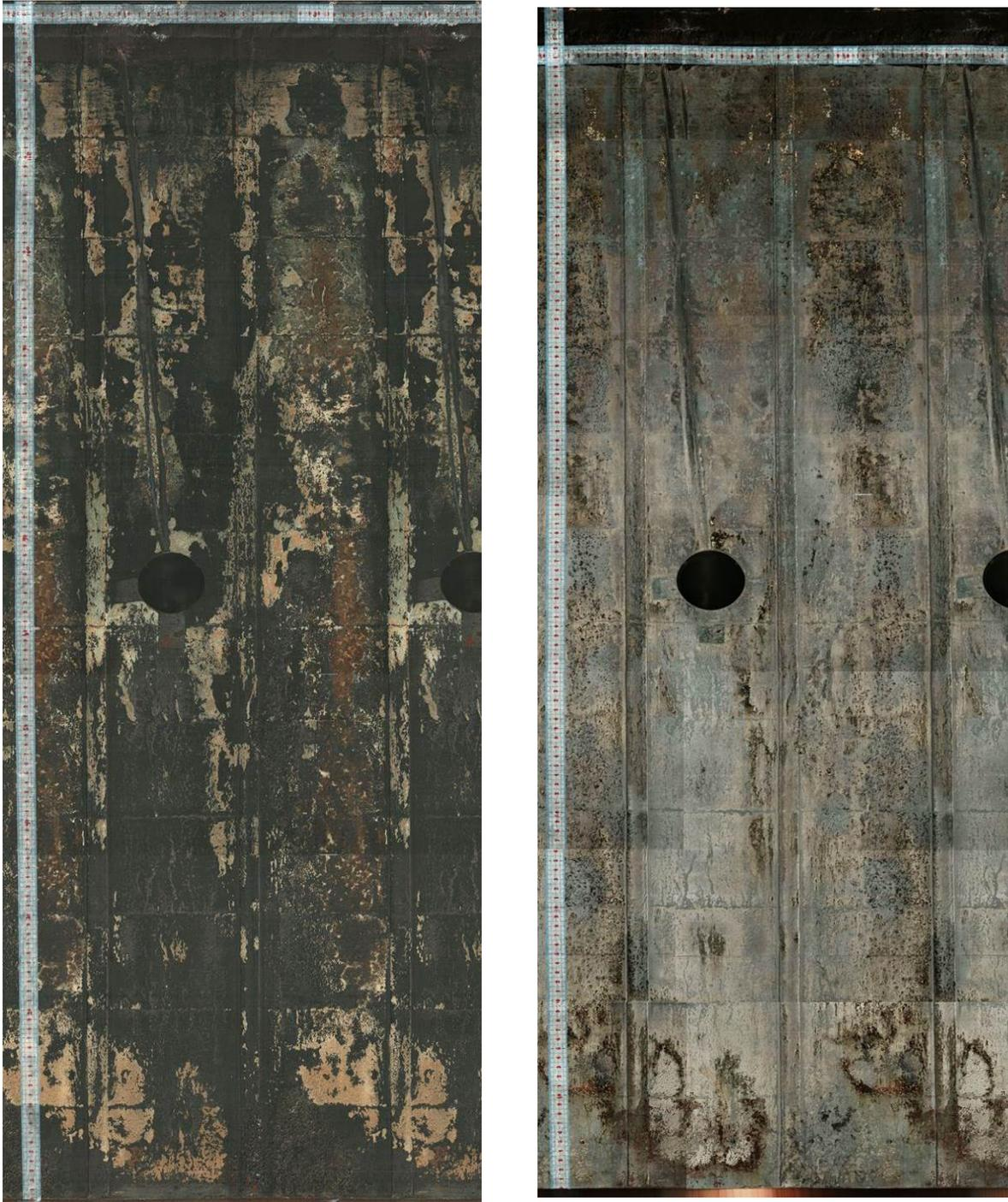
図 3.3.2-8 幌延 URL 工学規模試験 模擬オーバーパック試験体 表面スキャン画像
