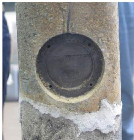
3電極センサー回収後 模擬オーバーパック
