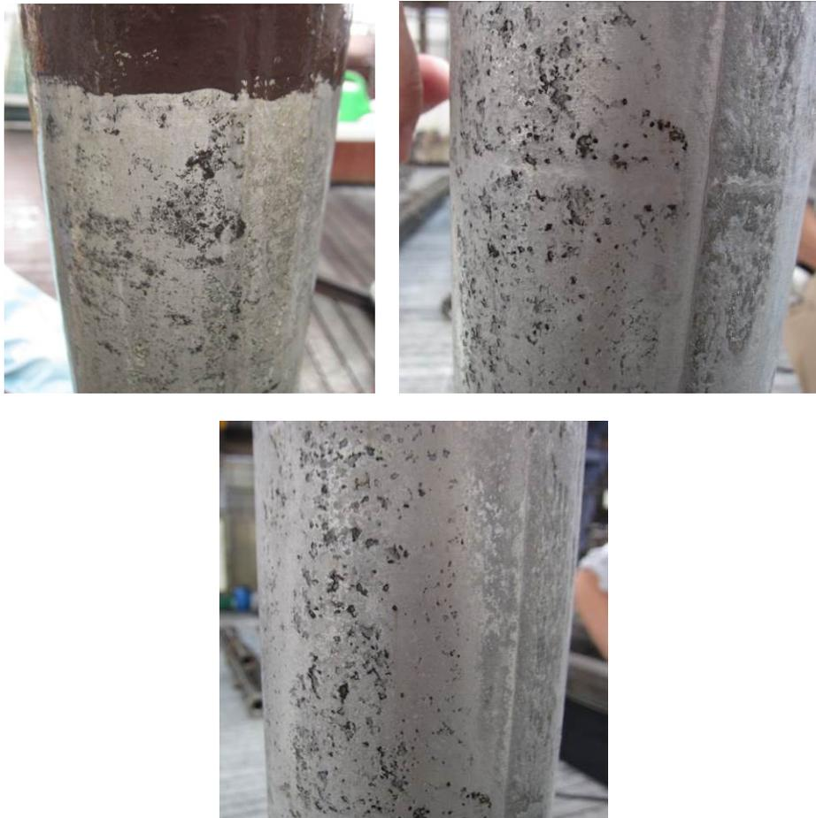
図 3.3.1-78 幌延 URL 工学規模試験 局在腐食箇所
