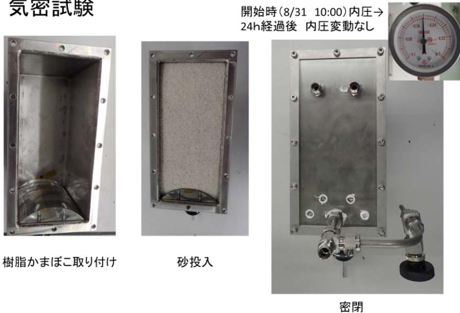
図 3.6.2-3 気密試験状況
