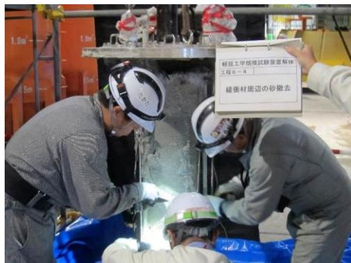
図 3.3.1-46 幌延 URL 工学規模試験 緩衝材ブロック周辺の砂撤去
