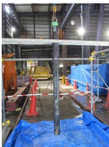
図 3.3.1-64 幌延 URL 工学規模試験 模擬オーバーパック現場洗浄完了
