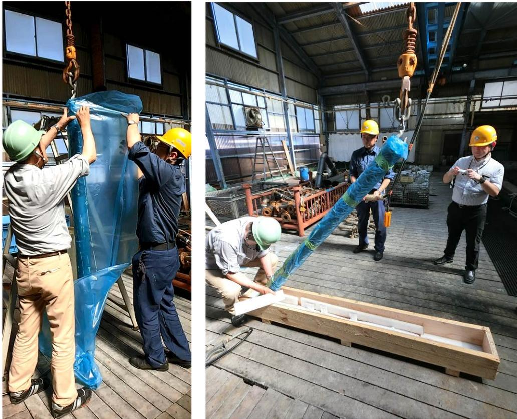
図 3.3.3-33 地上工学規模試験 酸洗後模擬オーバーパック木箱梱包作業
