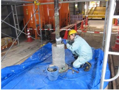
図 3.3.1-57 幌延 URL 工学規模試験 3 電極センサー回収
