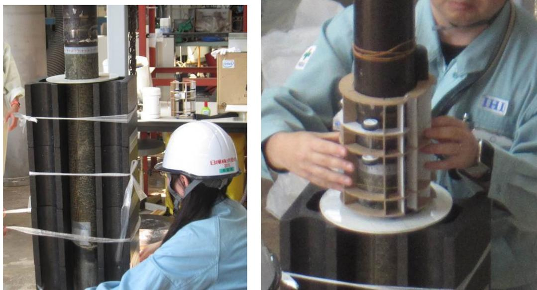
図 3.3.3-28 地上工学規模試験 模擬オーバーパックスキャン作業
