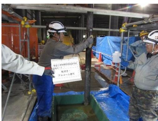
図 3.3.1-63 幌延 URL 工学規模試験 模擬オーバーパック乾拭き・アルコール塗布
