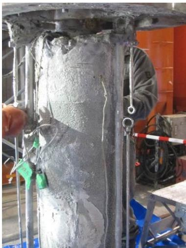
図 3.3.1-49 幌延 URL 工学規模試験 ターンバックル取外し
