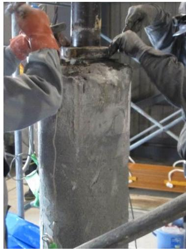
図 3.3.1-51 幌延 URL 工学規模試験 押さえリング取外し
