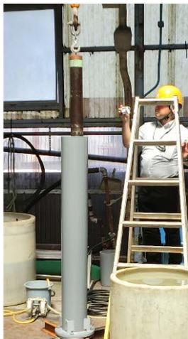
模擬オーバーパットの脱錆溶液への浸漬
