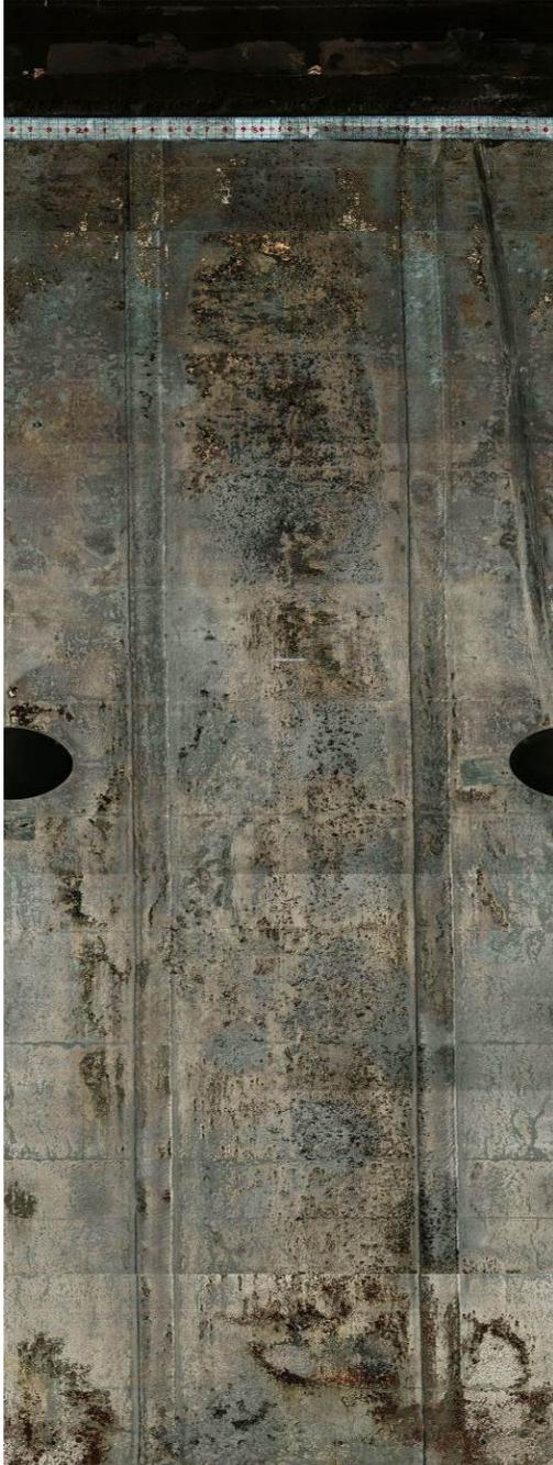
図 3.3.2-10 幌延 URL 工学規模試験 酸洗後模擬オーバーパック試験体 腐食深さ分布と酸洗後表面スキャン画像の比較
