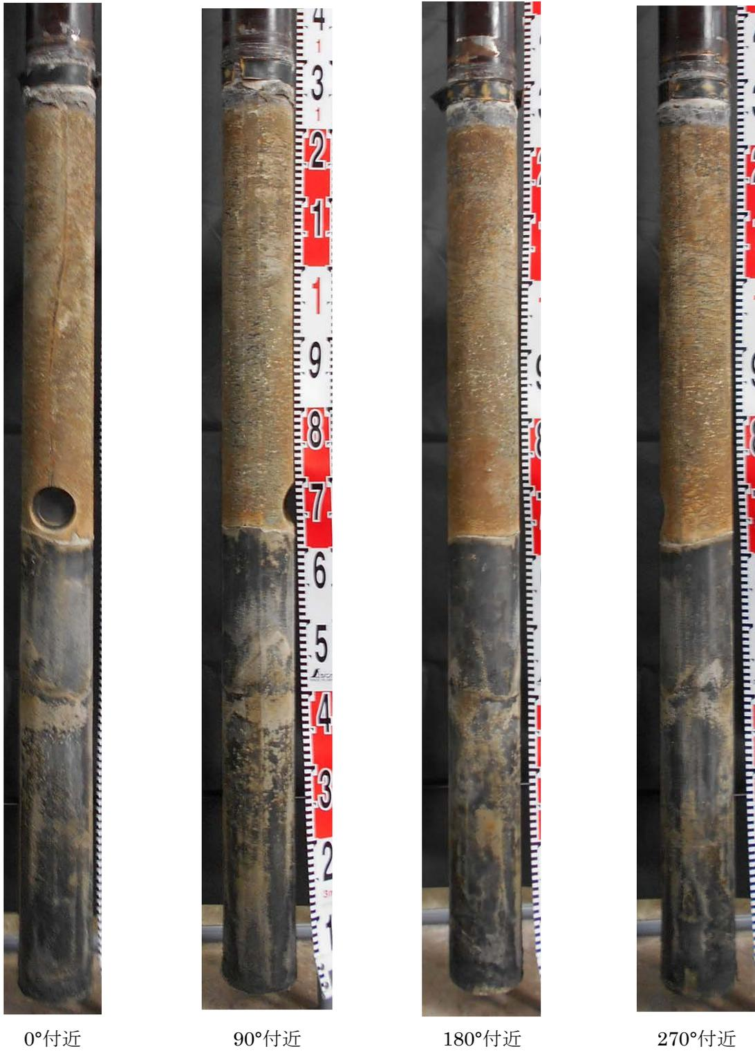
図 3.3.3-25 地上工学規模試験 緩衝材除去後の模擬オーバーパック外観
