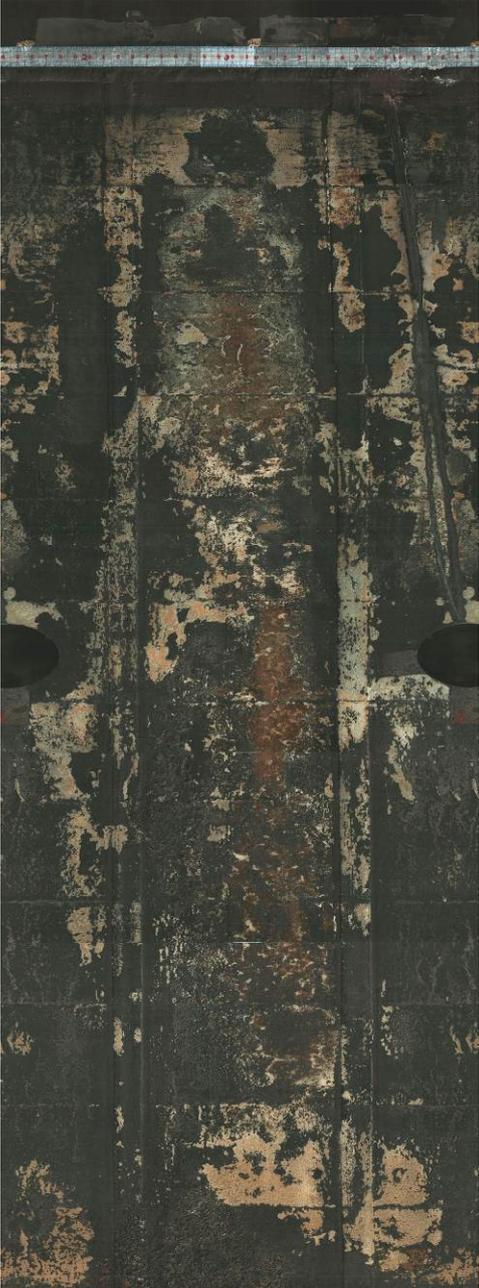
図 3.3.2-9 幌延 URL 工学規模試験 酸洗後模擬オーバーパック試験体 腐食深さ分布と酸洗前表面スキャン画像の比較
