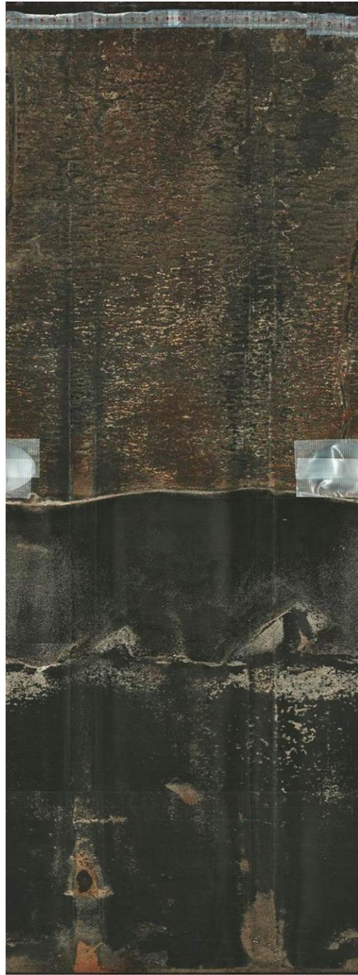
図 3.3.4-9 地上工学規模試験 酸洗後模擬オーバーパック試験体 腐食深さ分布と酸洗前表面スキャン画像の比較
