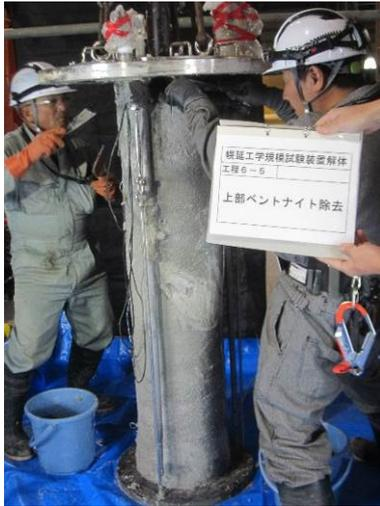
図 3.3.1-47 幌延 URL 工学規模試験 上部ベントナイト撤去
