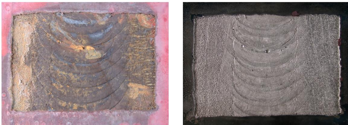
図 4.3.1-6 分極後の TIG 試験片の外観 (左：試験直後、右：脱スケール後)
