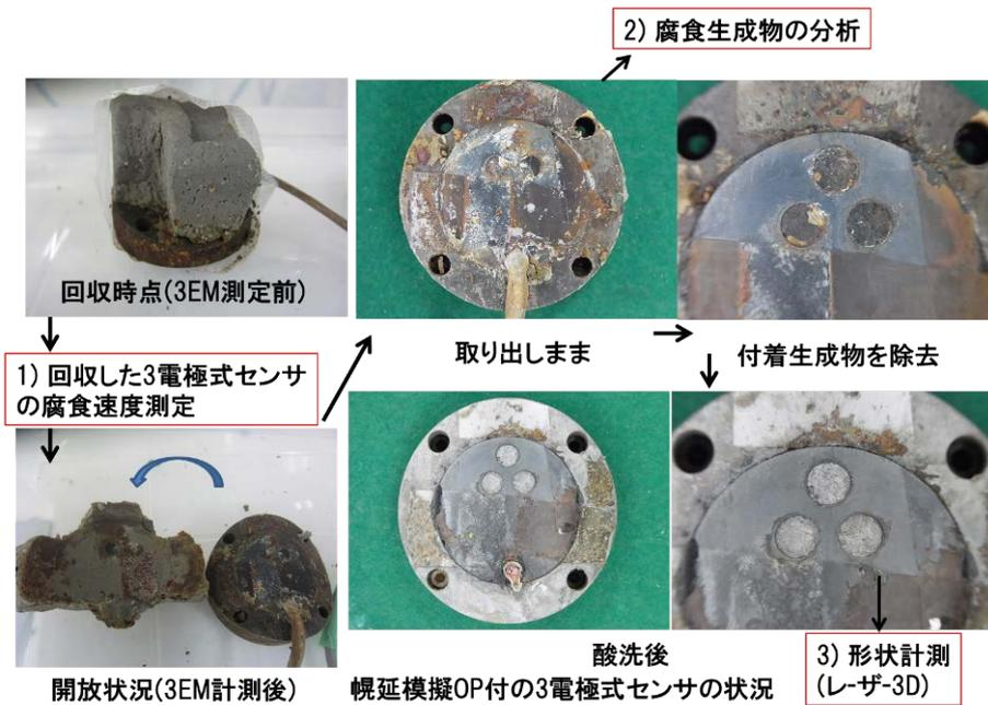
図 3.3.5-5 幌延 URL 工学規模試験 3 電極式センサーの評価手順
