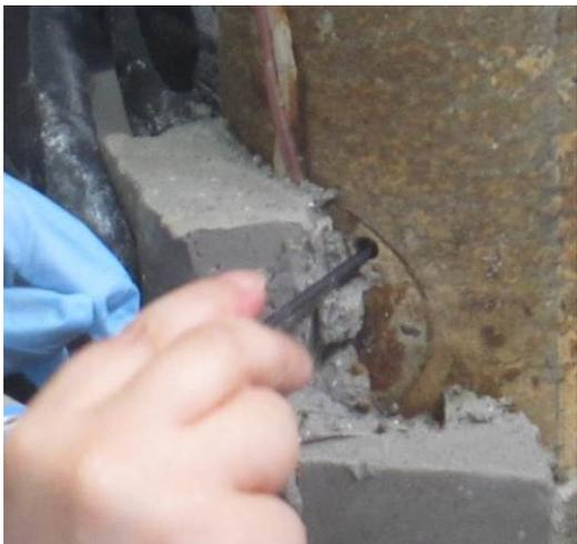
3電極センサー取外し作業
