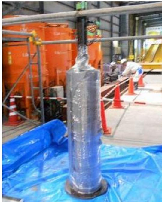
図 3.3.1-54 幌延 URL 工学規模試験 ラップ養生
