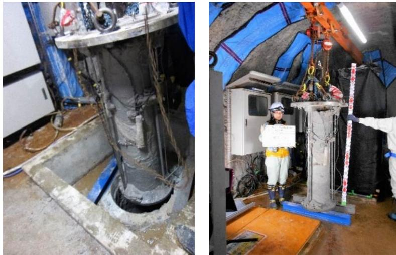
図 3.3.1-35 幌延 URL 工学規模試験 試験体の吊上げ
