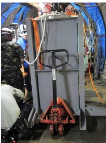
図 3.3.1-40 幌延 URL 工学規模試験 搬送容器をハンドパレットに搭載
