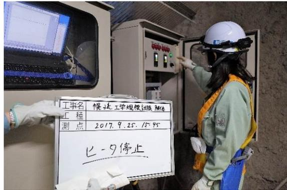
図 3.3.1-16 幌延 URL 工学規模試験 ヒータ停止状況
