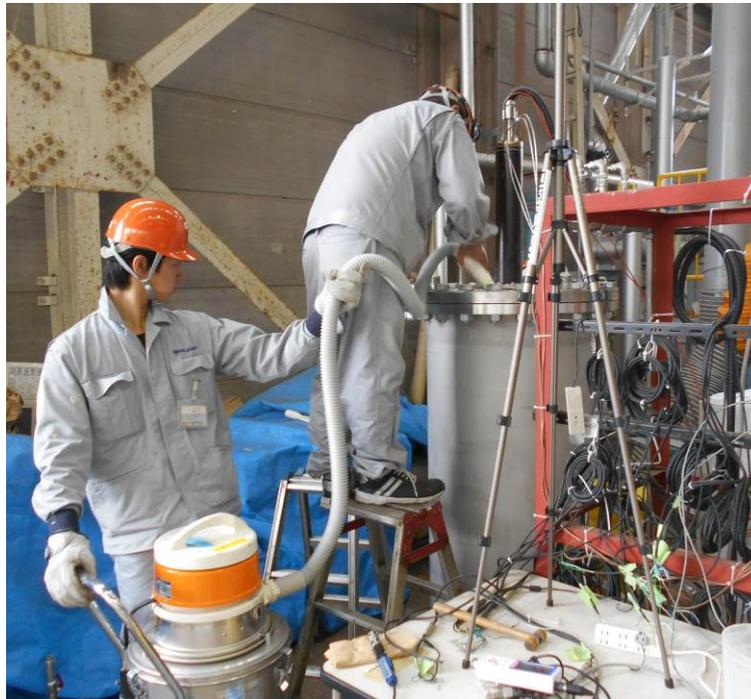
図 3.3.3-10 地上工学規模試験 砂層の回収
