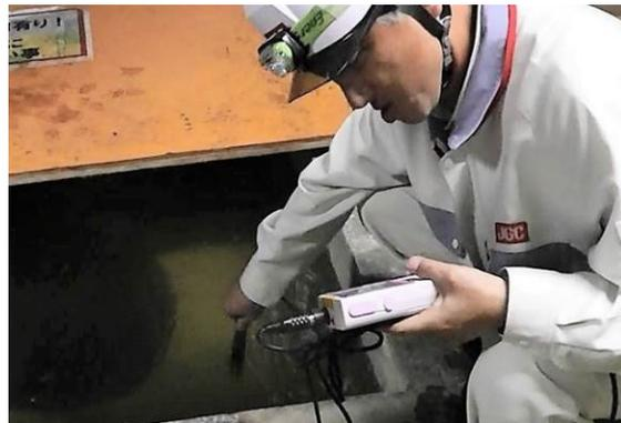
図 3.3.1-17 幌延 URL 工学規模試験 解体前環境測定状況（溶存酸素量測定）
