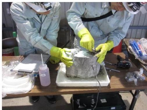
図 3.3.1-56 幌延 URL 工学規模試験 緩衝材のサンプリング（水分量測定用）
