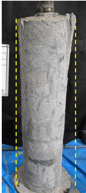
図 3.3.3-15 地上工学規模試験 砂層撤去後試験体外観 270°付近
