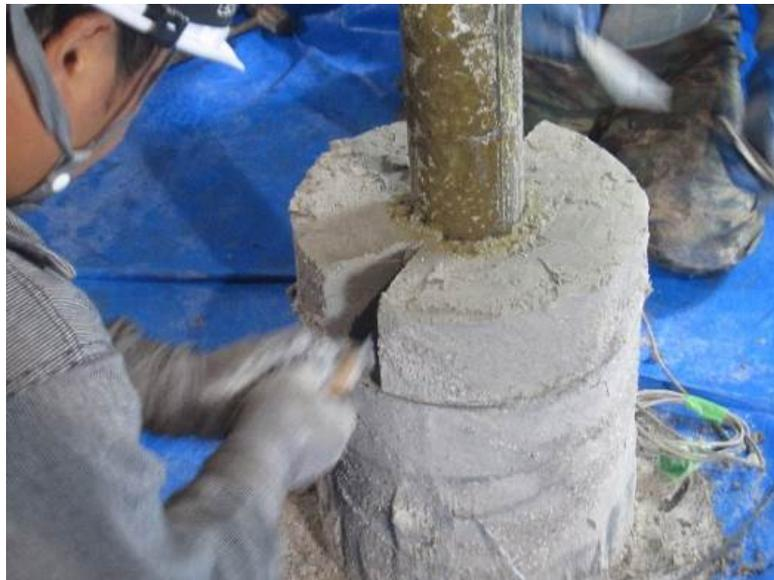
図 3.3.1-55 幌延 URL 工学規模試験 緩衝材の解体
