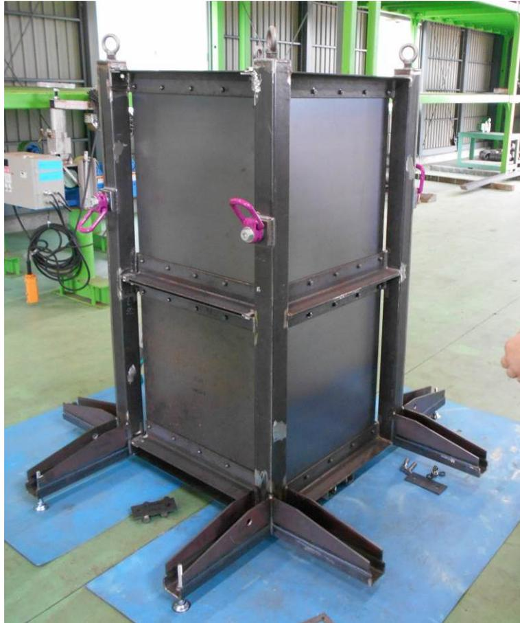
図 3.3.1-5 幌延 URL 工学規模試験 搬送容器外観
