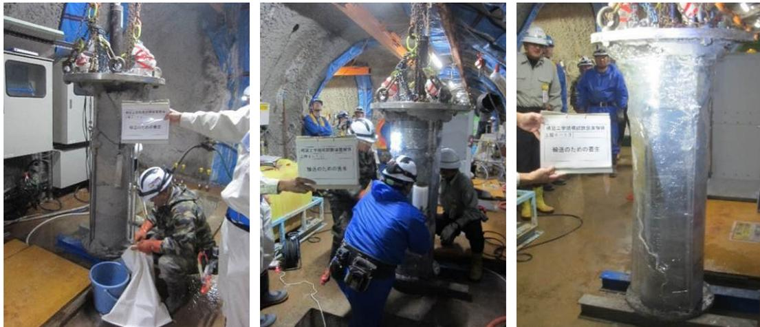
図 3.3.1-38 幌延 URL 工学規模試験 搬送のための試験体のラップ養生
