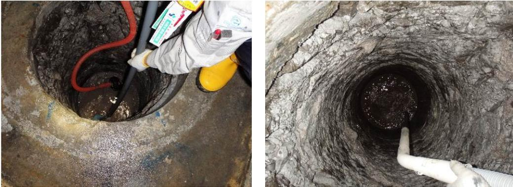
図 3.3.1-69 幌延 URL 工学規模試験 試験孔底部の珪砂・地下水の回収
