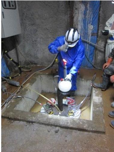
図 3.3.1-29 幌延 URL 工学規模試験 シリコンオイル抜き取り（手動ポンプ使用）
