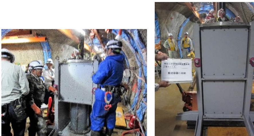
図 3.3.1-39 幌延 URL 工学規模試験 試験体を搬送容器に収納
