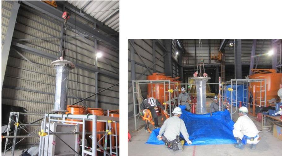
図 3.3.1-44 幌延 URL 工学規模試験 搬送容器から試験体の取出し
