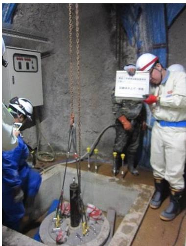
図 3.3.1-32 幌延 URL 工学規模試験 試験体吊上げ、スペーサセット
