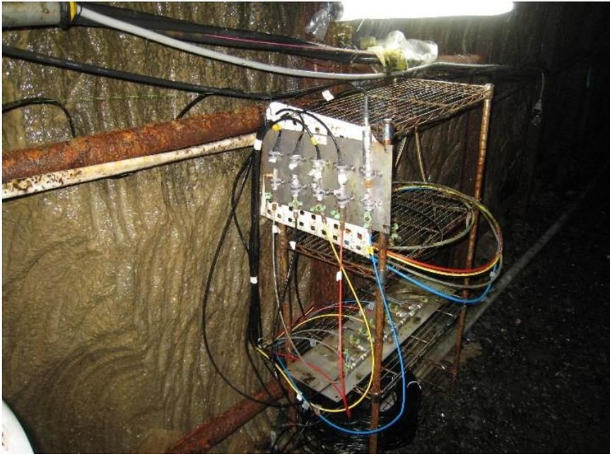
図 1.3-1 間隙水圧計点検（計測坑 A）
