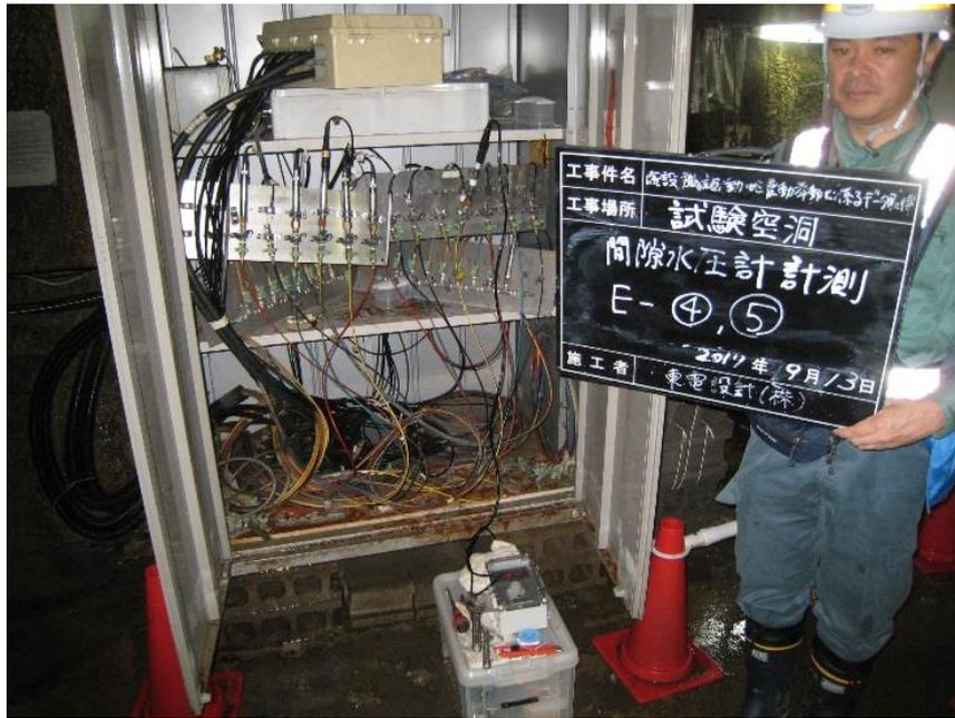
図 1.2-5 間隙水圧計計測 (試験空洞 E)
