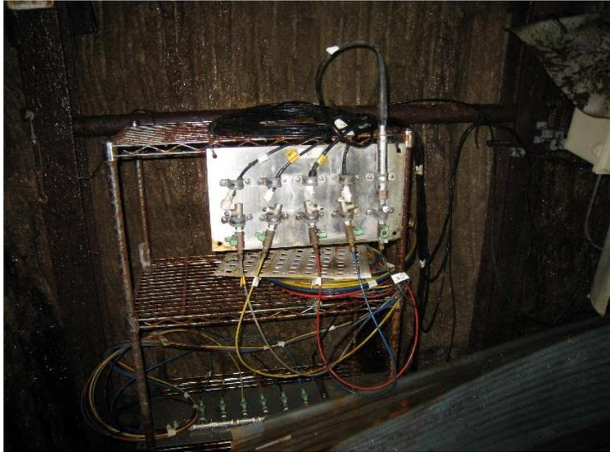
図 1.3-3 間隙水圧計点検 (計測坑 C)
