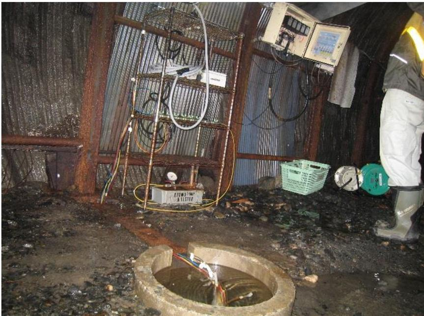
図 1.3-2 間隙水圧計点検（計測坑 B）
