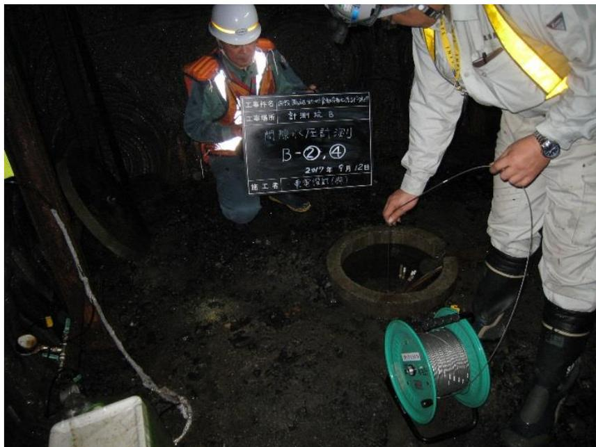
図 1.2-2 間隙水圧計計測（計測坑 B）
