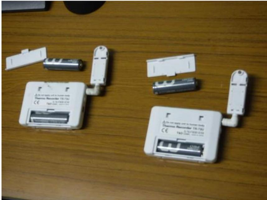
図 1.4-5 分散型温湿度計点検 (1/2)
