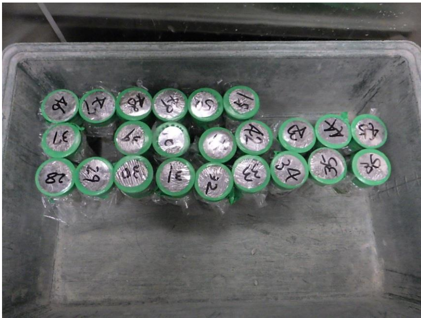
図 3.1-6 供試体養生状況
