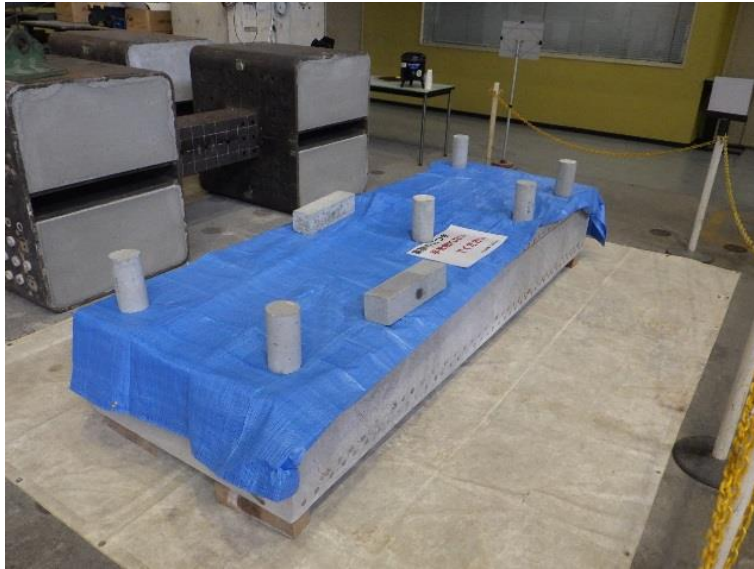
図 2.5-19 孔口の養生状況
