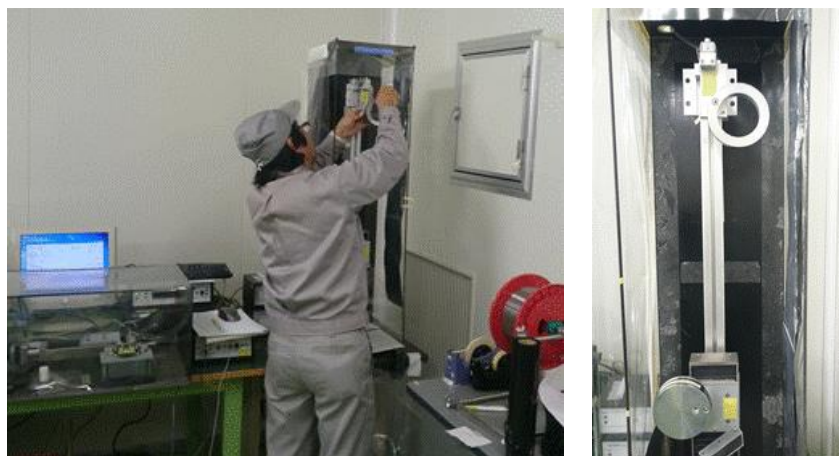
図 3.4-9 試験状況と引張試験機
