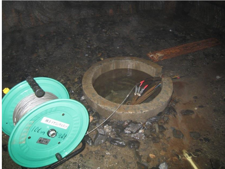
図 4.1-3 手ばかり水位計による水位測定状況
