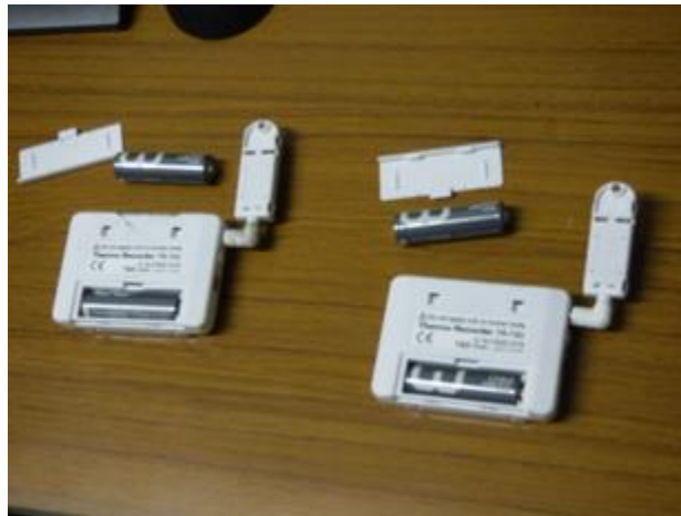
図 4.1-79 分散型温湿度計の点検
