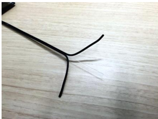
写真 3.5-2 ひずみ計測用光ファイバセンサー
