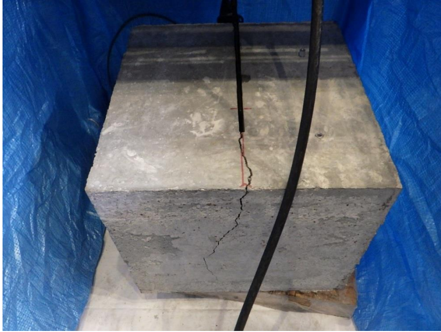
図 2.5-62 ひび割れの発生状況
