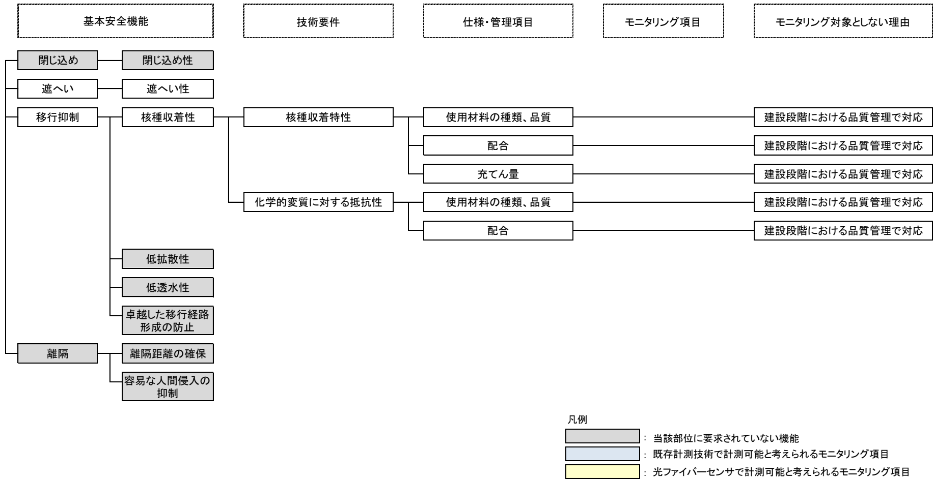
図 2.3-8 機能、技術要件、仕様・管理項目およびモニタリング項目の関係（区画内充てん材、閉鎖措置段階以降）
