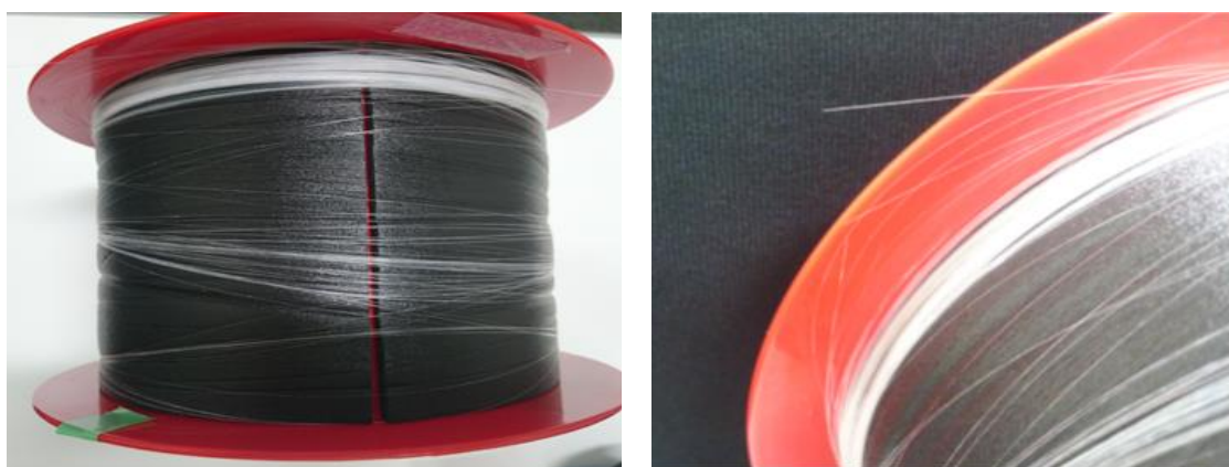
図 3.4-15 高 pH で 10 日浸漬後の汎用タイプの劣化状況
