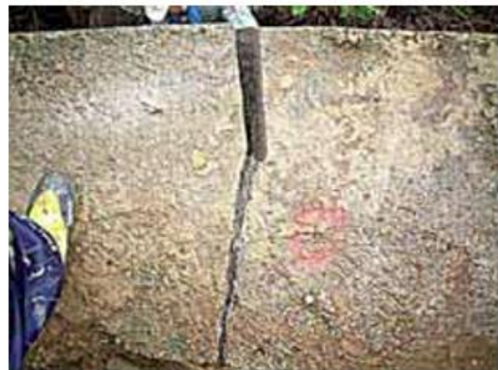
図 2.5-47 板ジャッキの挿入状態と破壊状態[18]
