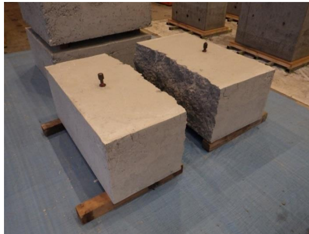
図 2.5-43 試験体の割裂状況
