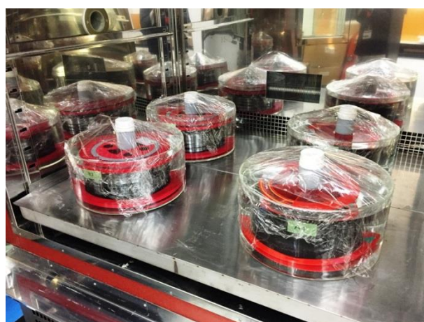
図 3.4-6 恒温槽内での塩水浸漬状況
