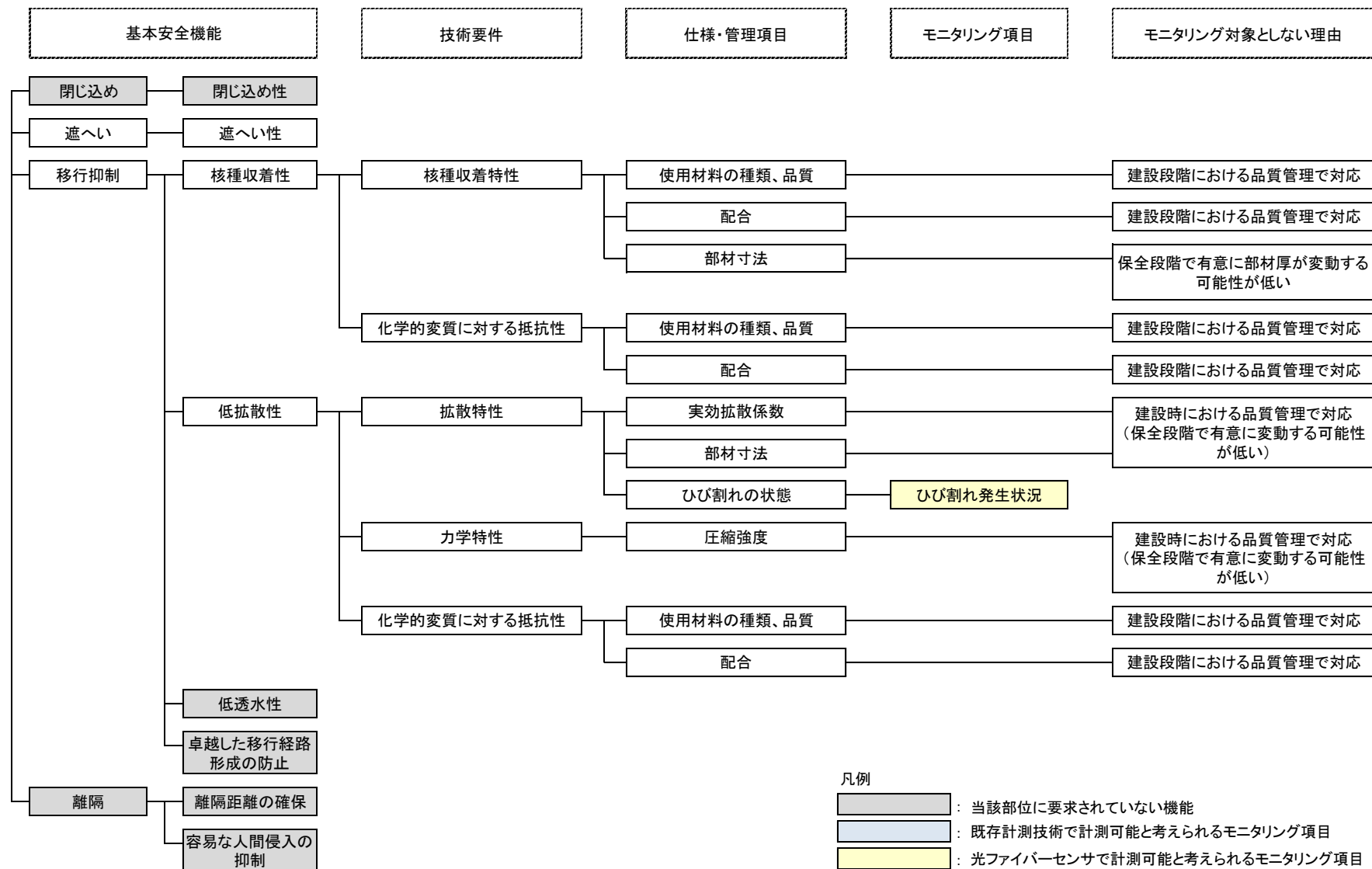
図 2.3-4 機能、技術要件、仕様・管理項目およびモニタリング項目の関係（低拡散層、閉鎖措置段階以降）
