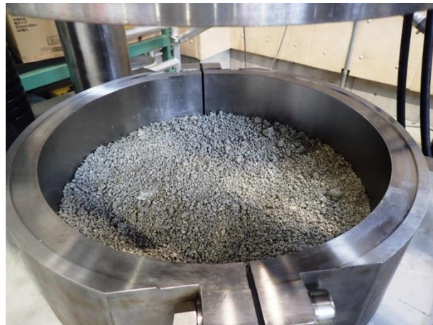
図 3.4-39 ベントナイト敷き詰め状況
