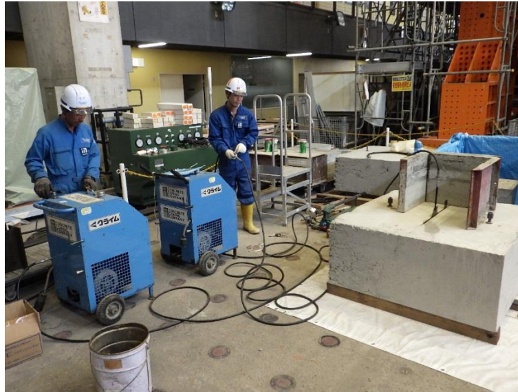
図 2.5-58 板ジャッキによるひび割れ誘発の試験状況
