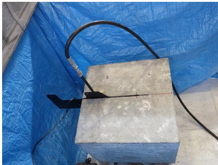
図 2.5-56 板ジャッキの挿入状況(2/2)
