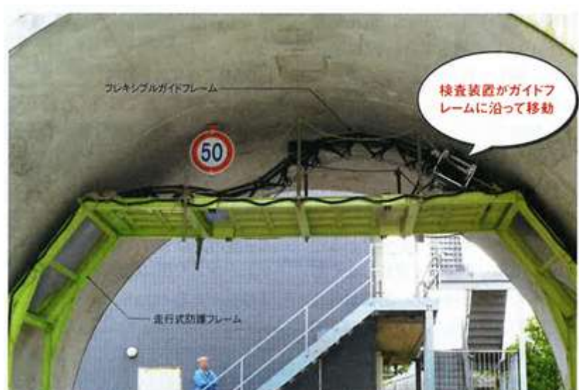
図 3.4.2-13 トンネルの断面形状に合わせて変形可能なガイドフレーム[40]
