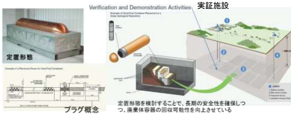
図 5.2.4-2 NWMO が計画する廃棄体定置の概念と実証施設[11]
