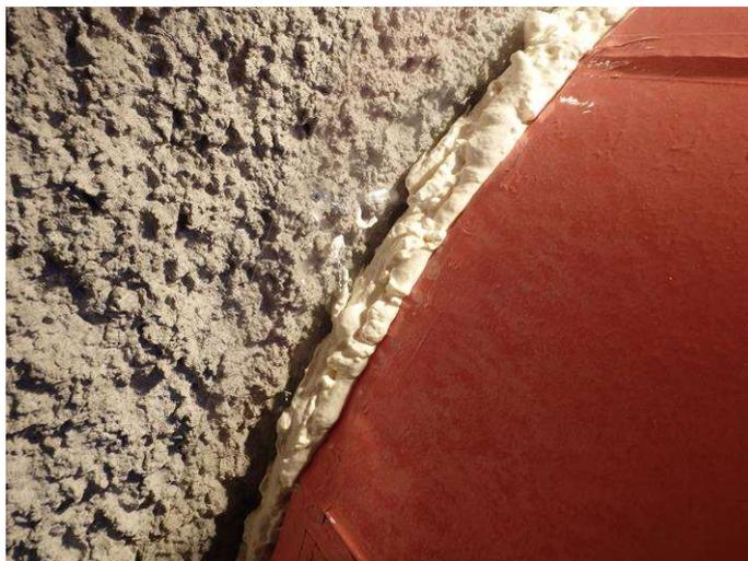
図 2.2.4-12 疑似 PEM 設置状況（棲面と疑似 PEM 間の隙間充填状況）
