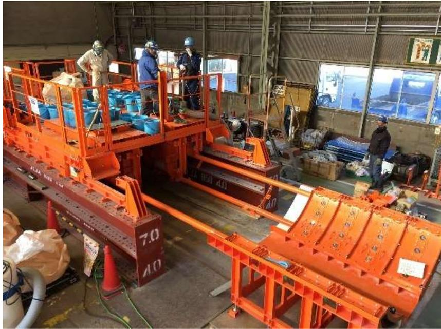
図 4.2.8-11 隙間充填装置および模擬土槽全景
