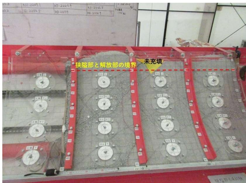
図 4.2.7-13 再充填完了状況
