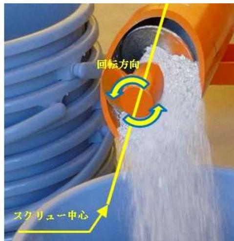
図 4.2.6-31 スクリューコンベアによる移送時の充填材排出状況
