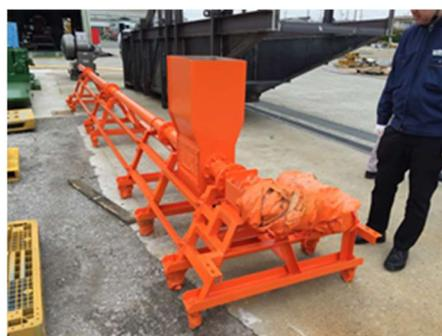
スクリューコンベア試作機全景
