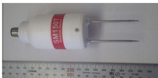
図 4.3.7-5 に示す。また SM150 の測定範囲はロッド中心から 25mm 程度で、ロッド近傍ほど感度が高くなる。出力値はケーブルを介してハンディモニターに表示、もしくはデータロガーで記録される。
