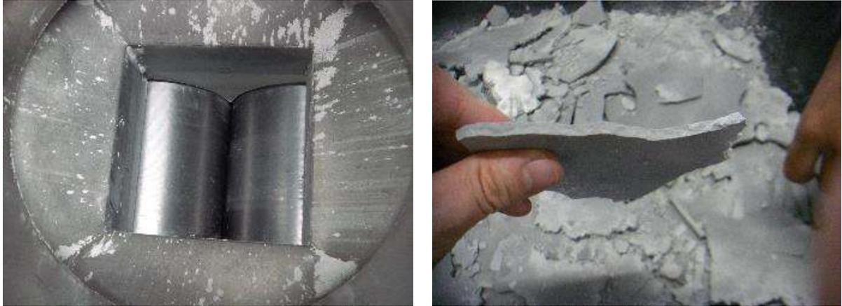
図 4.2.4-9 ロールプレスによるシート状ベントナイトの製造
