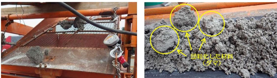
図 4.3.6-8 ダマの発生の様子（左：ふるい、右：発生したダマ）
