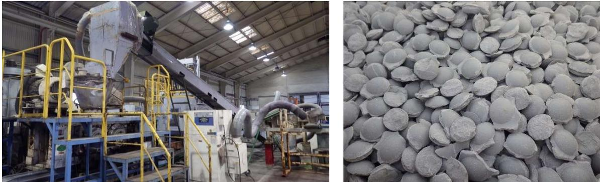
図 4.2.4-4 ブリケッティング法により製造したペレットの外観
