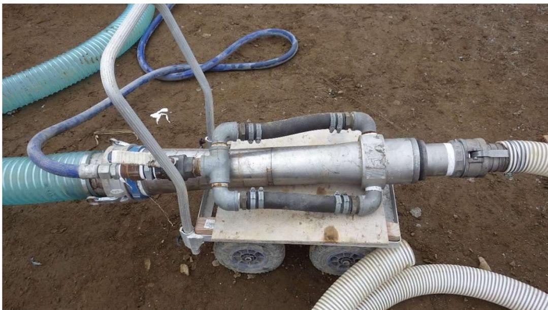
図 4.3.7-17 リバウンド材捕集用装置 (ジェクター)
