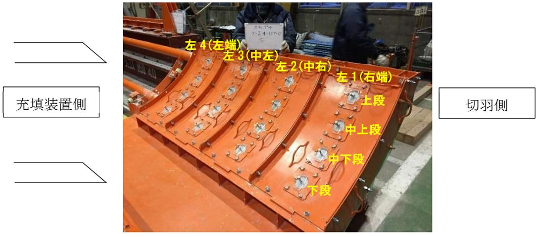
図 4.2.8-2 模擬土槽（左）の仕上がり寸法およびサンプリング位置
