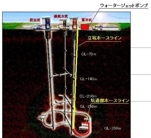
図 5.4.2-2 幌延深地層研究センターでの装置全体配置 (高圧ポンプ地上配置)
