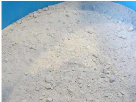
図 4.2.4-10 ロールプレス法により製造したベントナイトペレット
