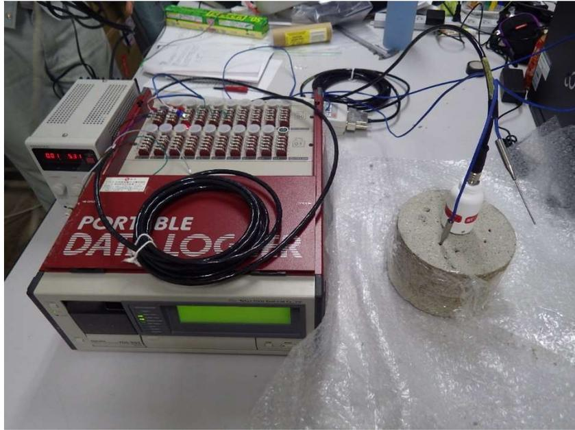
図 4.3.7-11 温度補正式の取得状況（試験時は供試体を養生した）
