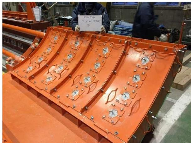
図 4.2.7-15 スクリューの押込み効果の検証のための鋼製模擬土槽
