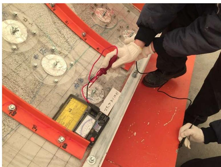
図 4.2.6-14 メガーによる土槽上面への接触の確認
