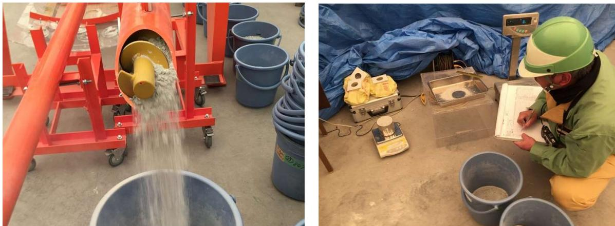
図 4.2.5-3 スクリューコンベアによる移送試験の様子
