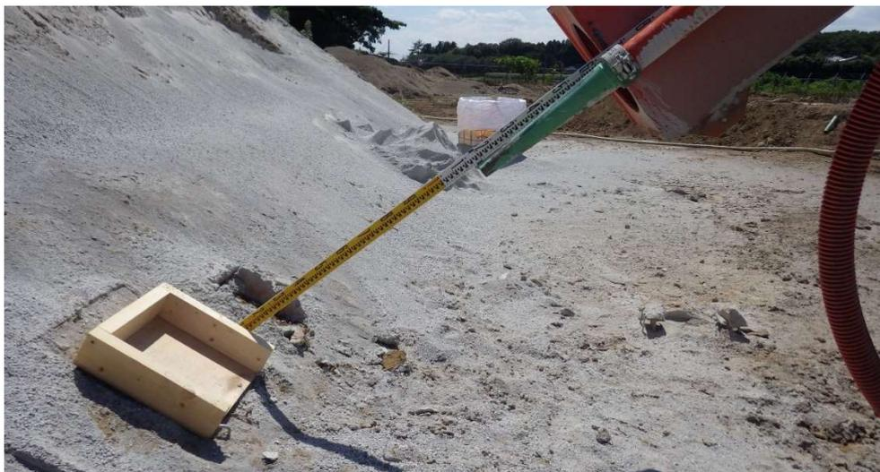
図 4.3.5-3 吹付け試験時の離隔
