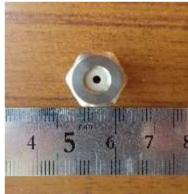
(d) ノズルの噴射孔
