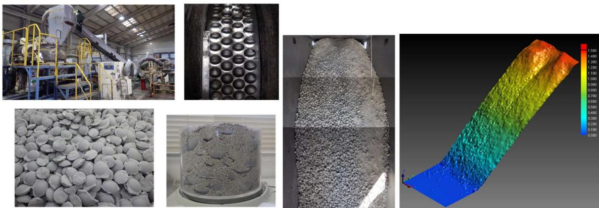
図 2.1.2-3 ペレット充填方式による隙間充填技術の整備状況
