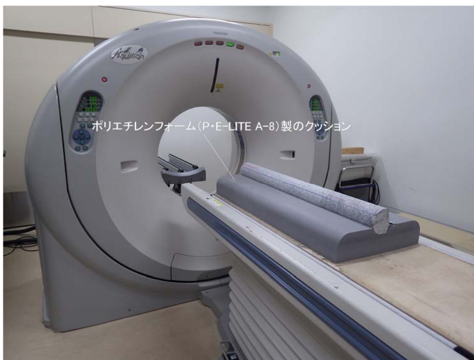
図 4.3.5-1 医療用X線CTスキャナーによるレジン充填コアの撮影
