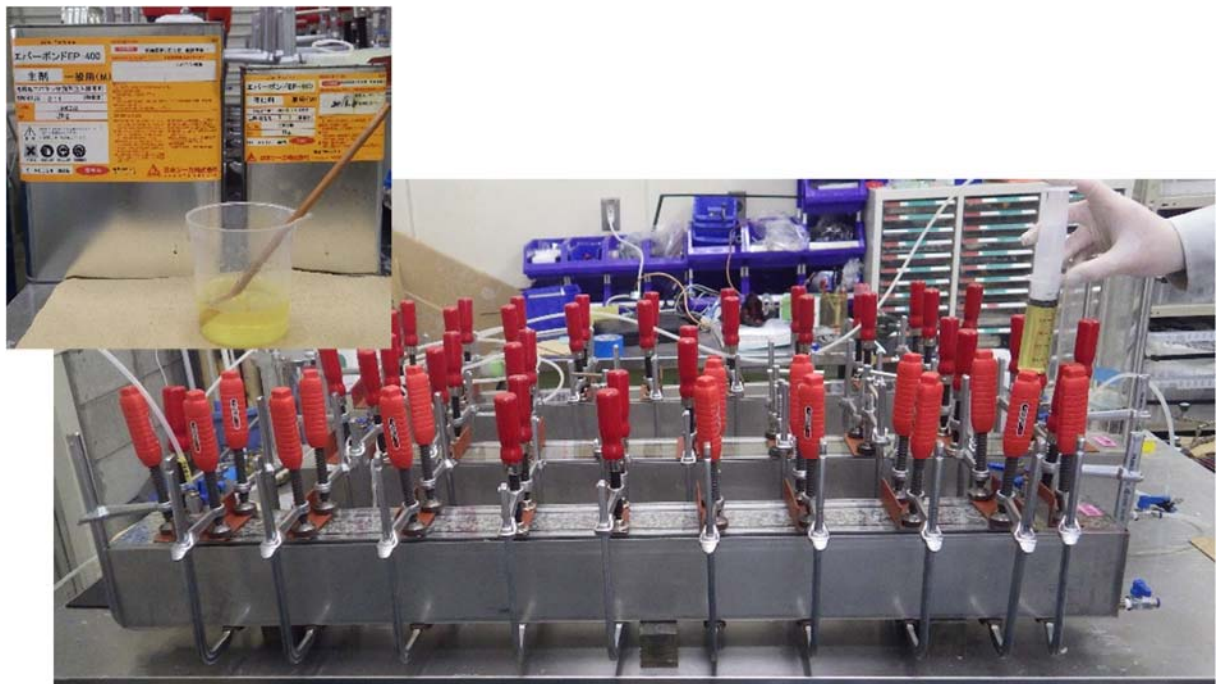
図 4.4.4-9 レジンの注入状況
