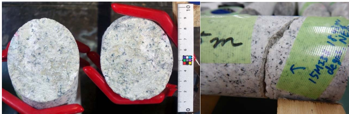
図 4.1.4-3 気泡が発生する割れ目の様子（左：割れ目面、右：側面）（H29GR05）
