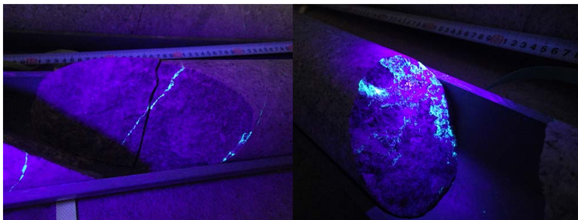
図 4.3.4-35 17MI61 号孔のコアで確認されたレジン（左：N44W/64NE・N19W/87E、右：N9E/25E）
