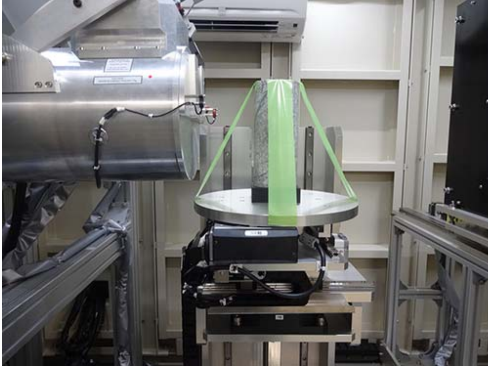
図 4.3.5-2 マイクロフォーカス X 線 CT スキャナーによるレジン充填コアの撮影
