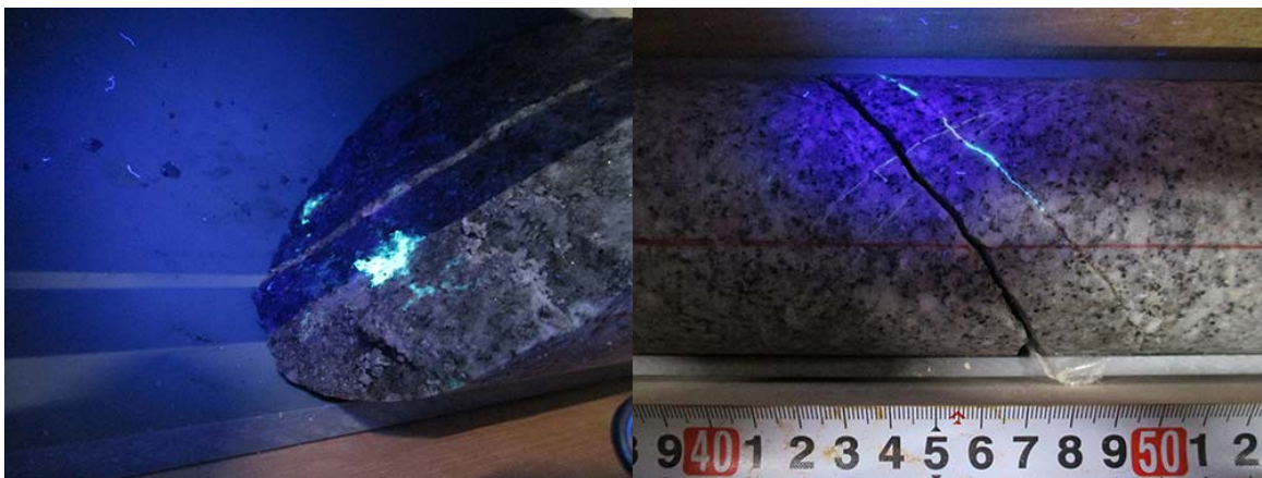
図 4.3.4-37 17MI62 号孔のコアで確認されたレジン (左 : N34E/29SE、右 : N31W/82SW)
