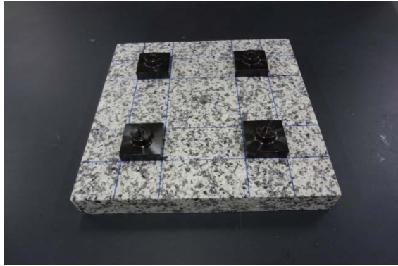
図 4.3.2-40 アタッチメントの接着位置
