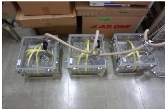
図 4.3.2-29 供試体の脱気の様子
