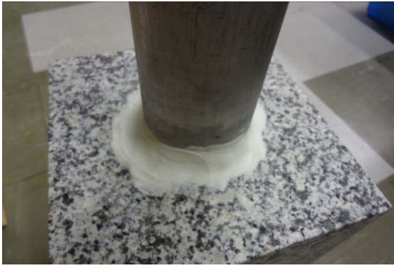
図 4.3.2-66 ボンド接着後の様子
