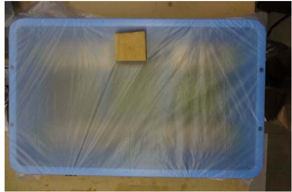
図 4.3.2-49 地下水による養生の様子
