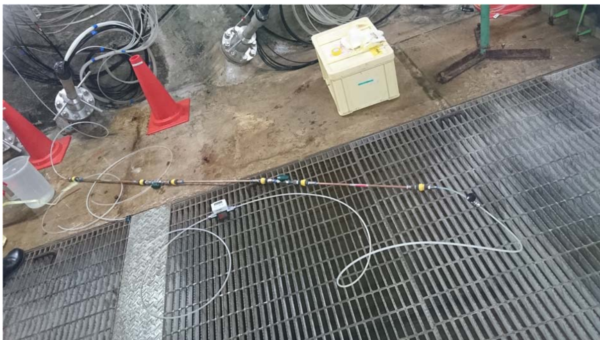
図 5.3.1-4 希ガスサンプリング状況
