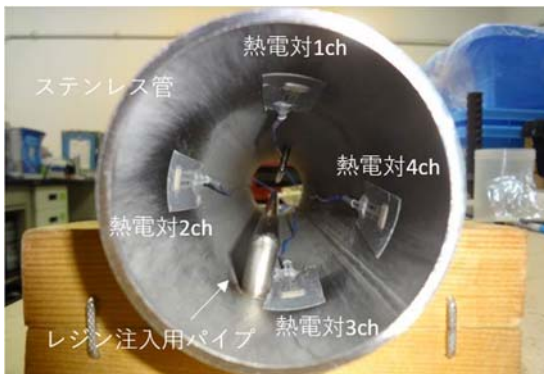
図 4.3.2-68 熱電対の設置
