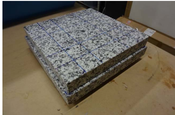
図 4.3.2-25 供試体上下の接着
