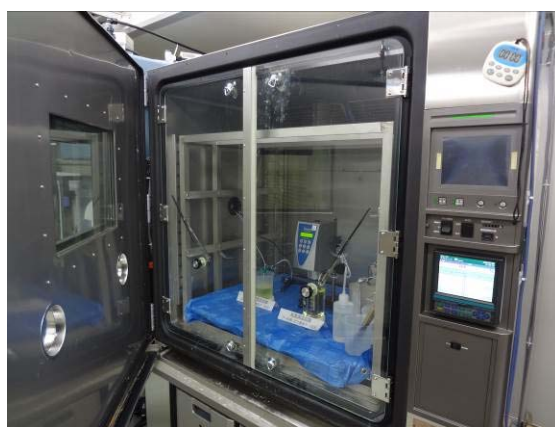
図 4.3.2-4 恒温恒湿槽内での試験の様子
