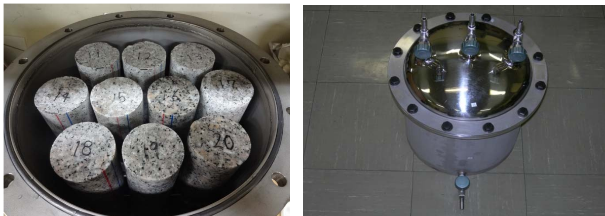
図 4.1.5-1 岩石からのラドンフラックスの測定例
