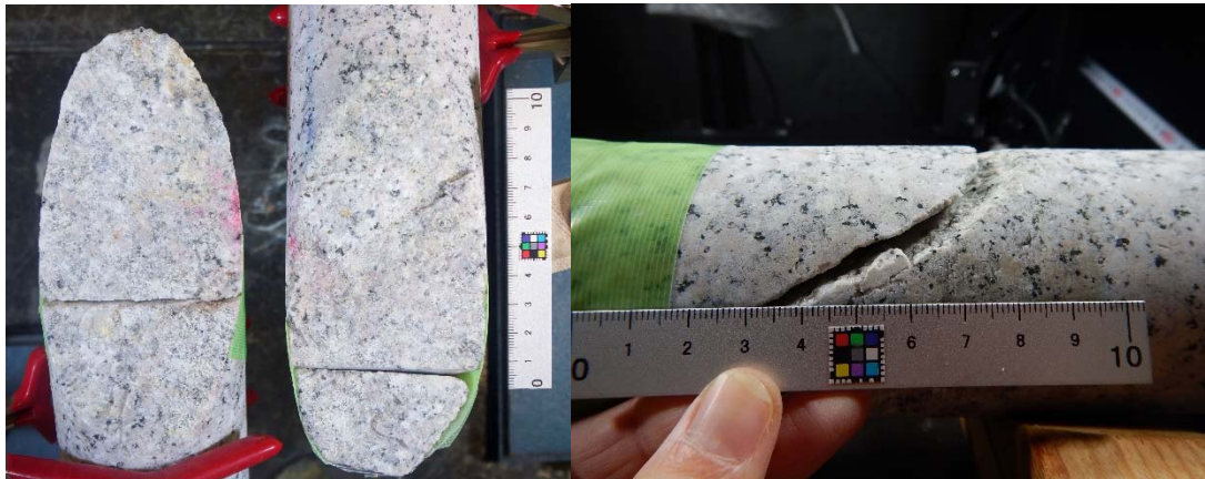
図 4.1.4-2 気泡が発生する割れ目の様子（左：割れ目面、右：側面）（H29GR01）
