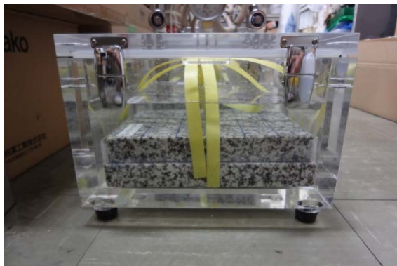
図 4.3.2-28 供試体の水中養生の様子
