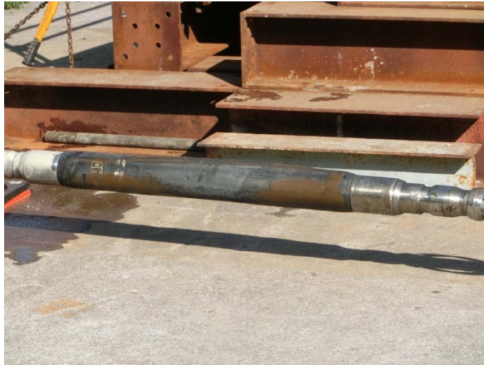
図 5.2.3-19 回収したパッカー (パッカー①)
