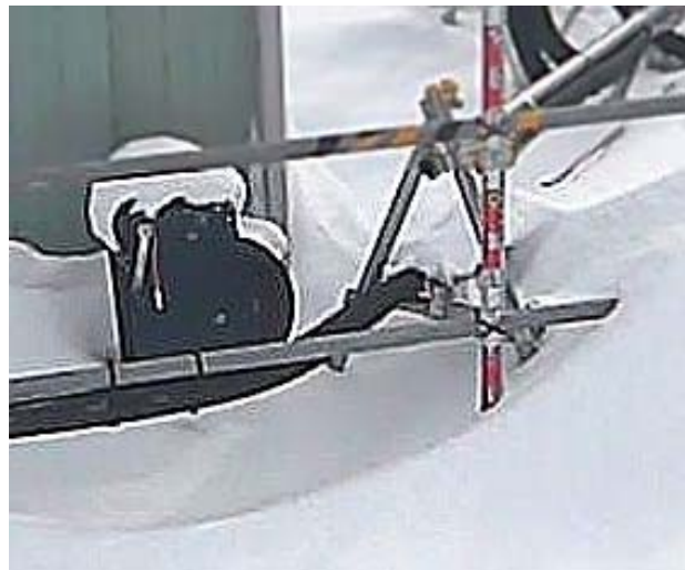
図 7.6.7-2 ウェブカメラによる積雪量測定
