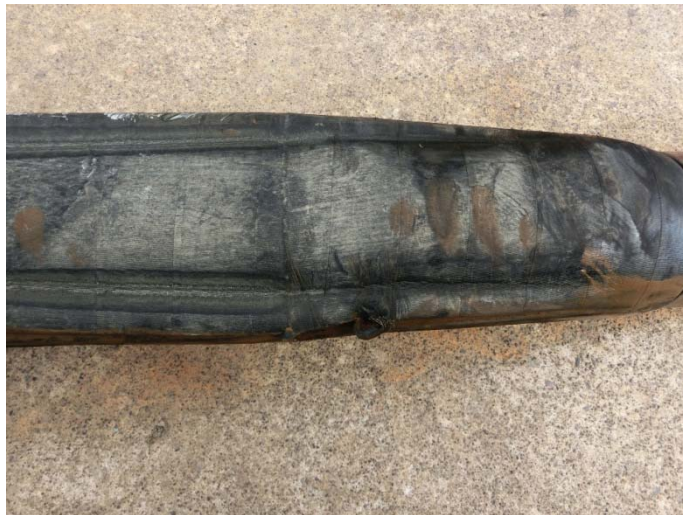
図 5.2.3-20 パッカー変形部 (パッカー②)
