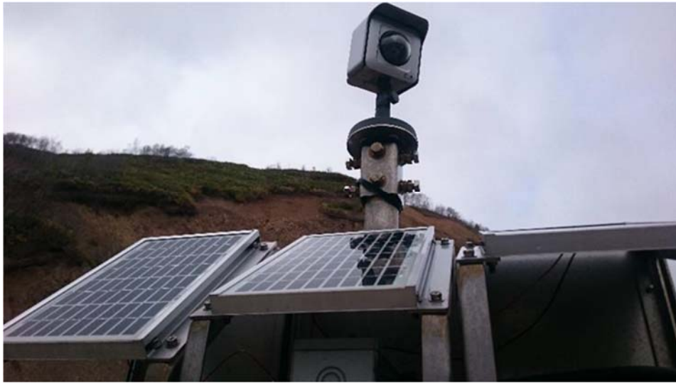
図 5.1.7-4 設置角検証用太陽光パネル
