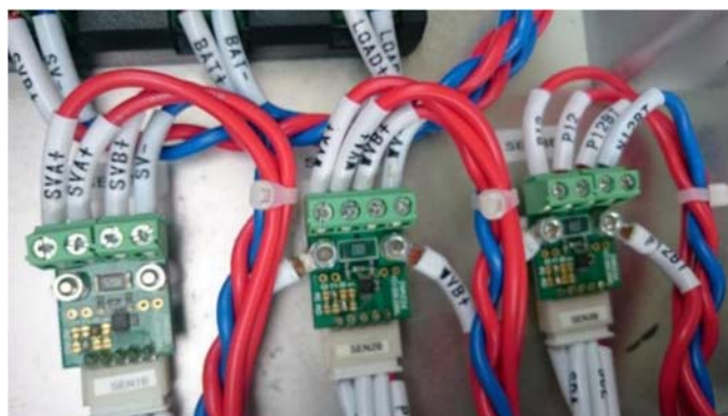
図 5.1.2-6 電力センサー基板
