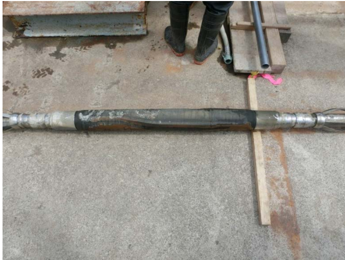
図 5.2.3-16 回収したパッカー (パッカー④)
