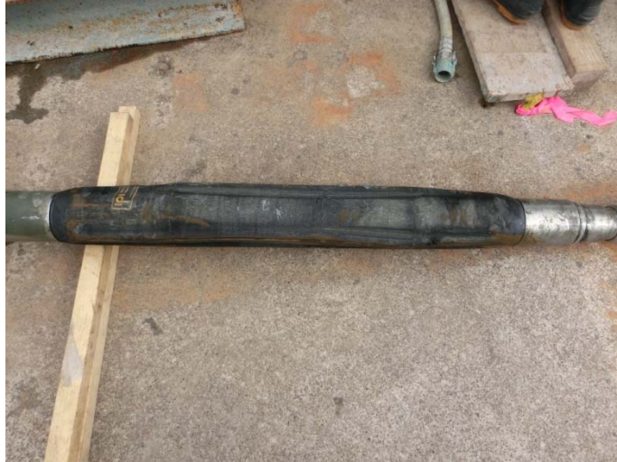
図 5.2.3-18 回収したパッカー (パッカー②)
