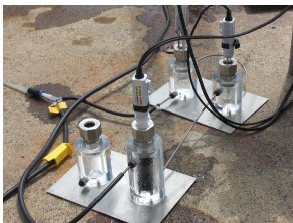
図 7.4.1-1 フローセルによる物理パラメーター測定
