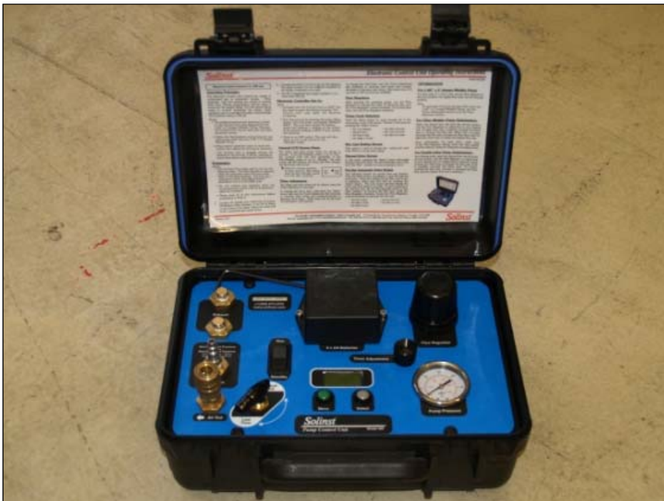
図 7.3.1-2 ポンプコントロールユニット
