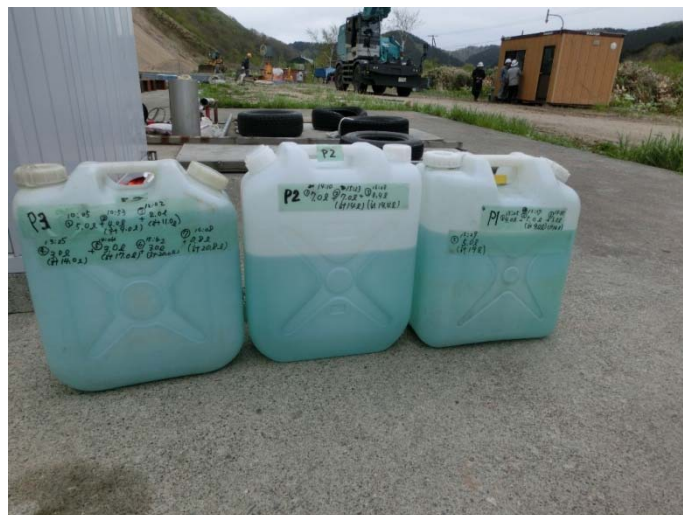
図 5.2.3-5 回収したパッカー拡張水①
