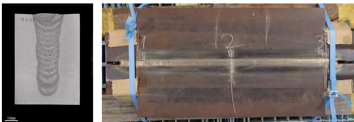
図 3.1-10 改良溶接試験体の外観と断面マクロ観察
