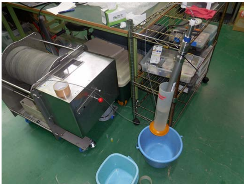
図 3-5 巻き取り装置（左）と Oceanseven303 プローブ
