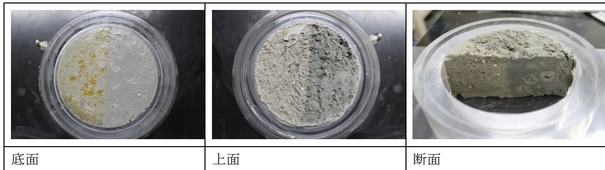
図 4.2-44 解体状況（人工海水 1ml/min 通水 ペレット+ブロック）
