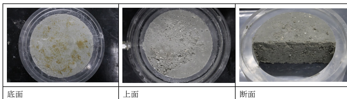
図 4.2-36 解体状況（人工海水 10ml/min 通水 ブロック）
