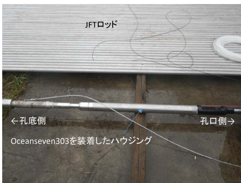
図 3-6 JFT ロッド（上）と Oceanseven303 を装着したハウジング（下）
