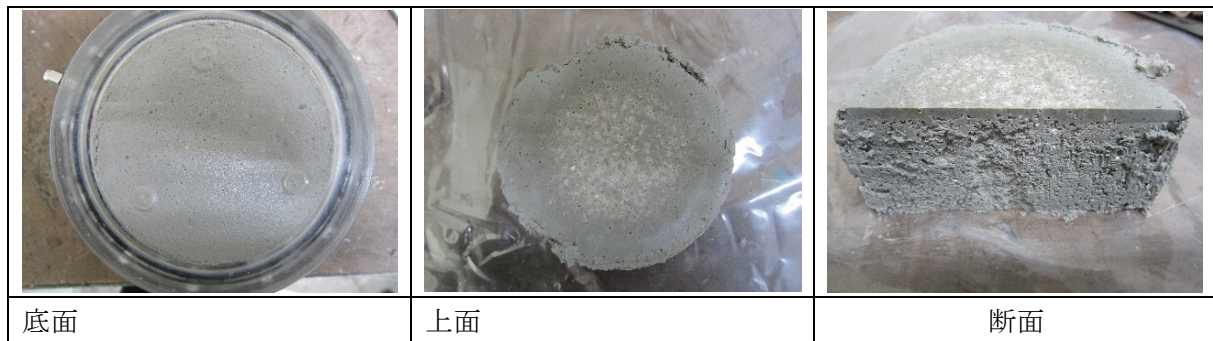
図 4.2-5 解体状況 (MgCl 2 水溶液 1ml/min 通水 ブロック)
