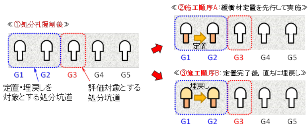
図 3.5.3-3 施工順序による坑道状況の違い
