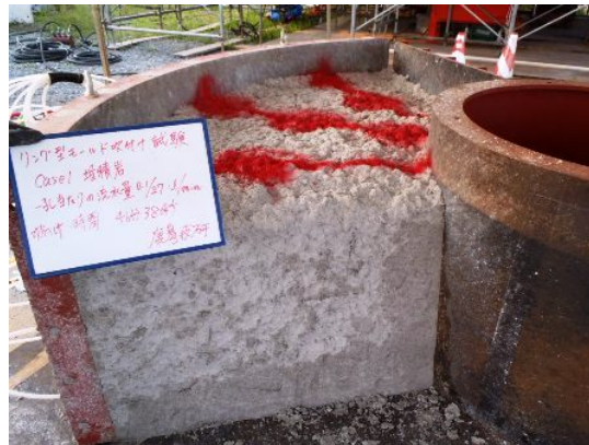
図 3.6.1-2 吹付け後の施工部 (Case1)
