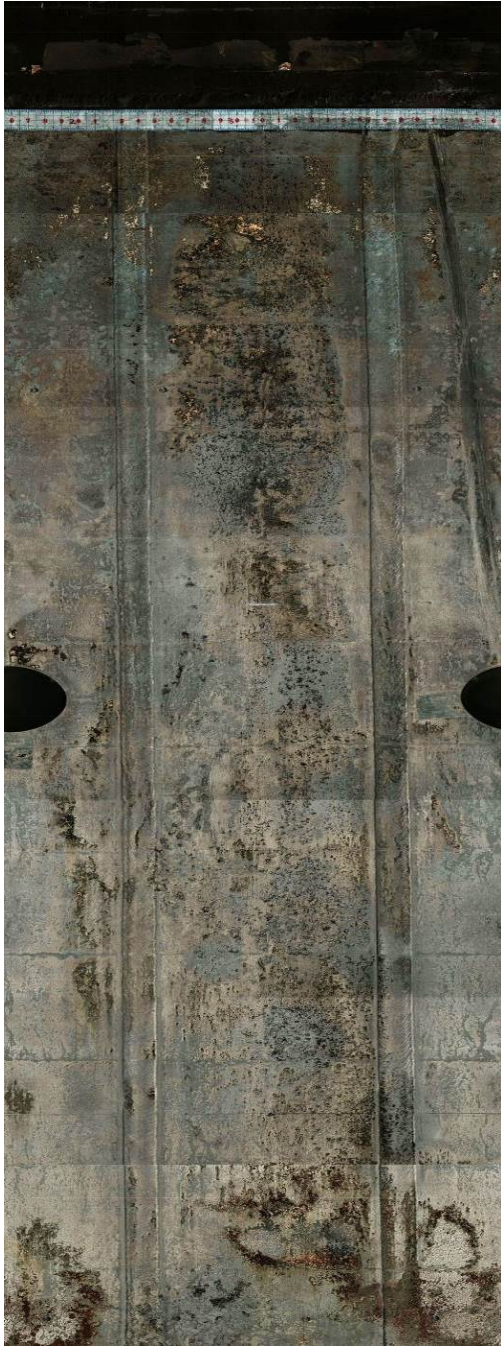
(a) 酸洗後の模擬オーバーパック試験体表面
