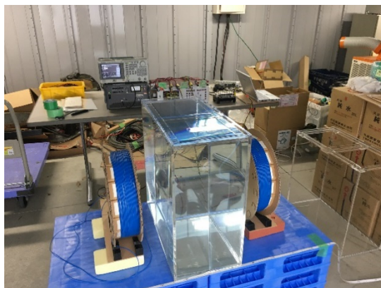
図 5.4.3-15 塩水を介した給電試験
