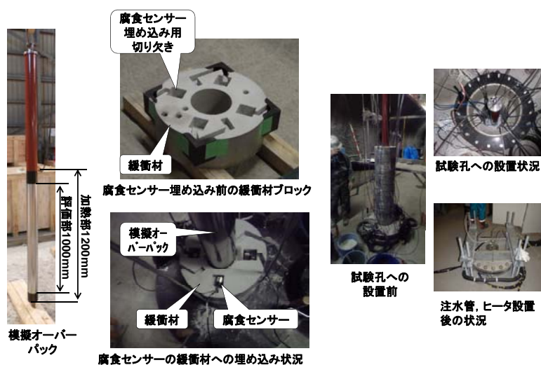
図-3 緩衝材中への腐食センサー設置状況と試験孔への試験体の設置状況
