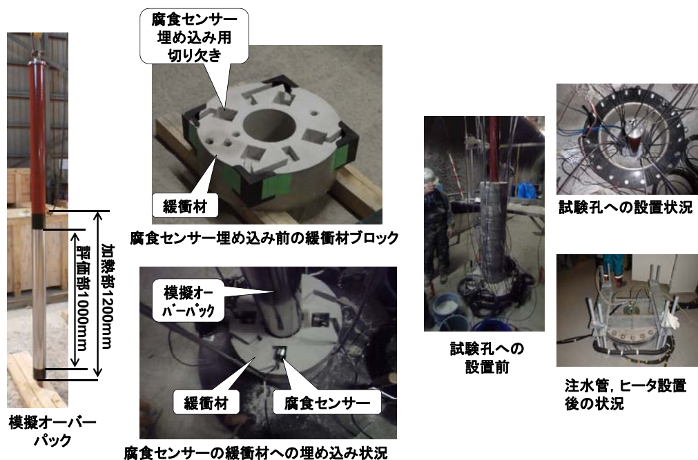
図2.2.3-4 緩衝材中への腐食センサー設置状況と試験孔への試験体の設置状況
