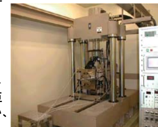
図4 断層模擬試験設備
