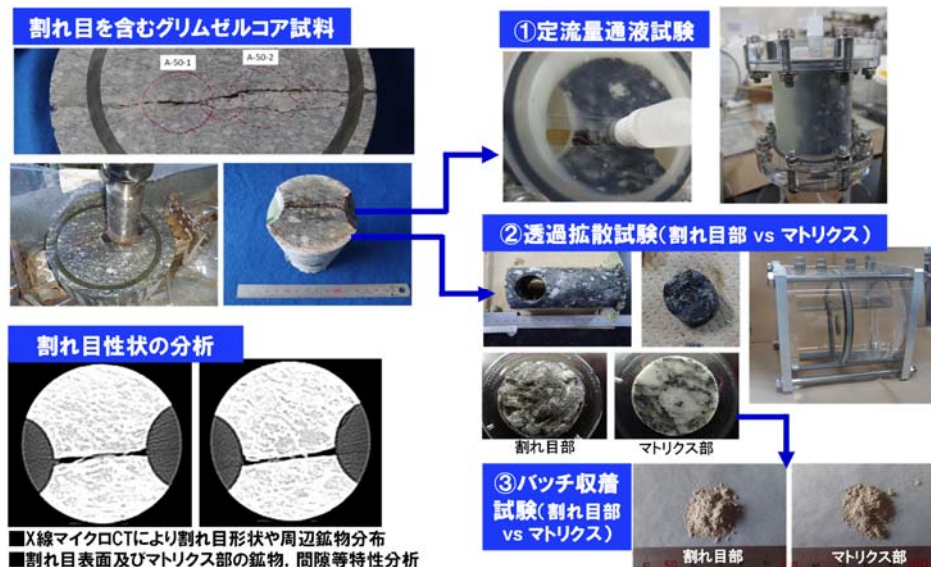
図2.4.2-3 割れ目を含むグリムゼル花崗岩を対象とした室内試験の体系
