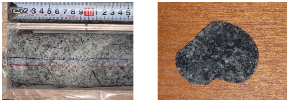
図 2.2.1-2 断層角礫岩 (左)、割れ目面に付着する緑泥石 (右) (左写真 ; 14MI49 号孔/8.0~8.1m 付近、右写真 ; 14MI49 号孔/14.85m 付近)
