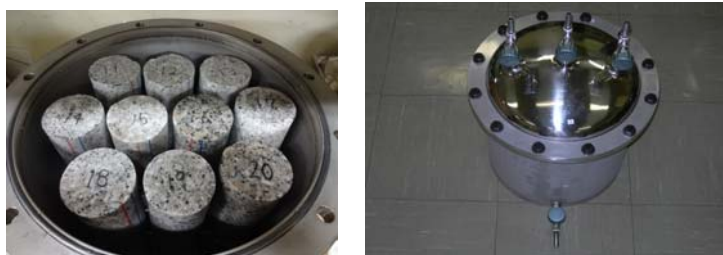
図 5.1.4-1 ラドンフラックス測定のための浸漬試験 (左：容器内にセットした花崗岩コア 右：気密容器)
