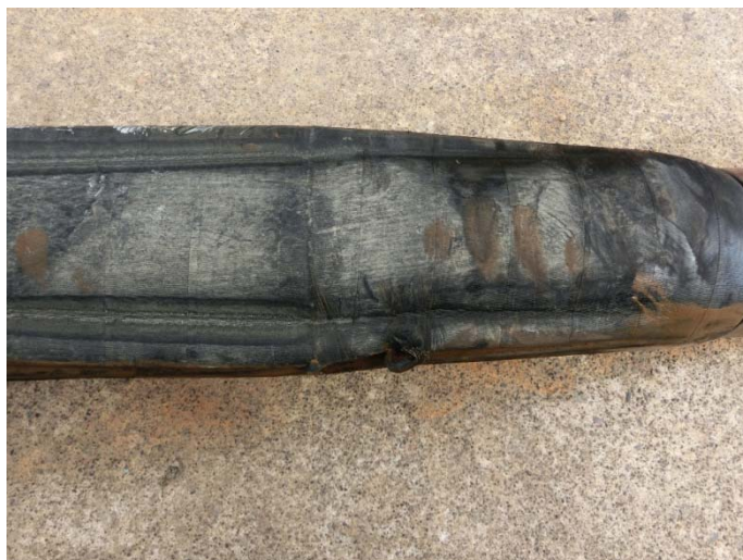
図 5.2-16 パッカー変形部 (パッカー②)
