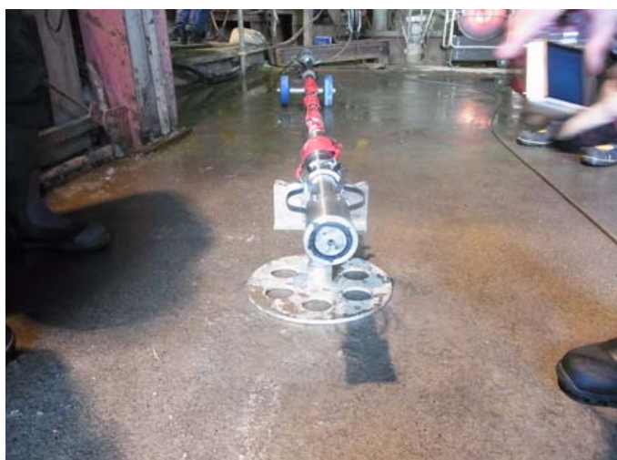
図 3.4-6 発破後の装薬治具状況
