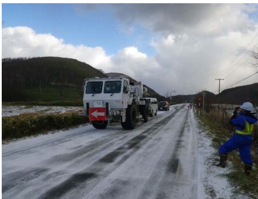
図 3.3-2 バイブロサイス震源の路上発振作業
