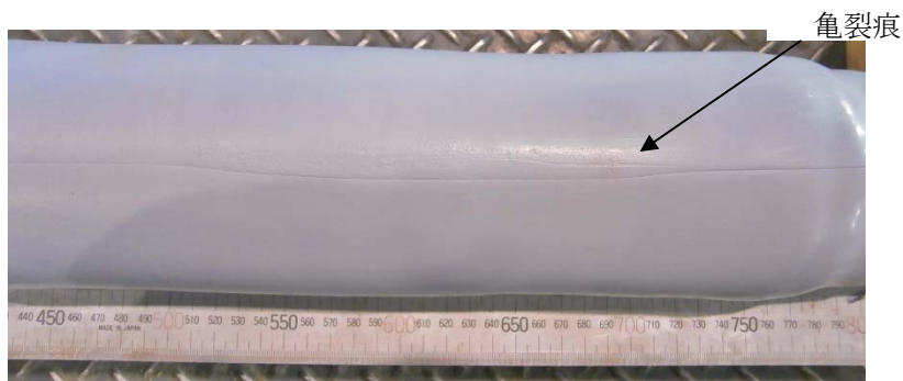
図 3.2-2 熱収縮ゴムチューブの亀裂痕
