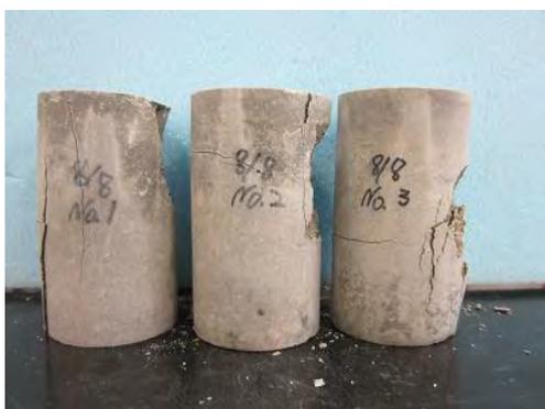
写真 4.2.3-31 1次打設時 28日強度試験（混和剤無しケース破壊状況）
