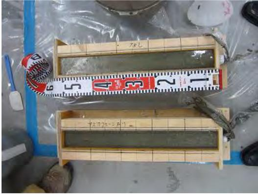
写真 4.2.3-21 混和剤無し 2次打設完了
