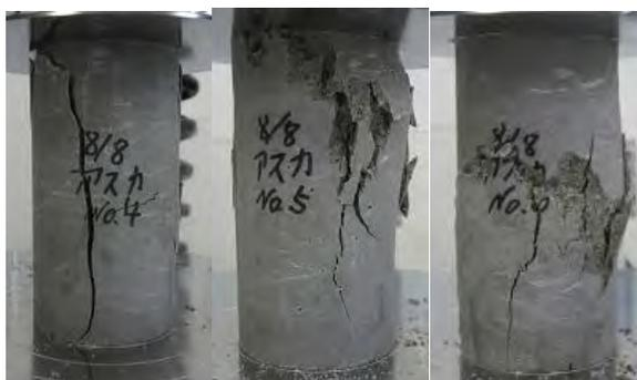
写真 4.2.3-35 91日強度試験 1次打設時混和剤有りケース試験破壊状況
