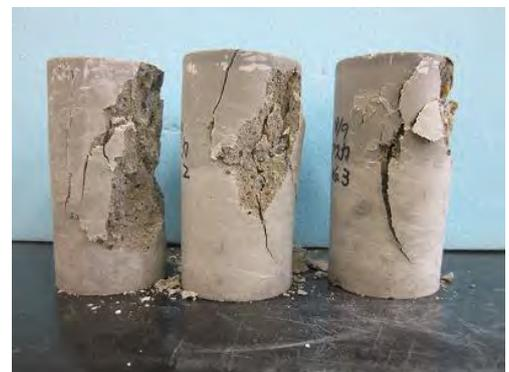
写真 4.2.3-30 2次打設時 28日強度試験破壊状況
