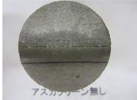
写真 4.2.3-28 混和剤無し打継面供試体（線入り部が1次打設）
