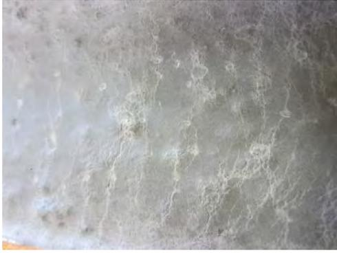
写真 4.2.3-14 混和剤有り打継面
