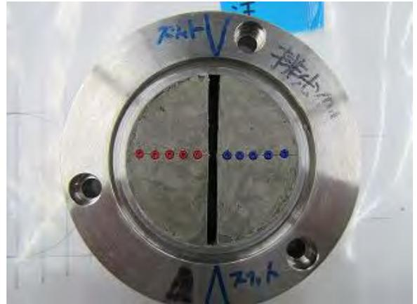
写真 4.2.2-51 排水側の評点設置 (5mm 間隔)
