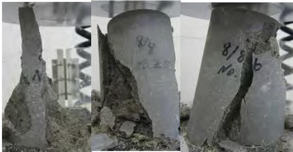
写真 4.2.3-33 91日強度試験（1次打設時混和剤無しケース破壊状況）
