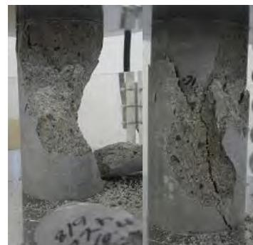
写真 4.2.3-36 91日強度試験 2次打設時混和剤有りケース破壊状況
