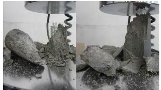
写真 4.2.3-34 91日強度試験（2次打設時混和剤無しケース破壊状況）
