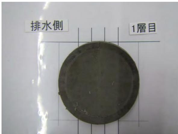
写真 4.2.2-84 1層目の切断面(排水側)
