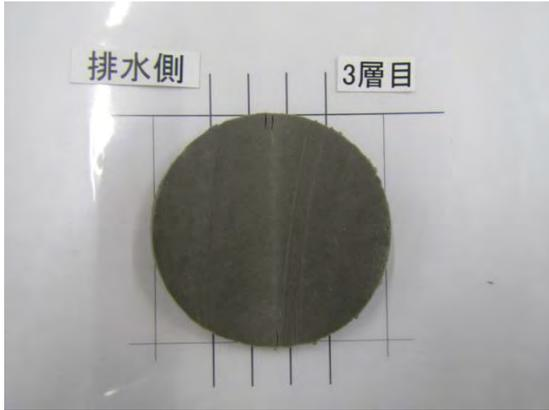
写真 4.2.2-86 3-4層目の切断面(排水側)
