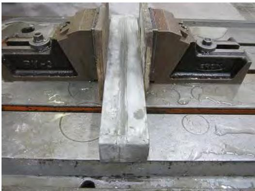
写真 4.2.3-25 コア抜き (右側が1次打設部)
