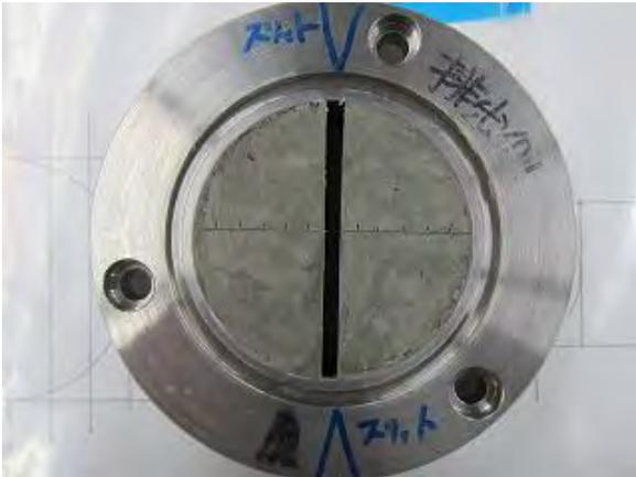
写真 4.2.2-50 圧縮成型後の供試体 (排水側)
