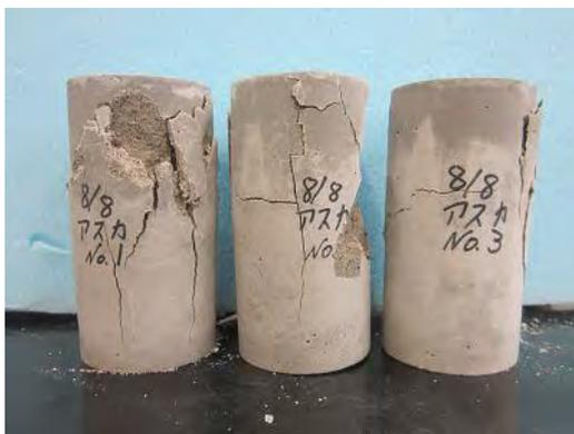
写真 4.2.3-29 1次打設時 28日強度試験破壊状況
