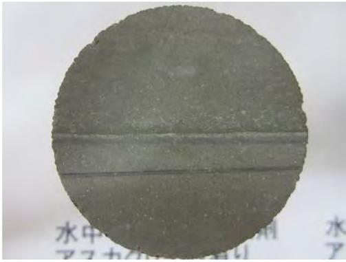
写真 4.2.3-27 混和剤有り打継面供試体（線入り部が1次打設）
