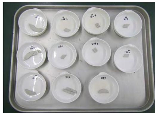
写真 4.2.2-81 含水比試験後の試料
