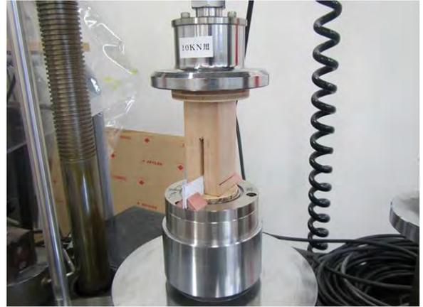
写真 4.2.2-49 供試体の圧縮成型
