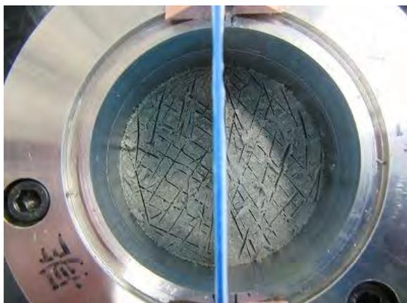
写真 4.2.2-96 1層目締固め後
