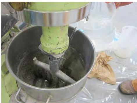
写真 4.2.3-3 ミキサー攪拌状況
