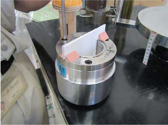
写真 4.2.2-48 供試体の作製 (ガミースリットの設置)
