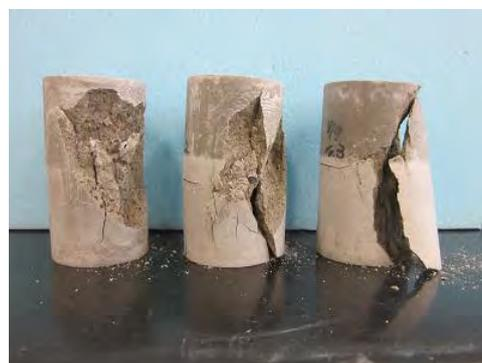
写真 4.2.3-32 2次打設時 28日強度試験（混和剤無しケース破壊状況）
