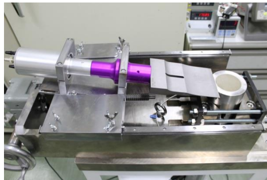
図 3.2.4-6 解体用スライサー
