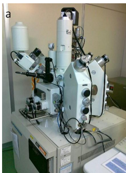
図 4.2.2-3 試料の分析と観察に用いた分析装置(EPMA)
