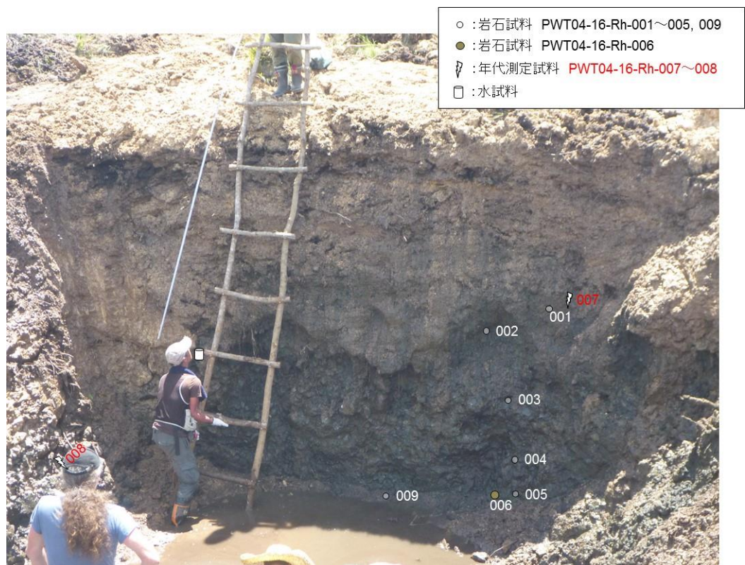
図 3.1.3-3 トレンチ 4 での ^{14}\text{C} 年代測定用試料の採取位置 (赤字の 007~008)
