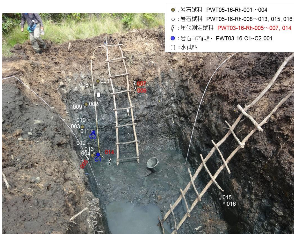
トレンチ 5 での ^{14}\text{C} 年代測定用試料の採取位置（赤字の 005~007, 014）
