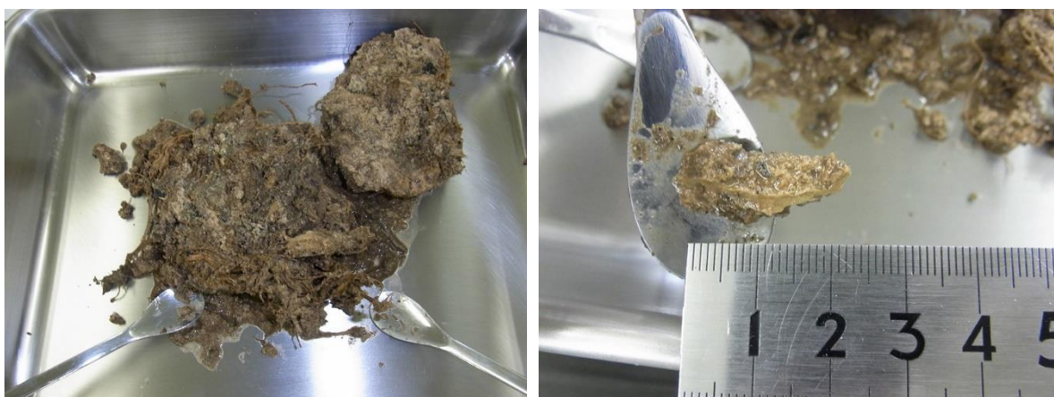
図 3.3.3-5 炭酸塩試料（PWT05-16-Rh-007）の前処理の状況
