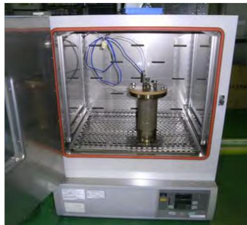
図 2.2.2-5 中温（160℃）における浸漬試験状況
