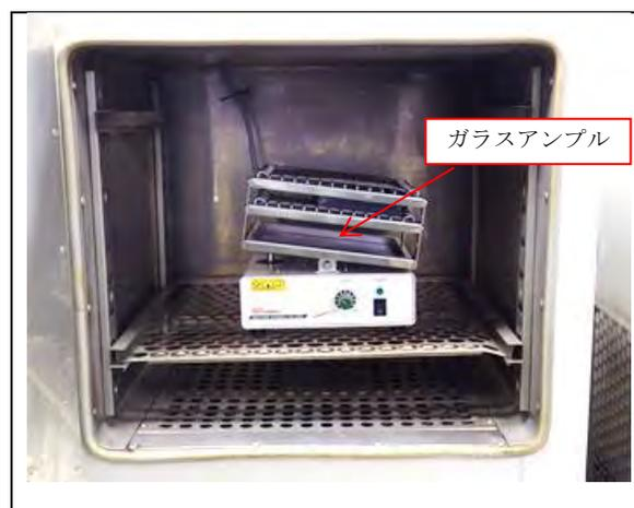
図 2.5.1-4 ジルコニウム水素化物の浸漬試験状況
