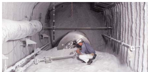
アッセII研究鉱山での実規模キャスクを用いた実験の様相 (写真提供：DBE)
