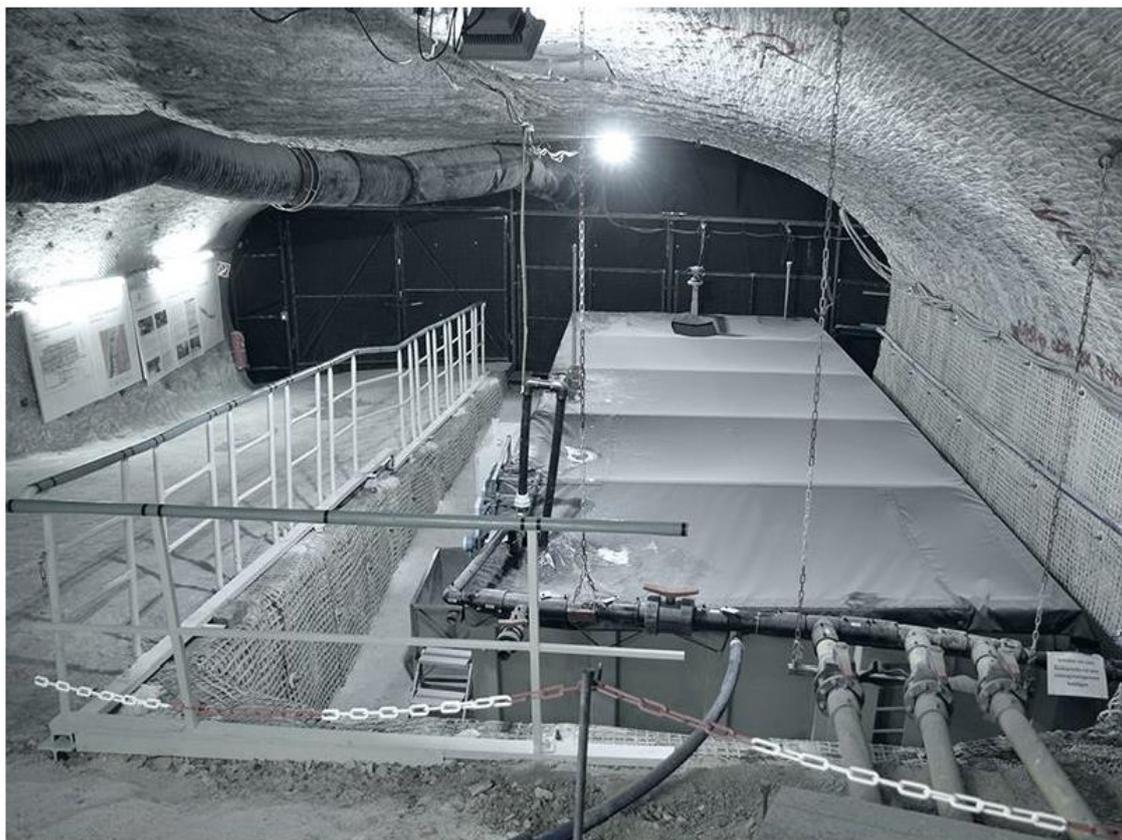
図 8.2-3 アッセ II 研究鉱山の侵入水の主要な収集槽
