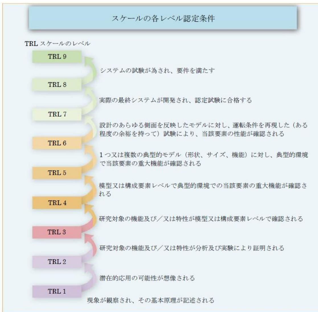
図 3.2-8 ある要素の技術的な即応力を評価する TRL（技術成熟度）尺度
