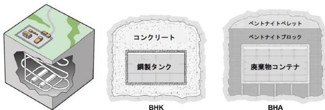
図 2.1-13 SFL の予備的なレイアウトと、提案されている処分場概念。1 つは炉心機器用の岩盤ヴォールト（BHK）であり、もう 1 つは遺産廃棄物用の岩盤ヴォールト（BHA）である。
