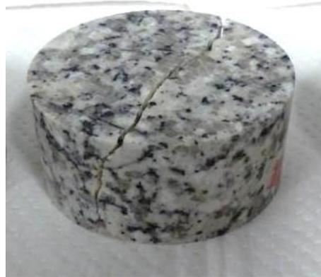
図 12 巨視き裂を含む土岐花崗岩（直径 50mm，厚さ 25mm）
