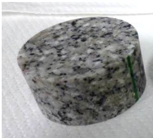
図 1 透水試験で用いた花崗岩試料
