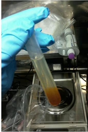
図 4-5 4価プルトニウム水酸化物の懸濁母溶液
