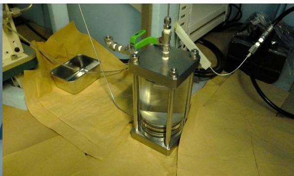
図 19 粘土懸濁水貯留タンク
