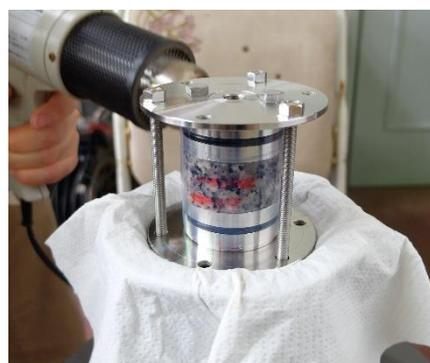
図 15 供試体を被覆している様子
