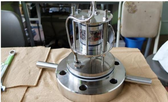
図 16 圧力容器のふたにセットした供試体
