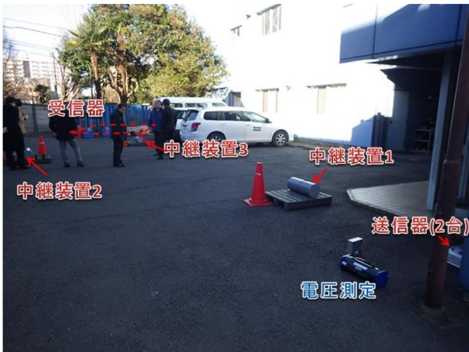
図 3.2.2-44 データ分岐試験状況
