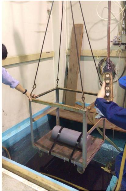
図 3.2.2-23 筐体の水没状況
