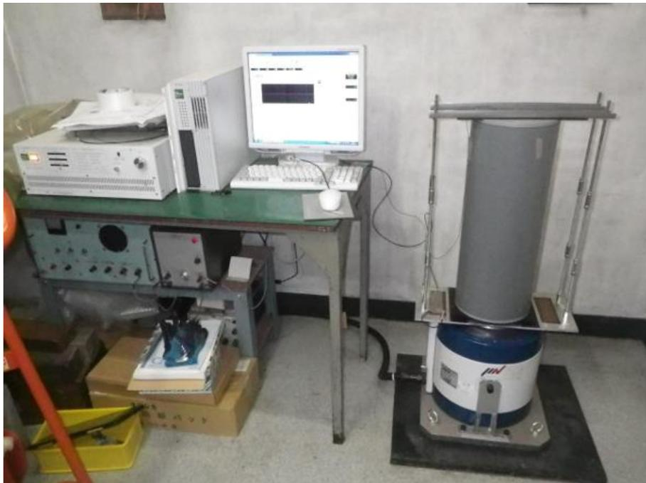
図 3.2.2-33 包装貨物振動試験状況
