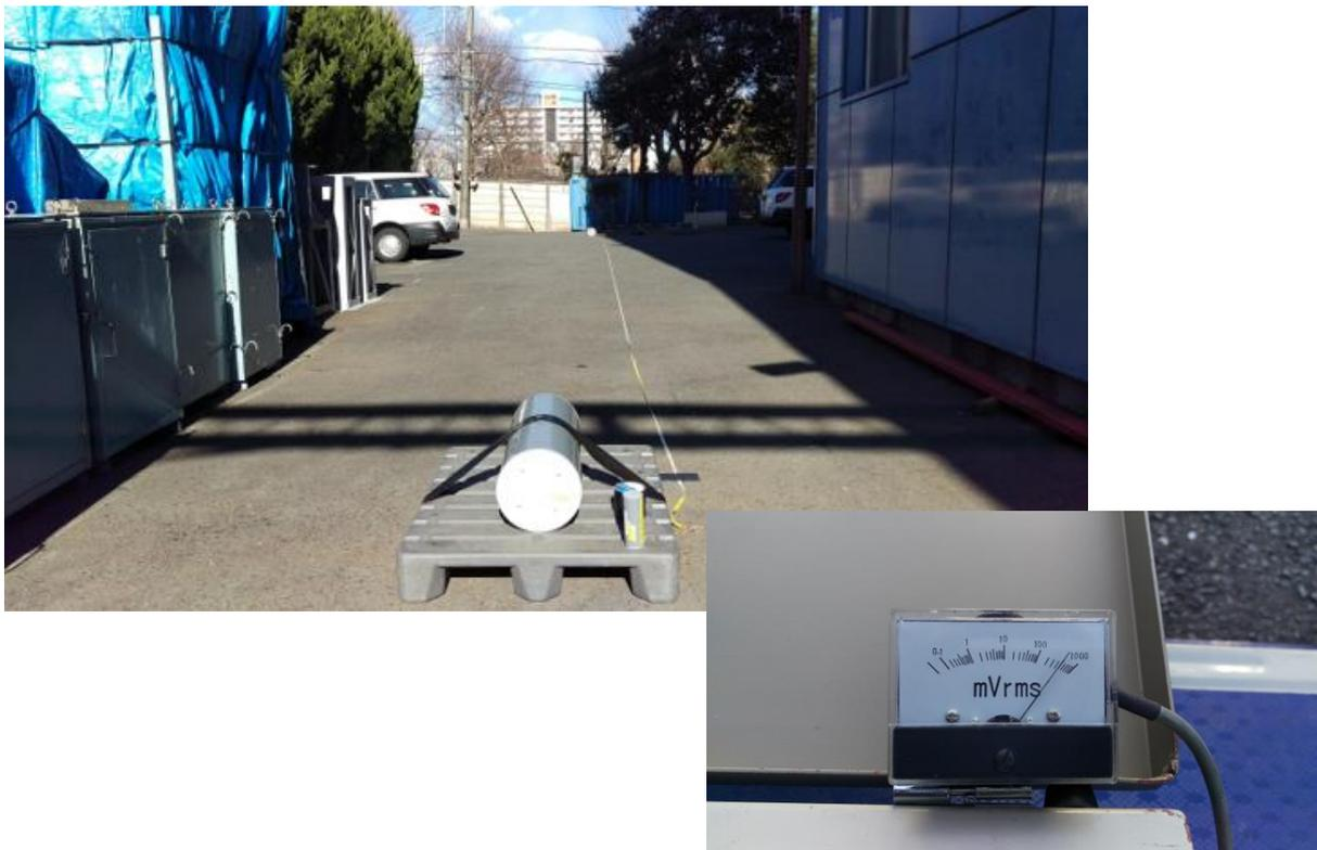
図 3.2.2-32 温度試験後の動作確認（数百 mVrms の受信信号を確認）
