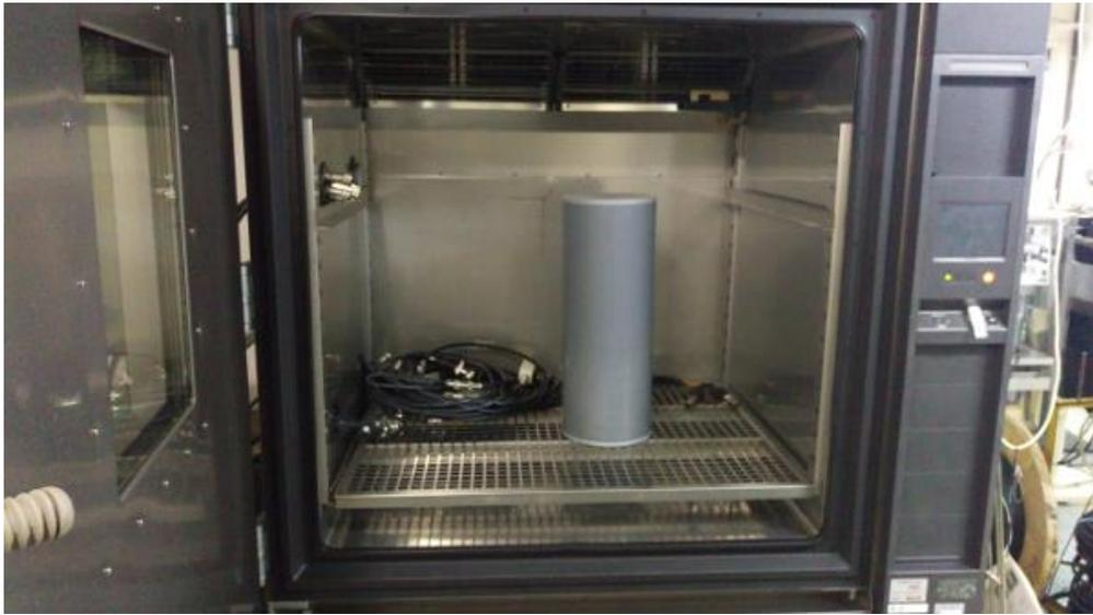
図 3.2.2-31 温度試験状況（恒温器内部の中継装置）
