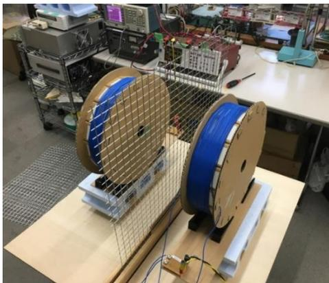
図 3.3.4-7 溶融金網を介した給電効率の影響評価
