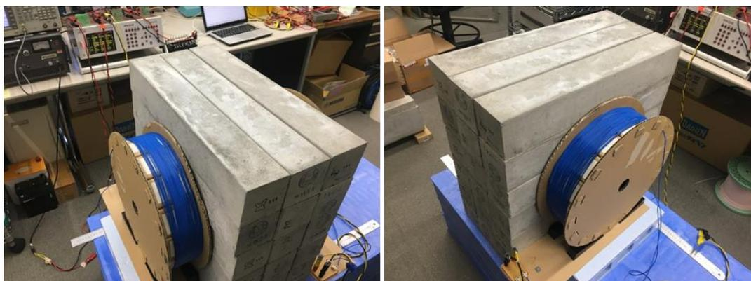
図 3.3.4-14 コンクリートを介した給電効率の影響評価
