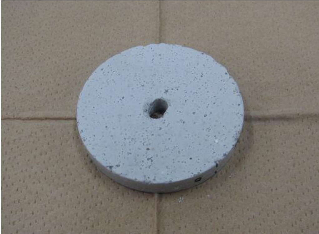
図 4.6.1-29 緩衝材ブロックの中心部加工状況
