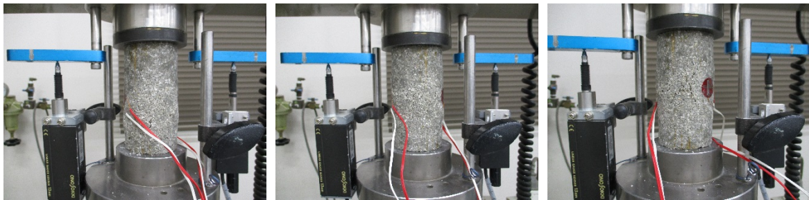
一軸圧縮試験 後供試体④~⑥（乾燥密度 1.8\text{Mg/m}^3 初期含水比 8%）
