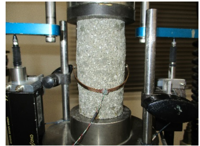
一軸圧縮試験 後供試体⑦~⑨ (乾燥密度 1.8\text{Mg/m}^3 初期含水比 8%)
