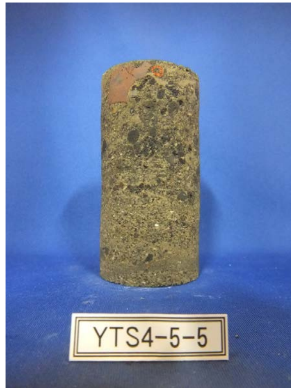
クリープ試験 ( \sigma_c'=0.1\text{MPa} 応力比=0.35) 供試体③
