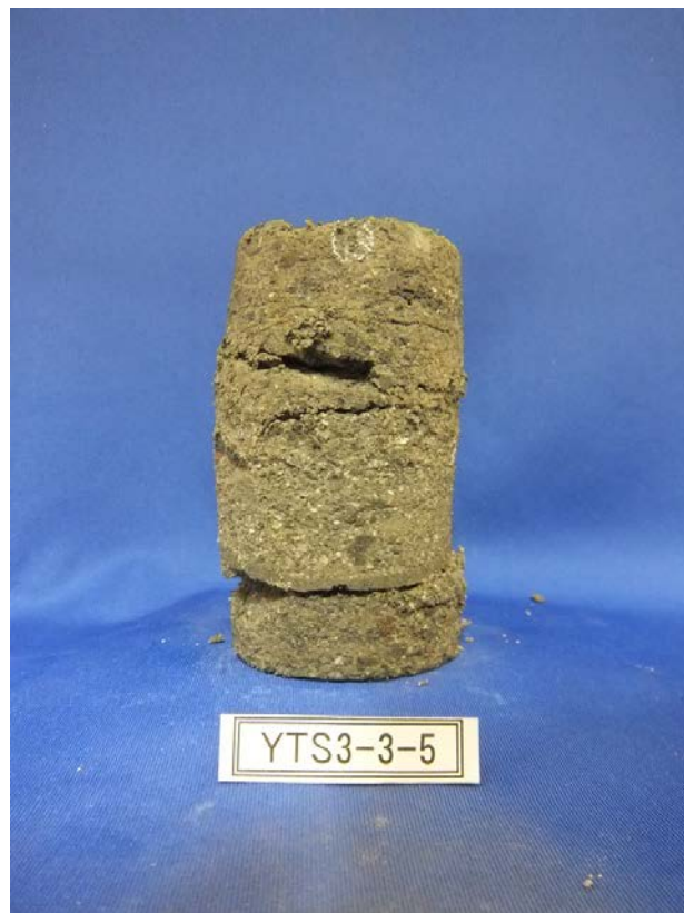
三軸圧縮試験 ( \sigma_c'=7\text{MPa} ) 後供試体④
