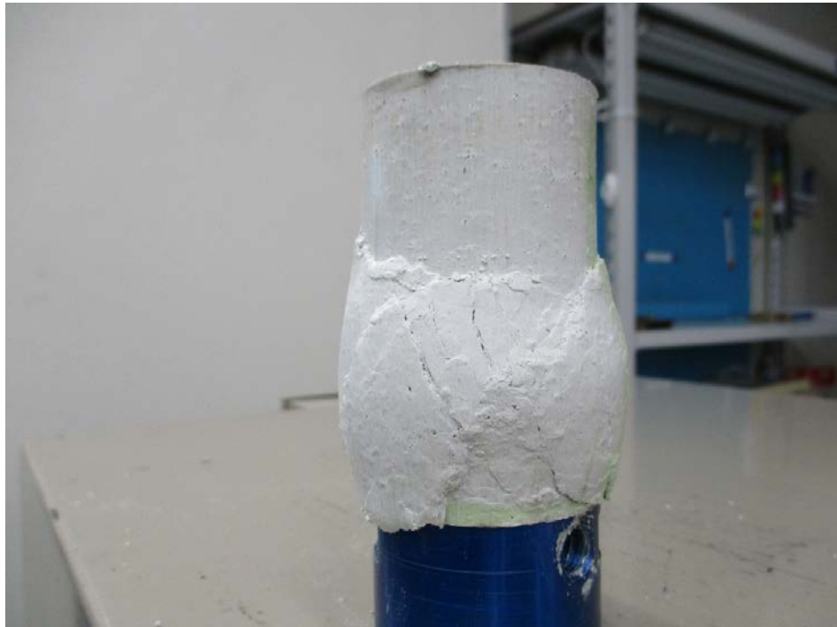
三軸圧縮試験 ( \sigma_c' = 200\text{kPa} ) 後供試体① (乾燥密度 1.6\text{Mg/m}^3 初期含水比 10%)
