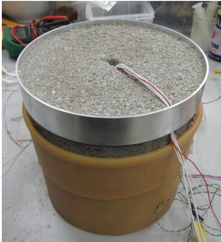
図 4.6.1-36 埋戻し材の設置状況
