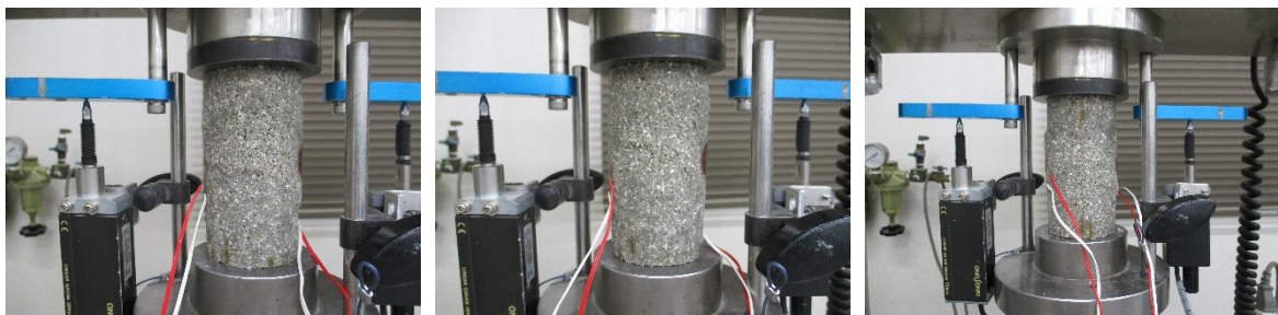
一軸圧縮試験 後供試体①~③（乾燥密度 1.8\text{Mg/m}^3 初期含水比 10%）
