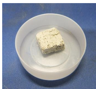
作製した緩衝材供試体(1 辺 15mm×高さ 5mm程度)
