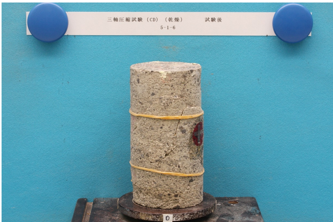
三軸圧縮試験 ( \sigma_c'=3\text{MPa} ) 後供試体⑥
