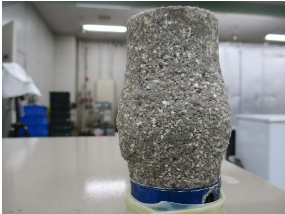
三軸圧縮試験（ \sigma_c' = 200 \text{kPa} ） 後供試体①（乾燥密度 1.8 \text{Mg/m}^3 初期含水比 8%）
