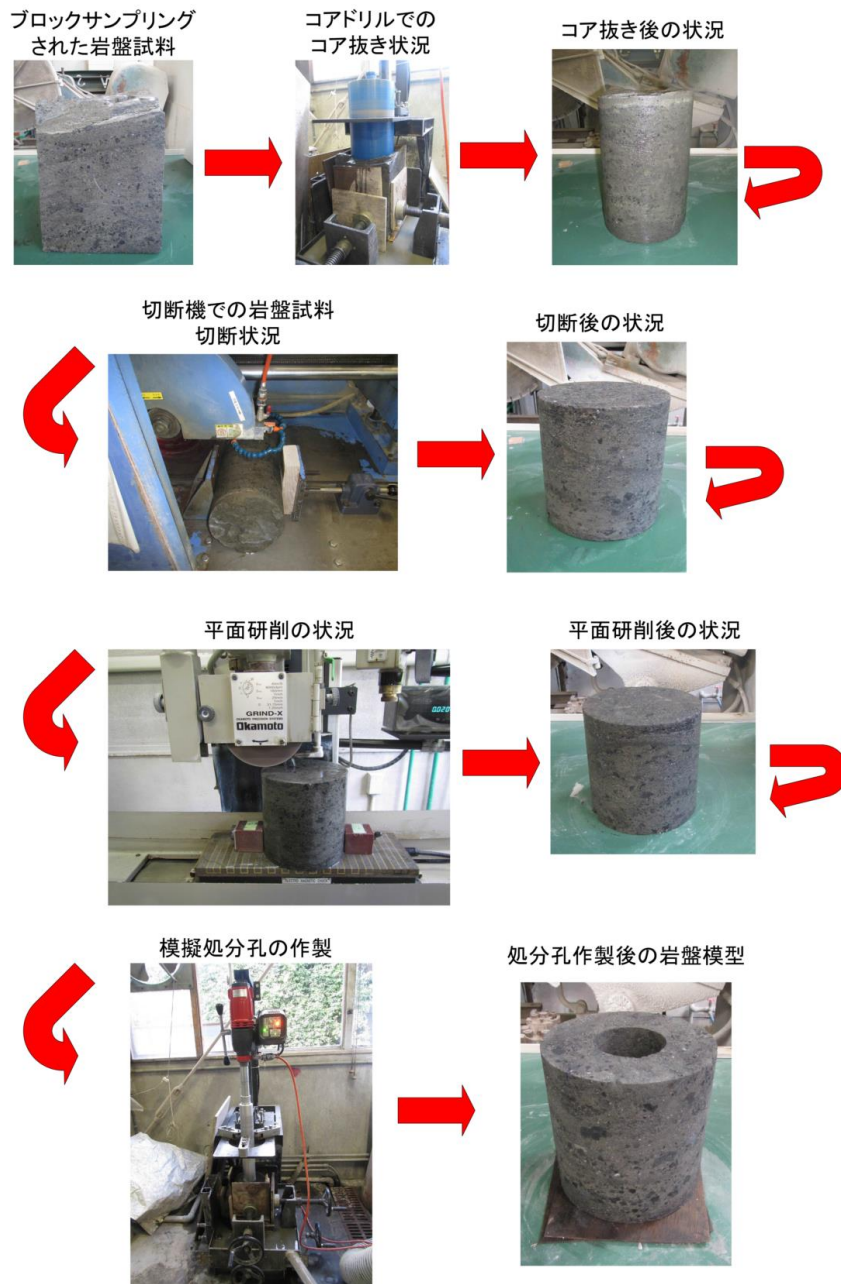
図 4.6.1-7 岩盤試料の整形状況
