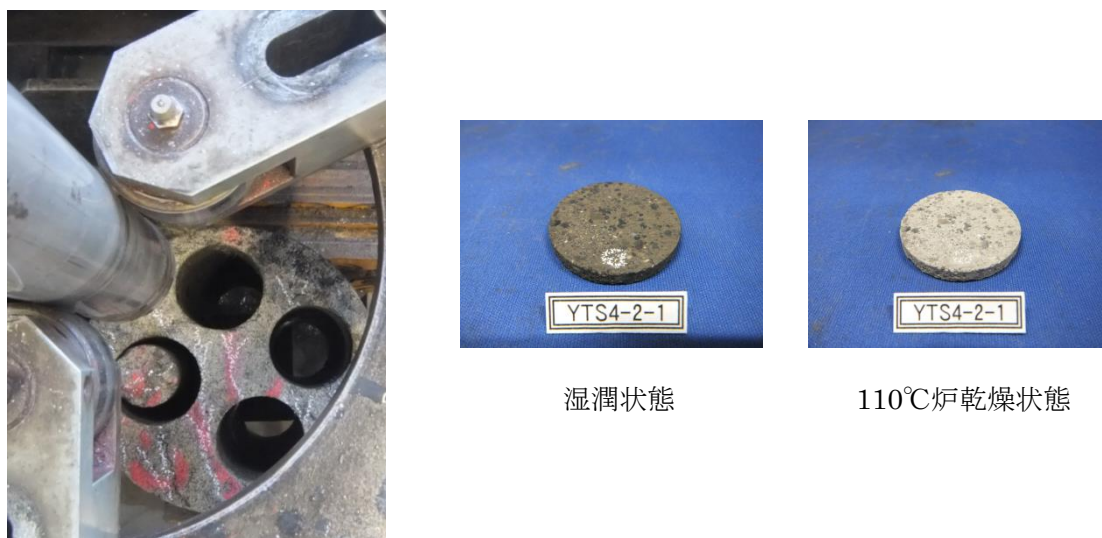
図 3.2.2-30 周辺岩盤供試体（直径 35mm×高さ 4mm 程度）
