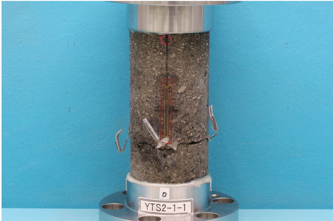
一軸引張り試験 後供試体① (周辺岩盤)
