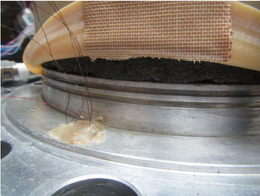
図 4.6.1-41 ひずみゲージのリード線の防水処理状況
