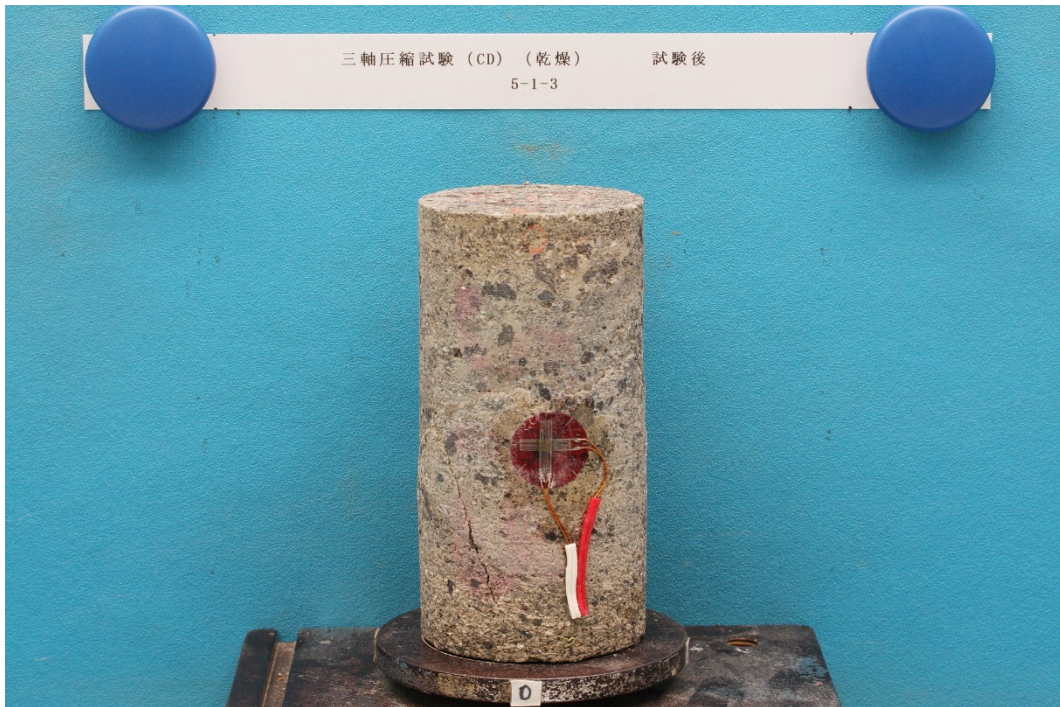
三軸圧縮試験 ( \sigma_c'=1.5\text{MPa} ) 後供試体⑤
