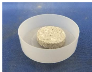
作製した埋戻し材供試体(直径 32mm×高さ 4mm程度)
