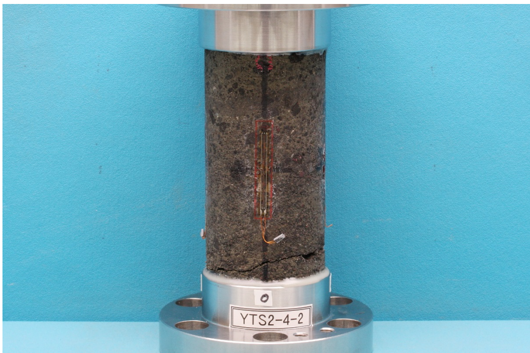
一軸引張り試験 後供試体② (周辺岩盤)
