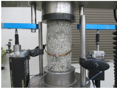
一軸圧縮試験 後供試体⑦~⑨ (乾燥密度 1.8\text{Mg/m}^3 初期含水比 8%)
