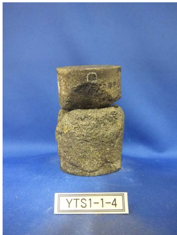
三軸圧縮試験 ( \sigma_c'=1.5\text{MPa} ) 後供試体①
