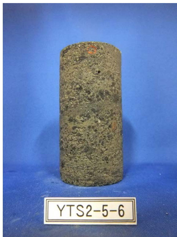
クリープ試験 ( \sigma_c'=0.1\text{MPa} 応力比=0.8) 供試体②
