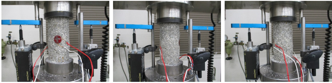
一軸圧縮試験 後供試体①~③（乾燥密度 1.8\text{Mg/m}^3 初期含水比 6%）
