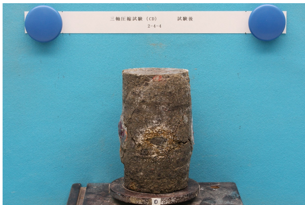
三軸圧縮試験 ( \sigma_c'=3\text{MPa} ) 後供試体②
