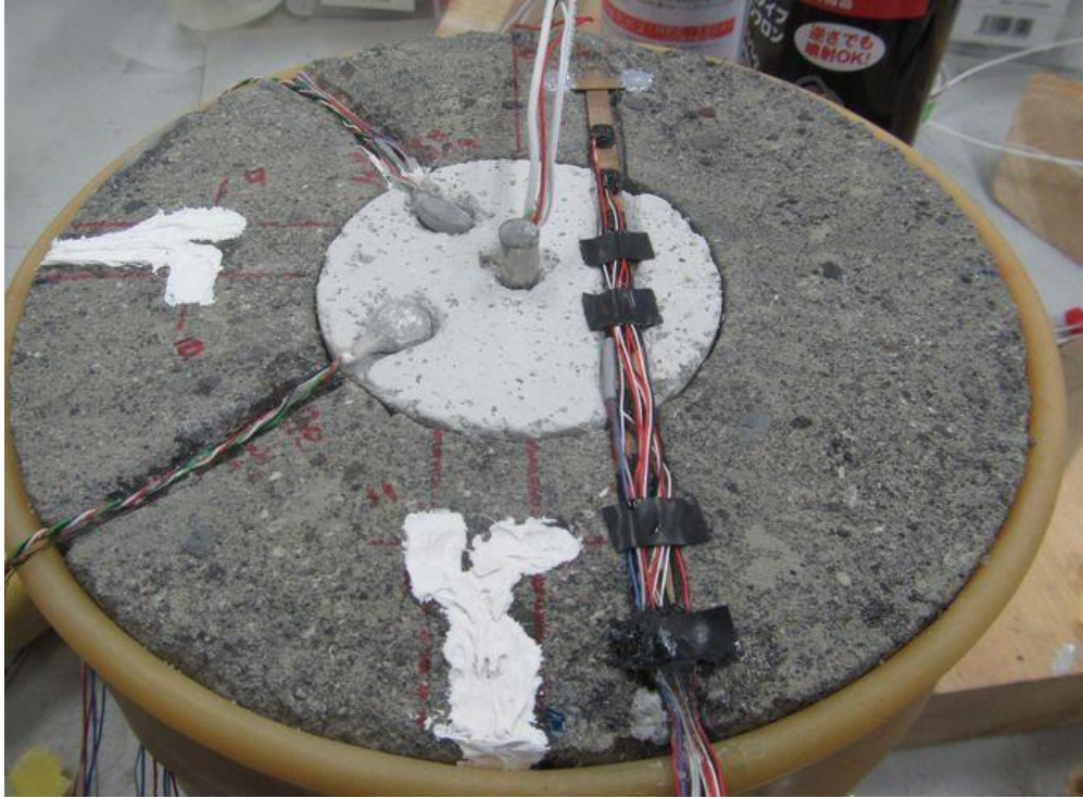
図 4.6.1-35 土圧計および膨出センサー設置状況
