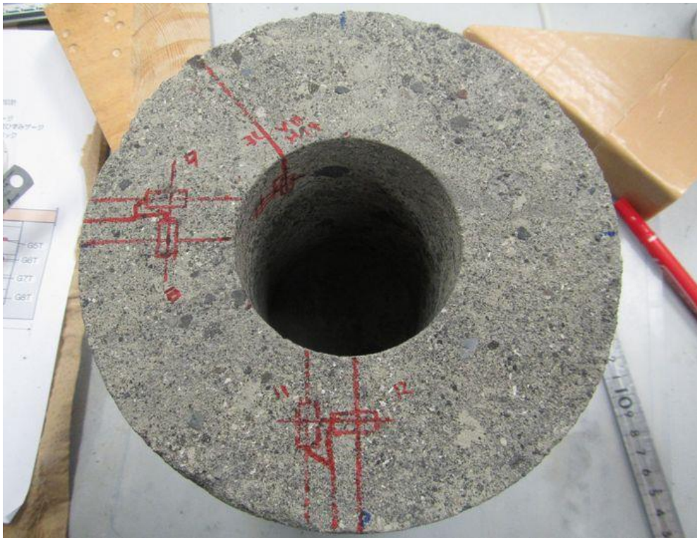
図 4.6.1-20 岩盤供試体へのマーキング状況
