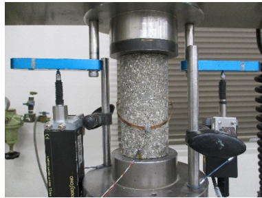
一軸圧縮試験 後供試体⑦~⑨ (乾燥密度 1.8\text{Mg/m}^3 初期含水比 8%)
