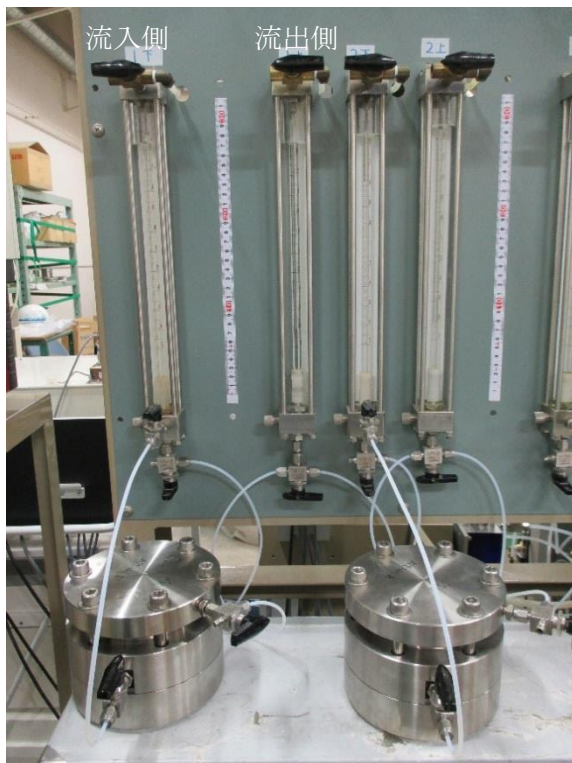
図 3.2.2-8 膨潤圧測定状況 (供試体下部より給水)
