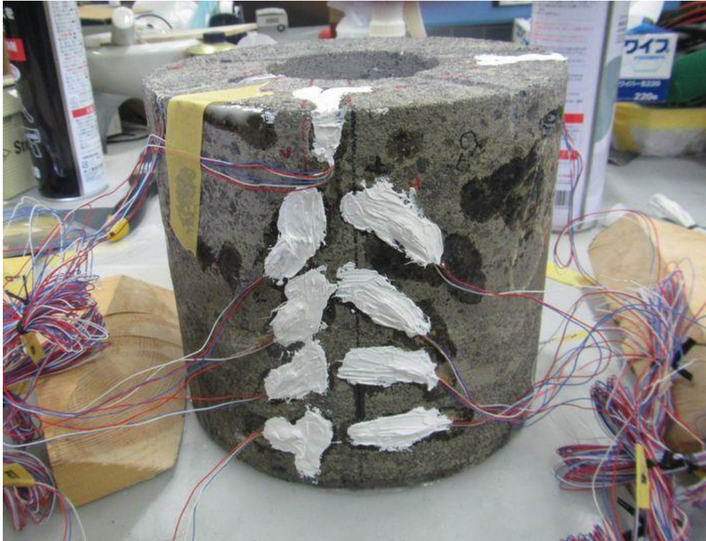
図 4.6.1-25 ひずみゲージ貼付部分へのコーティング状況
