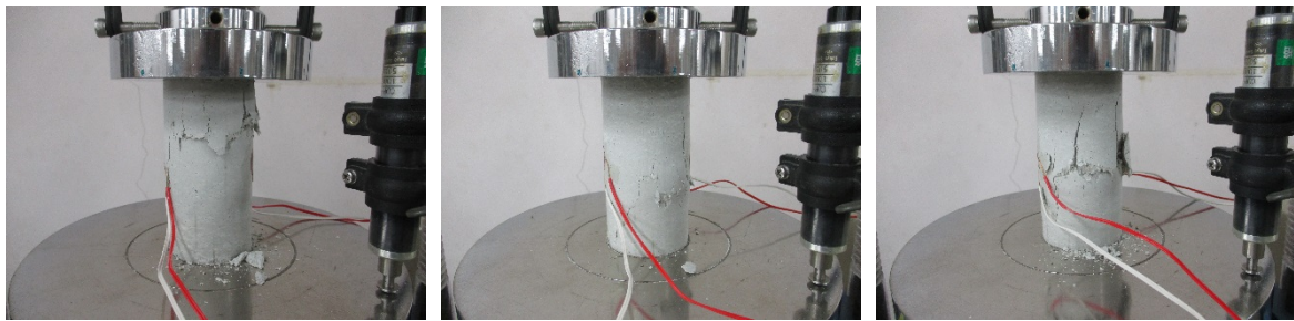
一軸圧縮試験 後供試体①~③ (乾燥密度 1.7\text{Mg/m}^3 初期含水比 10%)
