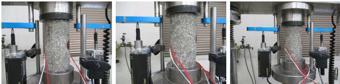
一軸圧縮試験 後供試体①~③（乾燥密度 1.8\text{Mg/m}^3 初期含水比 8%）
