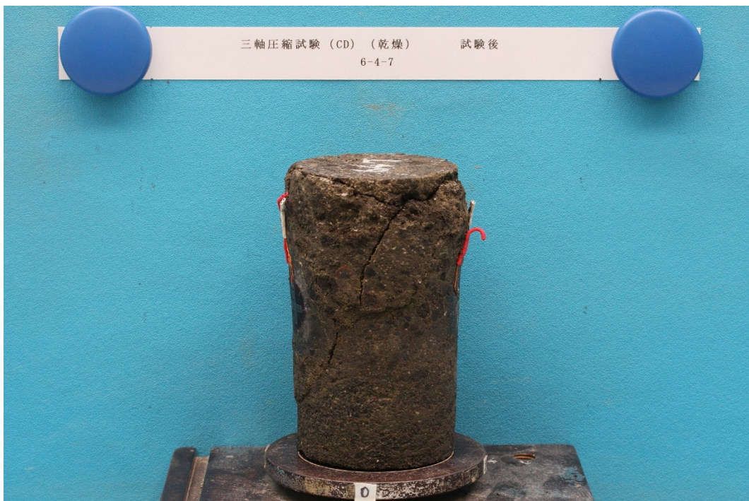
三軸圧縮試験 ( \sigma_c'=7\text{MPa} ) 後供試体⑧
