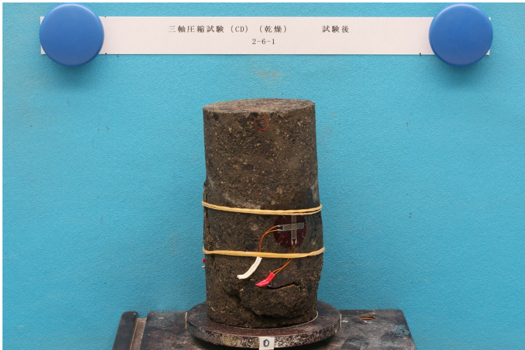
三軸圧縮試験 ( \sigma_c'=5\text{MPa} ) 後供試体⑦
