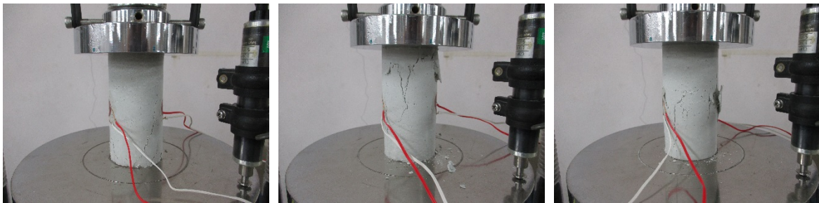
一軸壓縮試験 後供試体①~③（乾燥密度 1.6\text{Mg/m}^3 初期含水比 10%）
