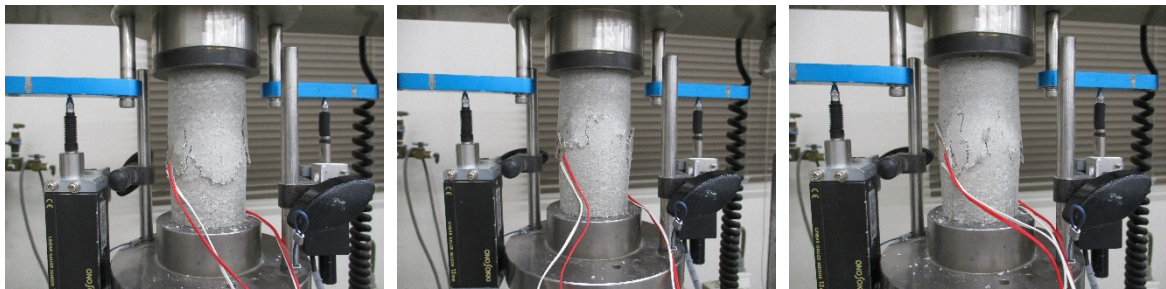
一軸圧縮試験 後供試体①~③ (乾燥密度 1.7\text{Mg/m}^3 初期含水比 15%)
