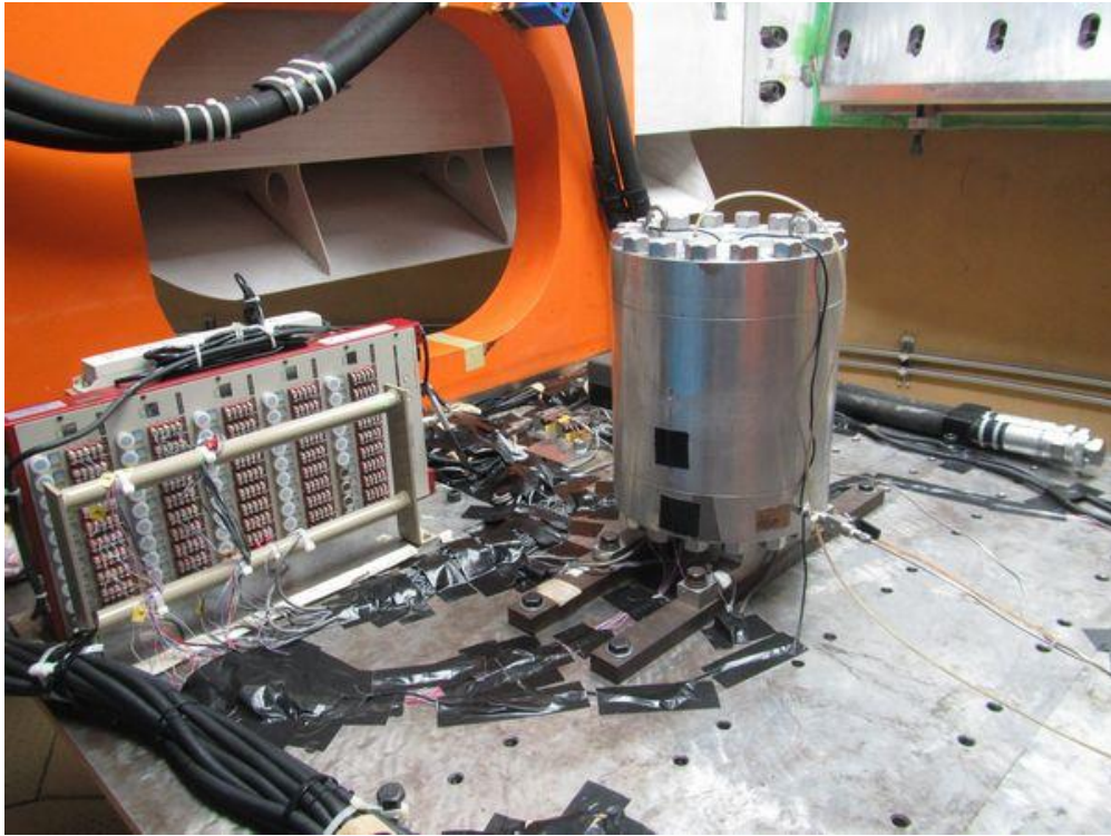
図 4.6.1-45 高速スイッチボックスへの結線状況
