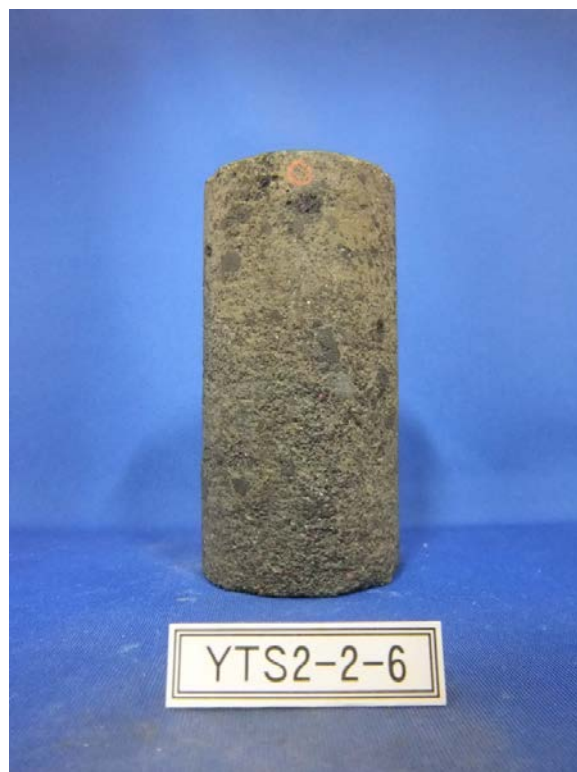
クリープ試験 ( \sigma_c'=0.1\text{MPa} 応力比=0.9) 供試体①
