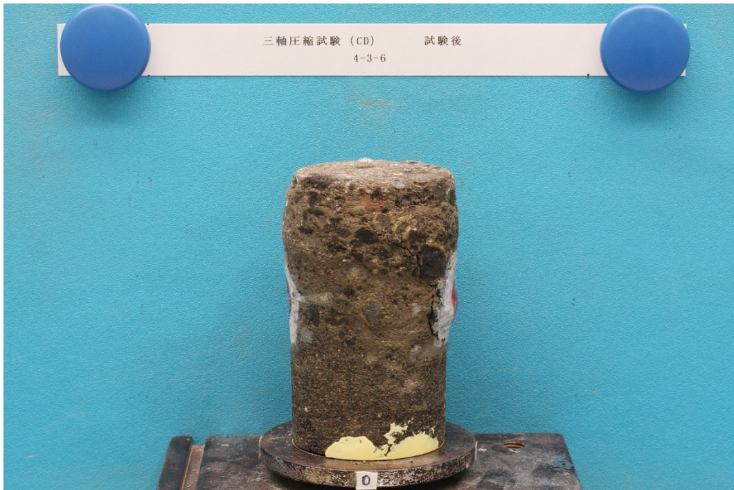
三軸圧縮試験 ( \sigma_c'=5\text{MPa} ) 後供試体③
