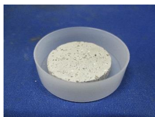
図 3.2.2-29 作製した緩衝材供試体(直径 35mm×高さ 4mm程度)
