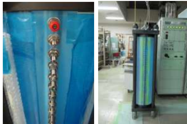
図 3.1.1-3 比抵抗測定用電極の設置
