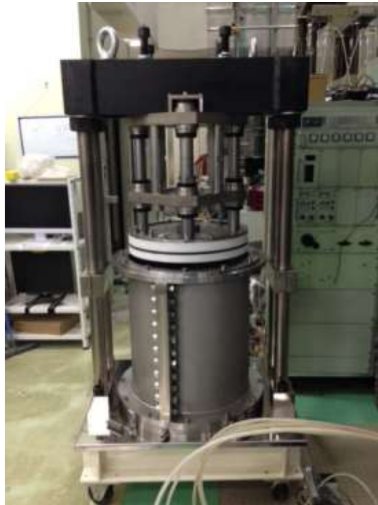
図 3.2.3-18 スラリーの予備圧密試験装置 (Case3)
