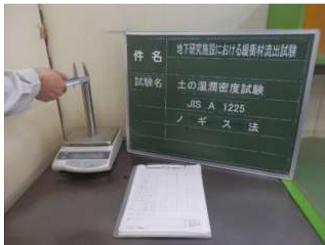
図 5.2.4-16 土質試験実施状況（土の湿潤密度試験）
