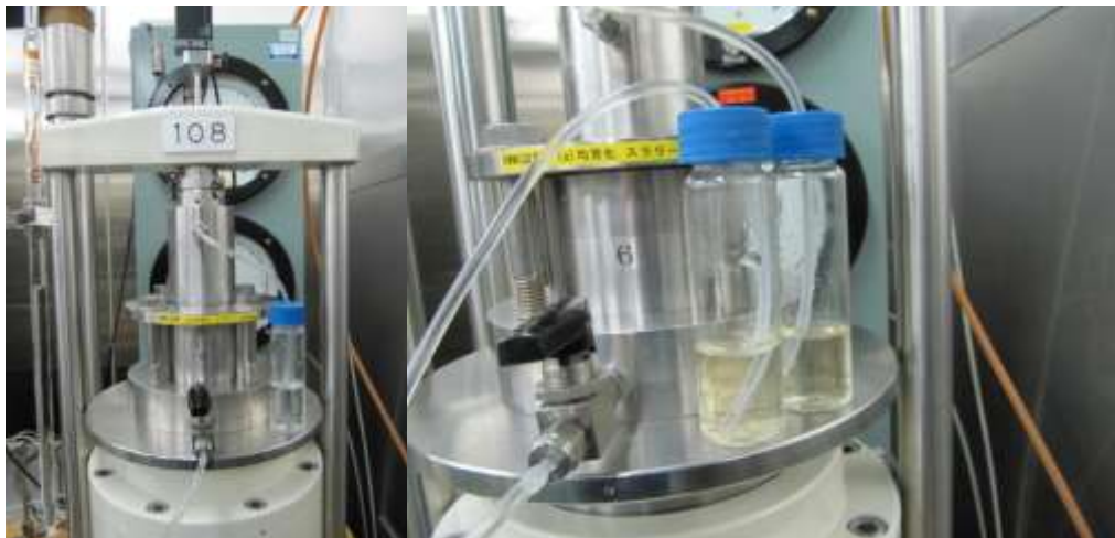
図 3.2.3-17 スラリーの圧密試験装置 (Case2) と採水状況
