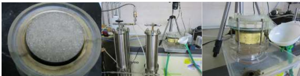
図 5.1.1-5 多孔質材料を用いた緩衝材流出試験状況
