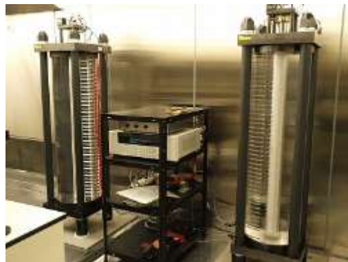
図 3.1.1-4 締固め終了後の試験器
