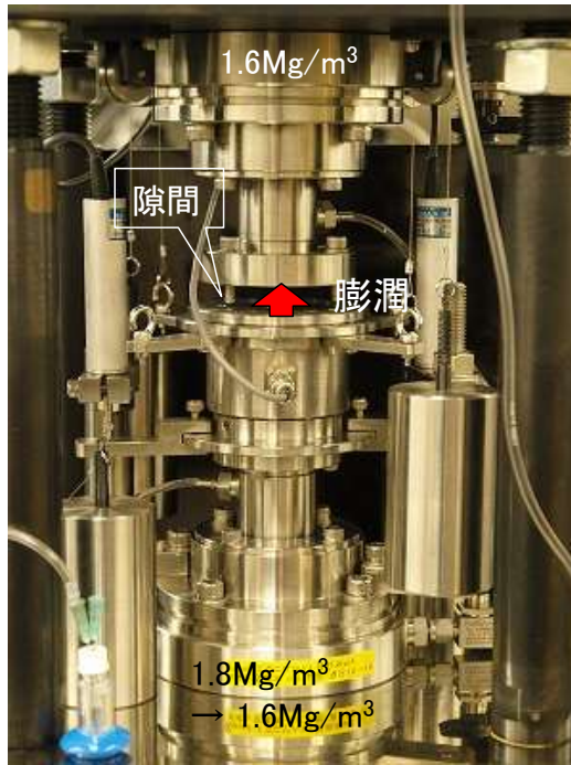
図 3.2.3-2 応力履歴が圧縮ベントナイトの膨潤量に及ぼす影響試験機
