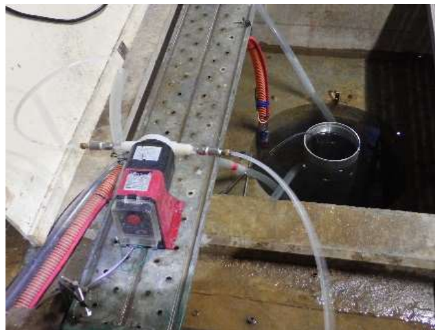
図 5.2.5-8 自動採水装置 マグネットポンプ
