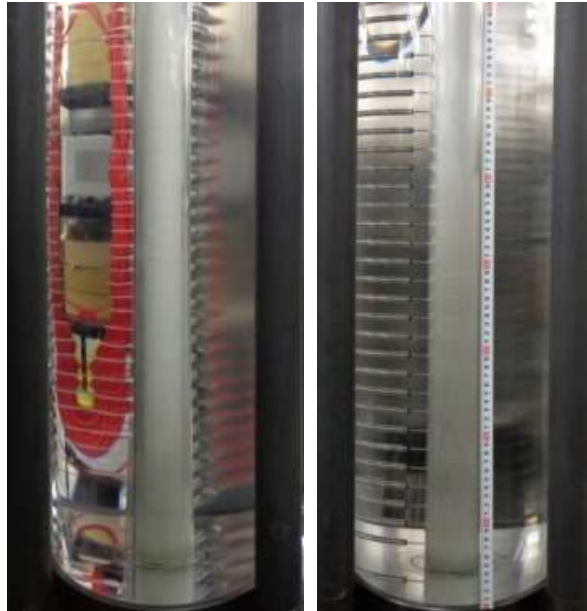
図 3.1.1-5 液体の浸潤状況（左：蒸留水、右：NaCl 水溶液（0.5M））
