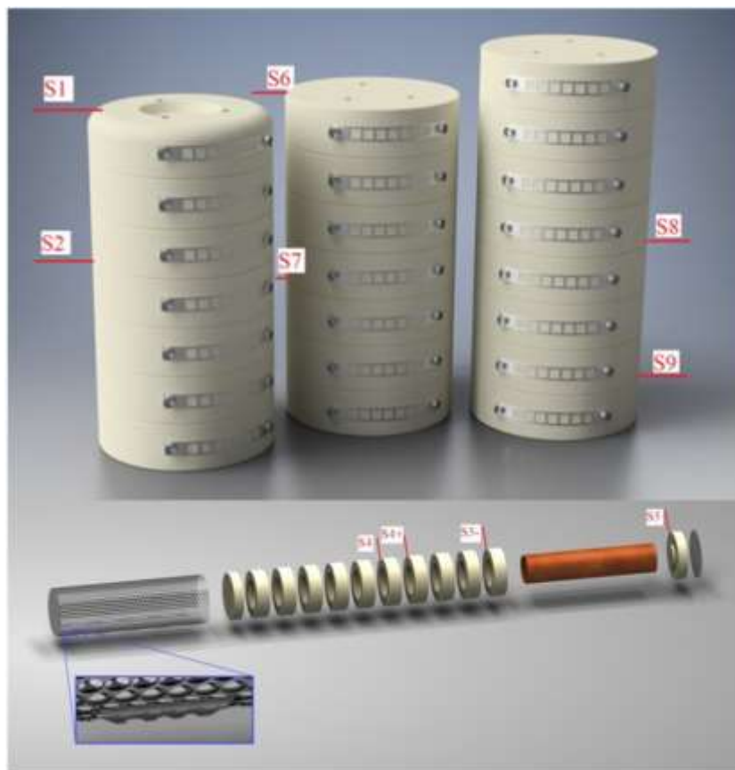
図4-17. A) 計装を備えた区画を伴う多目的試験 (MPT) 間隔ブロック及び過渡ブロック。 B) 計装を備えた区画を伴うMPTスーパーコンテナ。
