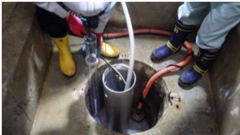
図 5.2.4-5 アクリルサンプラーによるサンプリング状況
