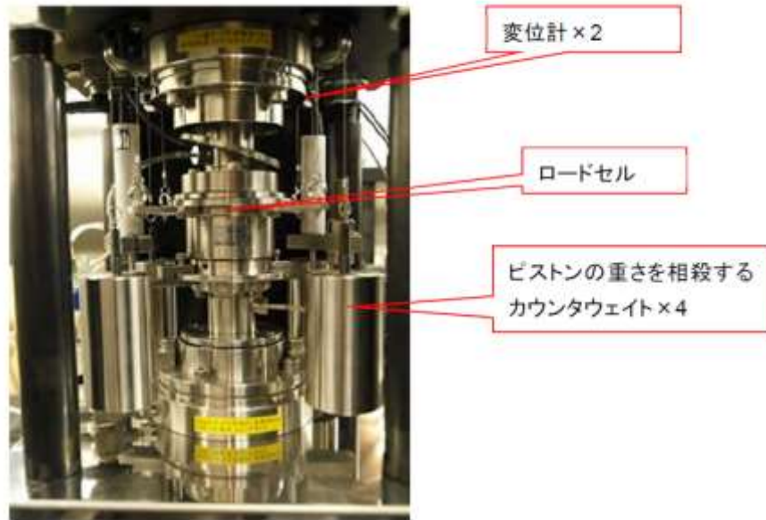
図 6.3.3-2 直列膨潤量試験装置の近影 (再掲)
