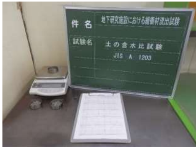
図 5.2.4-15 土質試験実施状況（土の含水比試験）
