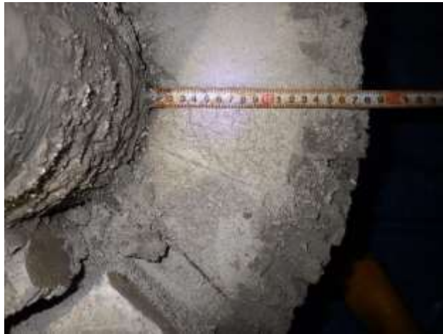
図 5.2.5-14 試験体下段の浸潤状況
