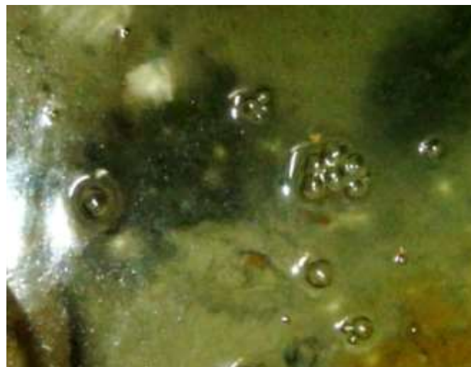
図 5.2.4-4 試験体上面からのガスの湧出
