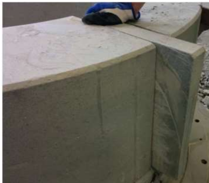
図4-26. スーパーコンテナ・リングの1つのサンプリングの様子。リング内の含水率の再分布の測定のため、ベントナイトの薄片が切り取られた後、より小さな断片に分けられた。
