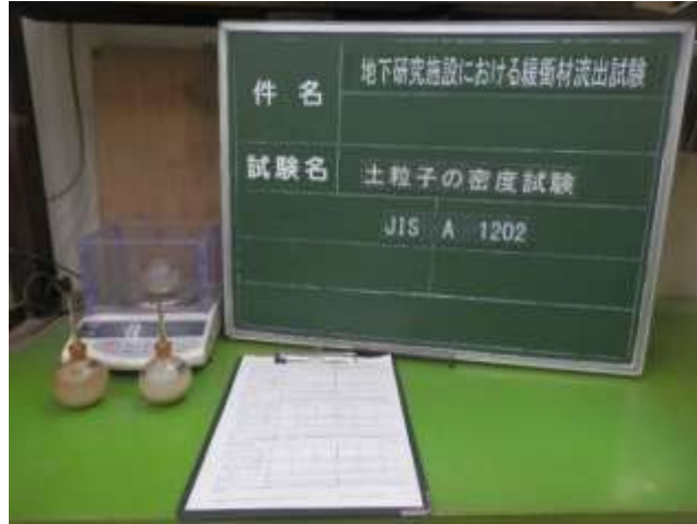
図 5.2.4-14 土質試験実施状況（土粒子の密度試験）
