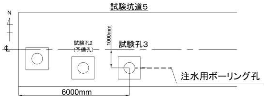
図 5.2.2-1 試験坑道5における試験孔
