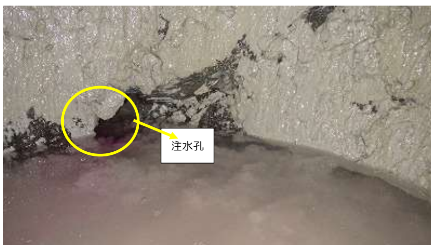
図 5.2.7-8 試験体回収後の試験孔の壁面（拡大）
