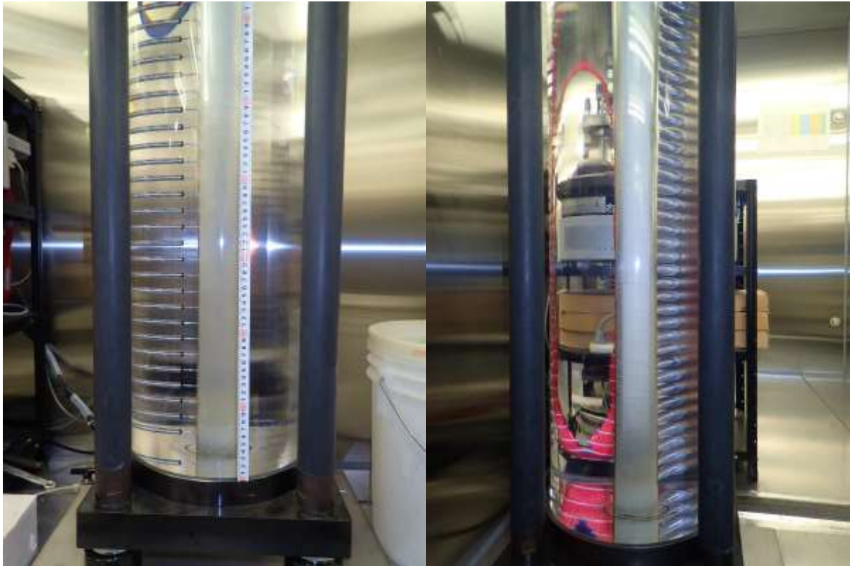
図 3.1.1-8 加圧後の浸潤状況（左：蒸留水、右：NaCl 水溶液（0.5M））
