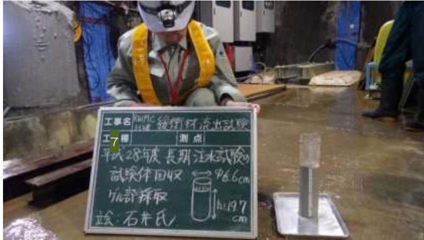
図 5.2.4-10 ゲル部サンプルの寸法確認
