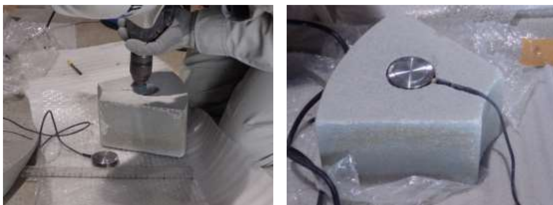
図 5.2.5-3 緩衝材ブロック加工状況（左）／加工完了（右）
