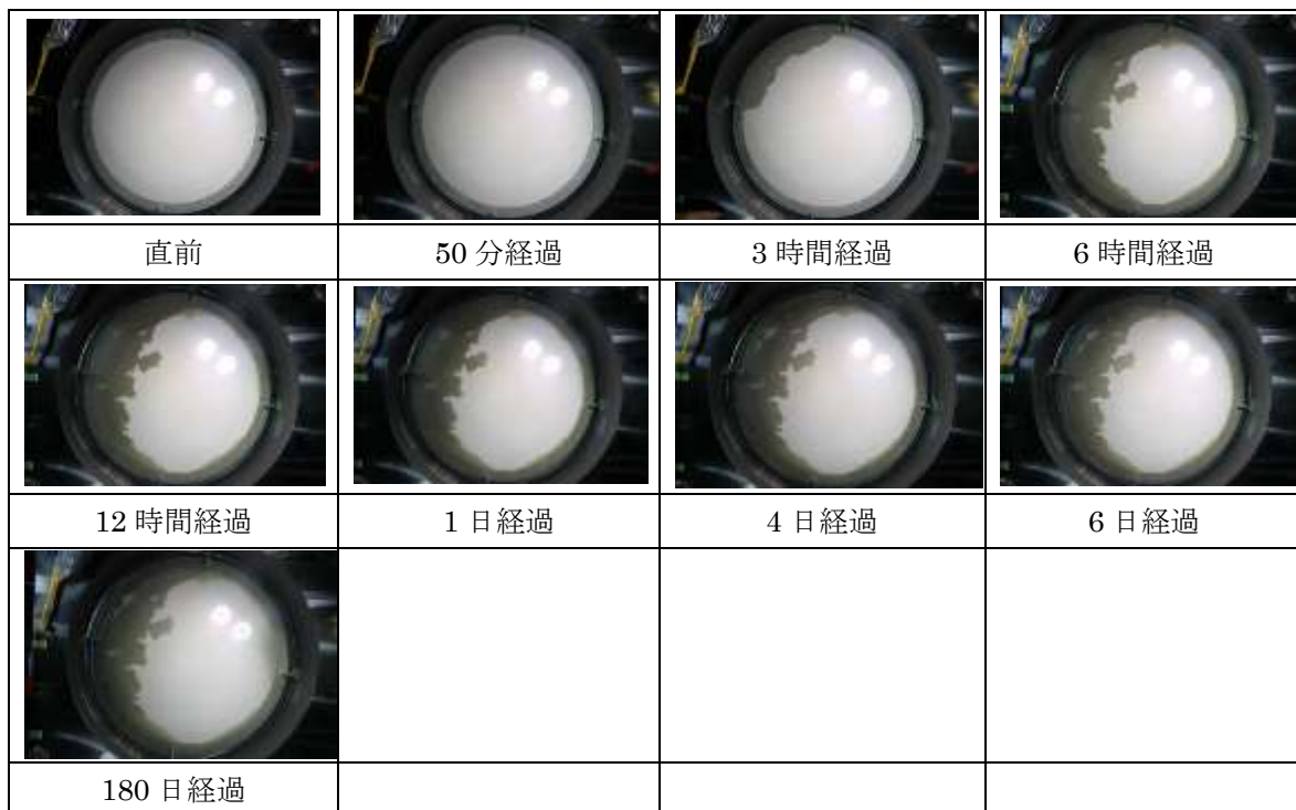
図 5.1.4-5 工学規模パイピング・エロージョン試験状況 (上面)
