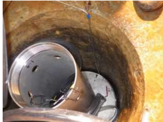
図 5.2.5-7 保護管に通した中部土圧計 (左) / ケース 1 の設置位置 (右)
