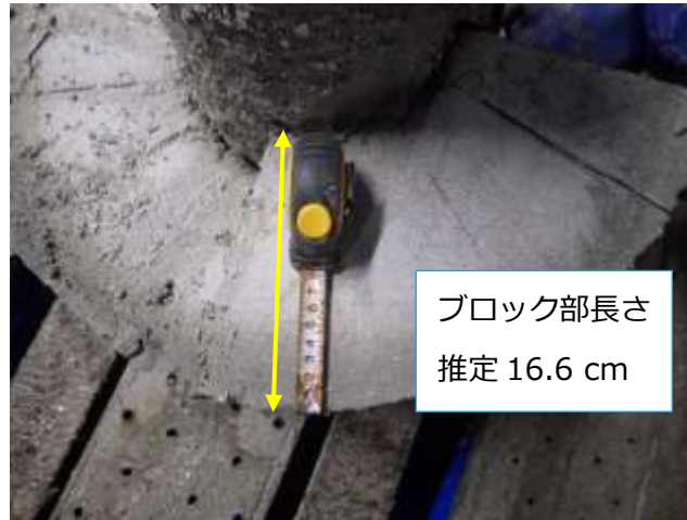
図 5.2.6-8 緩衝材の状態（下から3段目）
