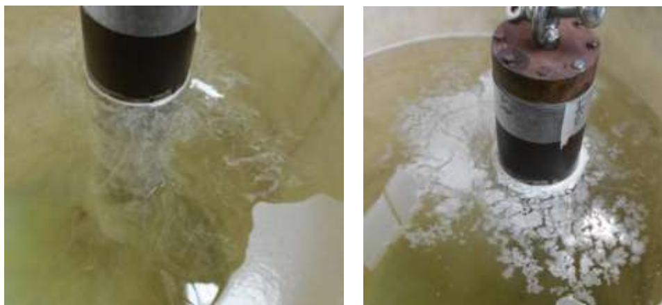
図 3.3.4-19 脱錆工程（左：浸漬直後、右：浸漬 3 分後）
