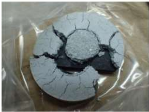
添付図 4-3-7 FW-MAG-10 (M5104)の回収状況
