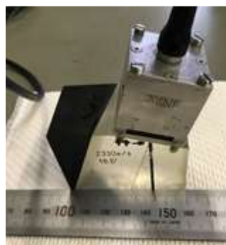
(c)0.5mm ピッチ 32ch リニアアレイプローブ
