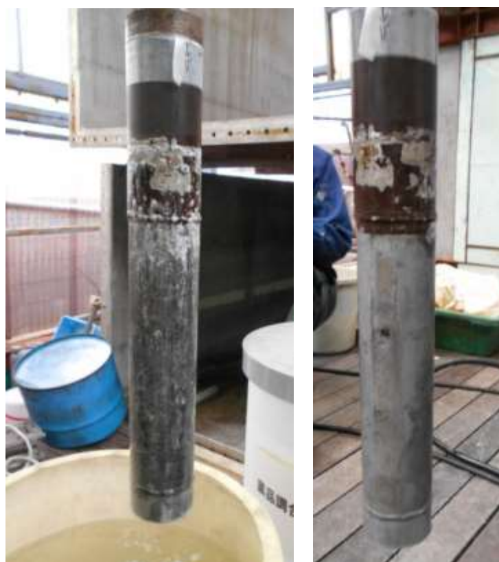
図 3.3.4-20 脱錆工程終了時（浸漬 5 分後）
