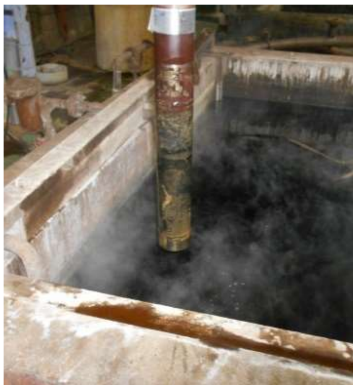
図 3.3.4-18 クールミン K-100 による脱脂作業
