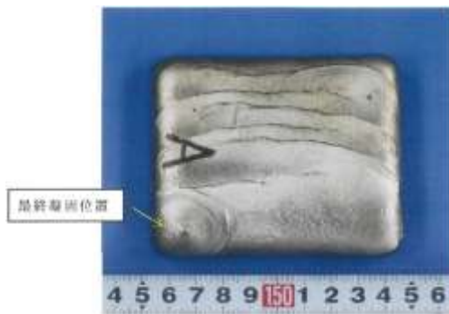
図 7.3.1-1 溶製後の炭素鋼 (0.5wt%Cu)
