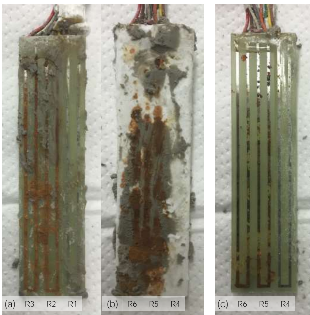
図 3.5.4-4 試験終了後の試料。(a) R1-3 (b) R4-6(フィルタ紙被覆)(c)R4-6 (フィルタ紙除去)
