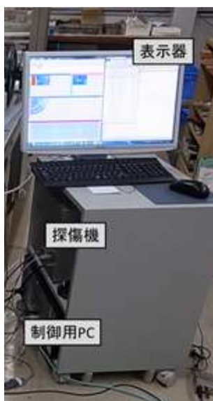
(a)探傷機および制御用 PC
