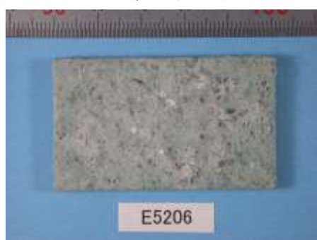
(c) 真空乾燥後の緩衝材が付着した試験片
