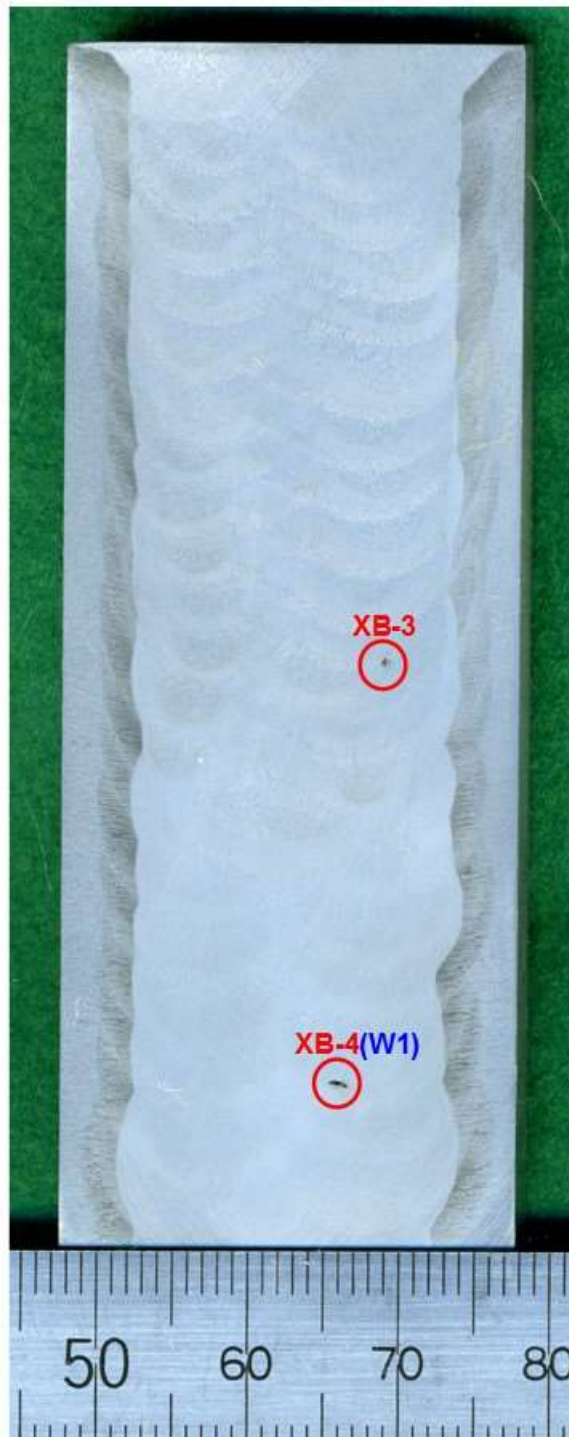
添付図 8-1-72 断面観察番号 B-3、B-4 の断面マクロ写真
