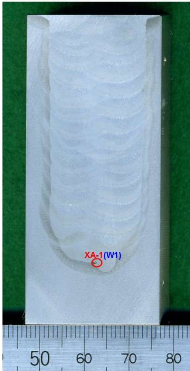
添付図 8-1-60 断面観察番号 A-1 の断面マクロ写真
