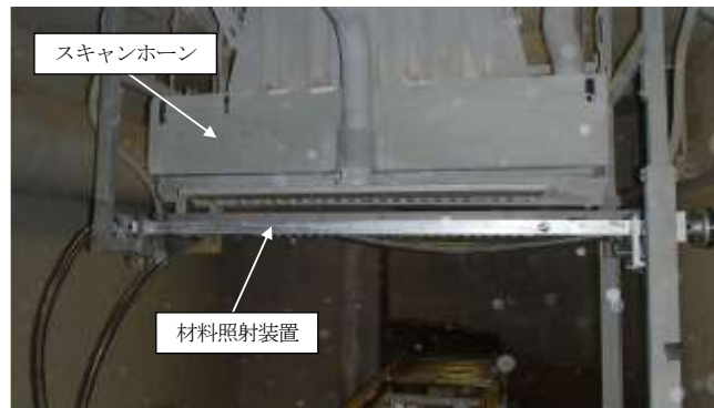
図 7.3.2-4 照射試験用治具のスキューンホーンへの取付け状況
