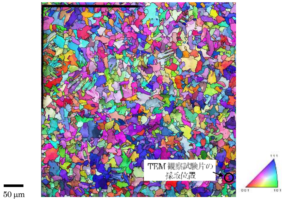
(b) 炭素鋼 (0.5%Cu)、90°C、1 dpa 照射材
