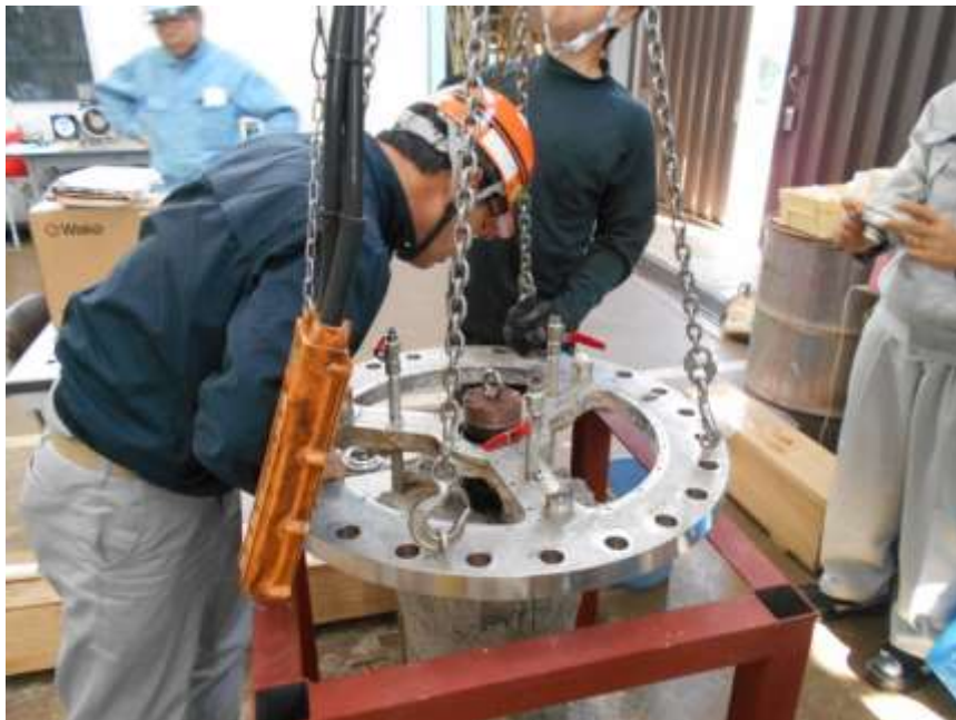
図 3.3.4-8 蓋部の取外し作業
