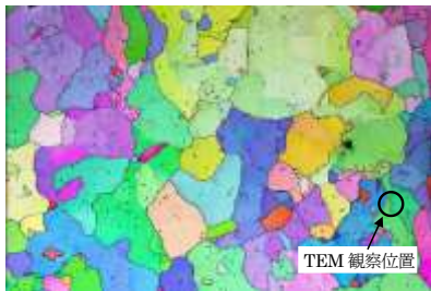
(a) 炭素鋼 (0.5%Cu)、90°C、0.01 dpa、 電子線照射材
