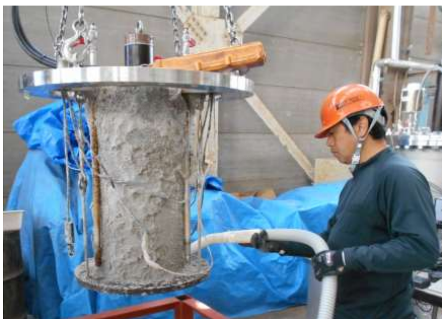
図 3.3.4-6 底板上のケイ砂の除去作業
