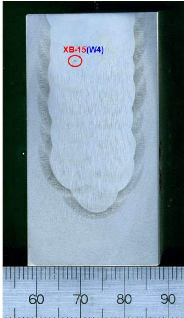
添付図 8-1-79 断面観察番号 B-15 の断面マクロ写真
