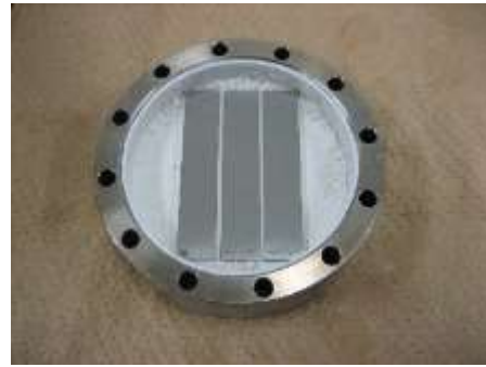
(b) 緩衝材の半量を圧縮後、水素分析用試験片を設置
