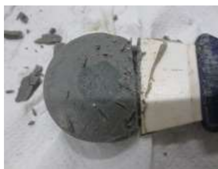
(b) 外周の緩衝材の除去
