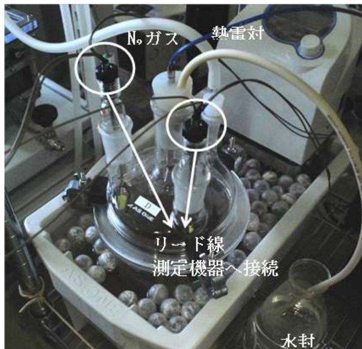
図 3.5.5-10 試験セル外観
