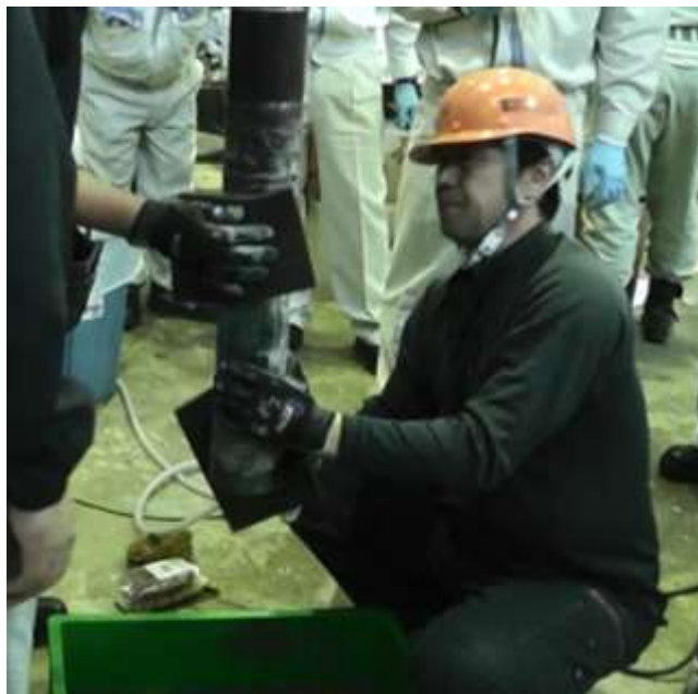
図 3.3.4-14 スコッチブライトによる洗浄作業
