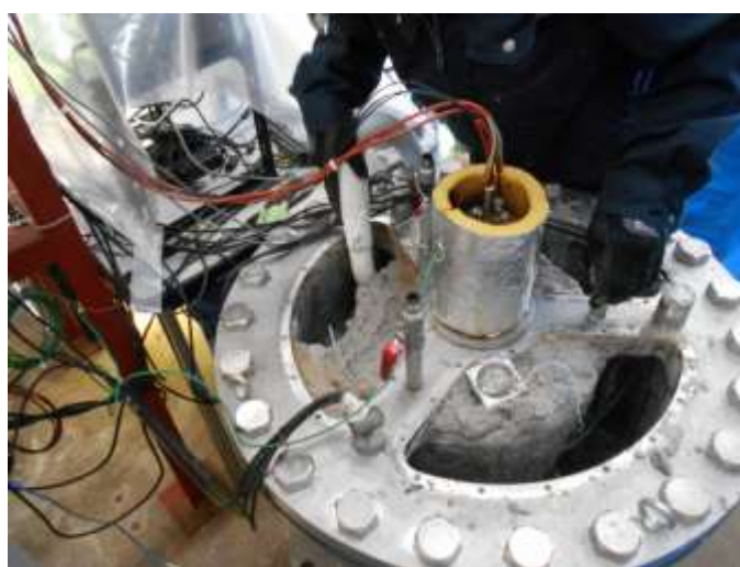
図 3.3.4-2 珪砂+模擬地下水除去による縁切り作業
