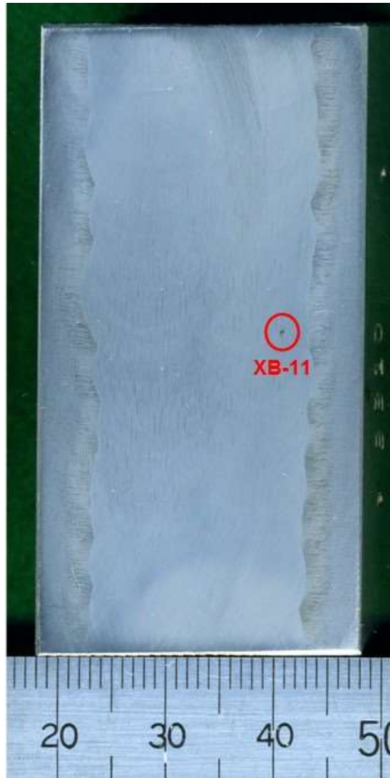
添付図 8-1-76 断面観察番号 B-11 の断面マクロ写真
