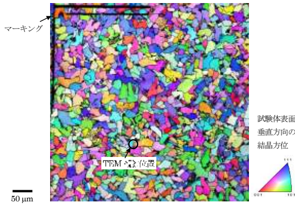
(a) 炭素鋼 (0.5%Cu)、90°C、0.01 dpa、 電子線照射材
