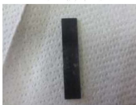
(d) 冷却回収した水素分析用試験片
