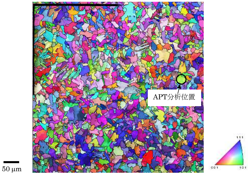
図 7.3.1-14 EBSD 測定結果 (炭素鋼、1 dpa)
