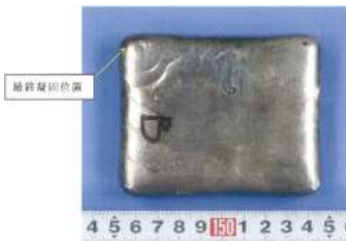
図 7.3.1-3 溶製後の FeMnSiCu 合金
