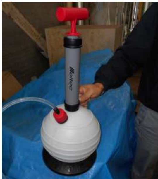
図 3.3.4-3 オイルポンプ外観 (Meltec 製 手動式オイルチェンジャー OC-060)
