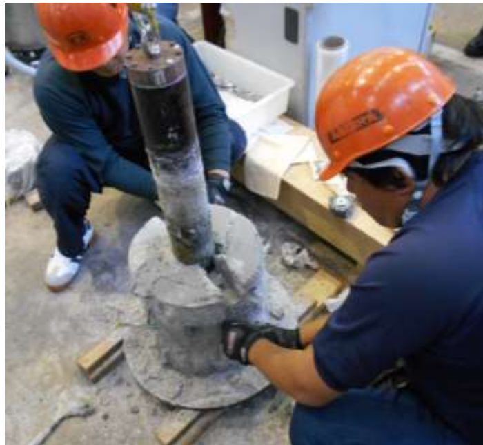
図 3.3.4-10 緩衝材ブロック除去作業
