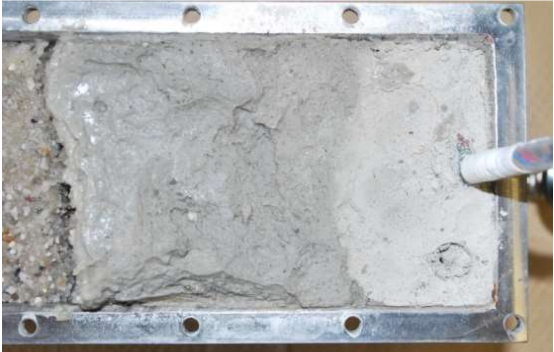
図 3.5.5-33 試験終了時のベントナイトの様子(2回目)
