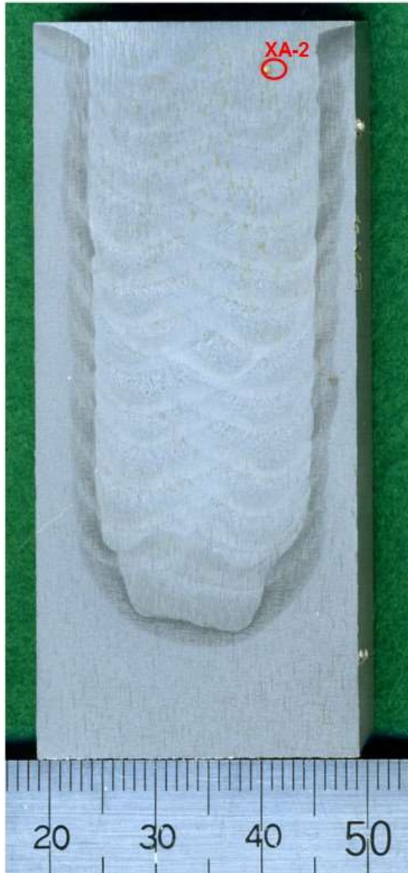
添付図 8-1-61 断面観察番号 A-2 の断面マクロ写真
