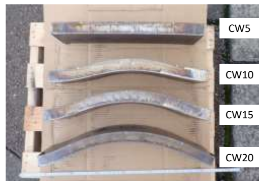
図 7.4.1-2 圧延後の板材の外観
