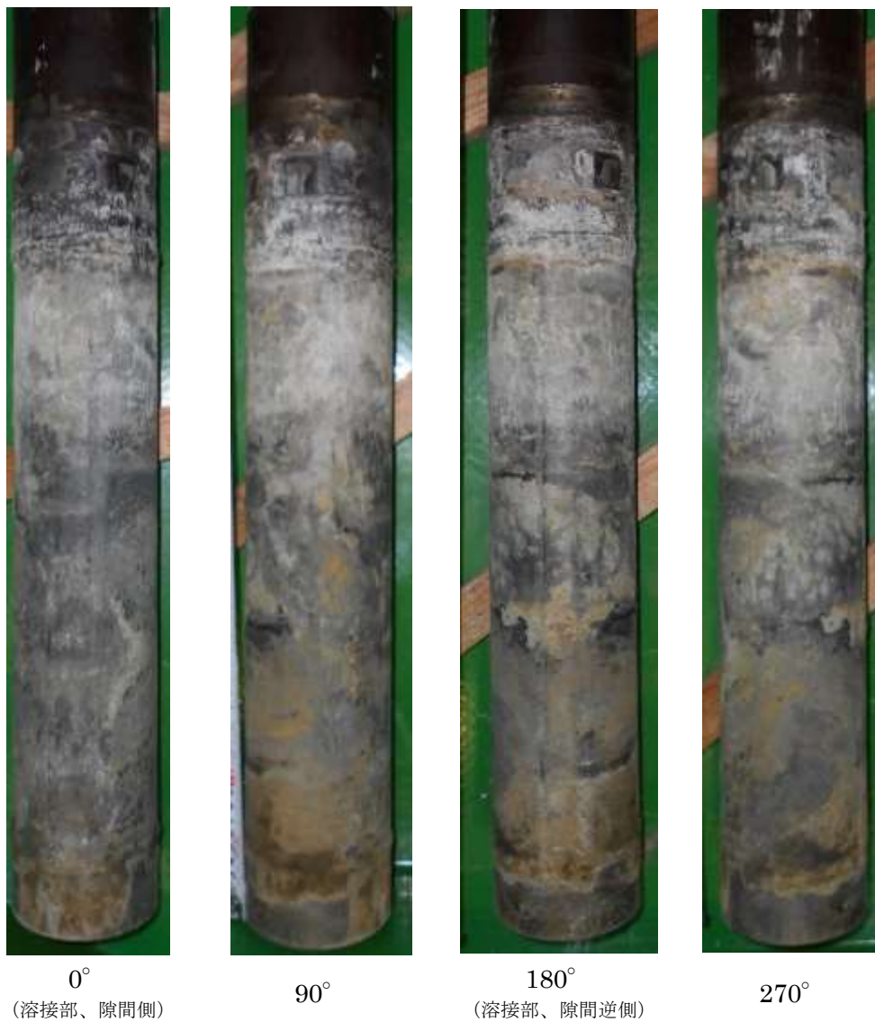
図 3.3.4-13 緩衝材ブロック撤去後の模擬オーバーパック
