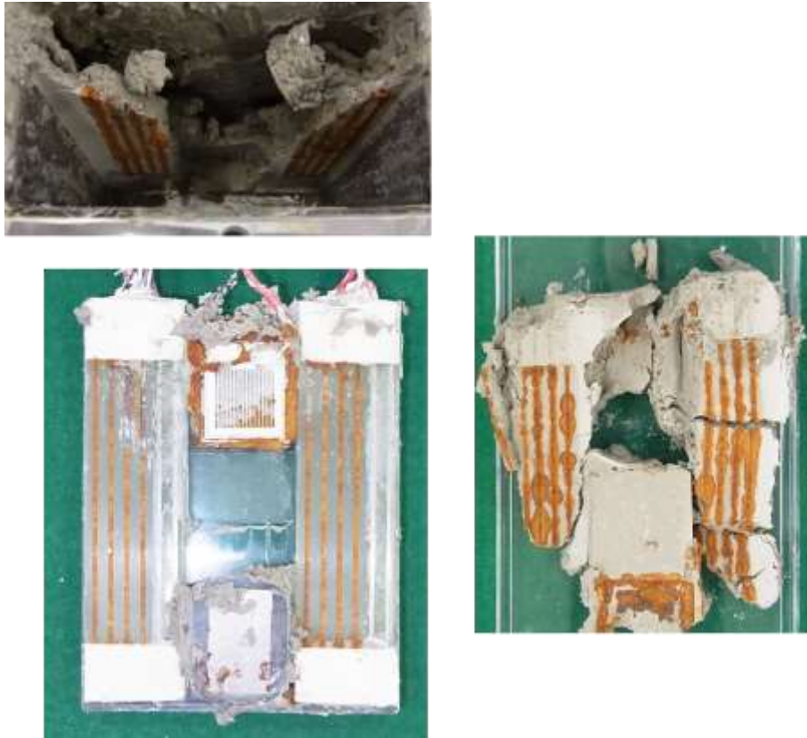
図 3.5.5-43 ポテンシャルドロップ法の測定後の薄膜センサー、ベントナイト
