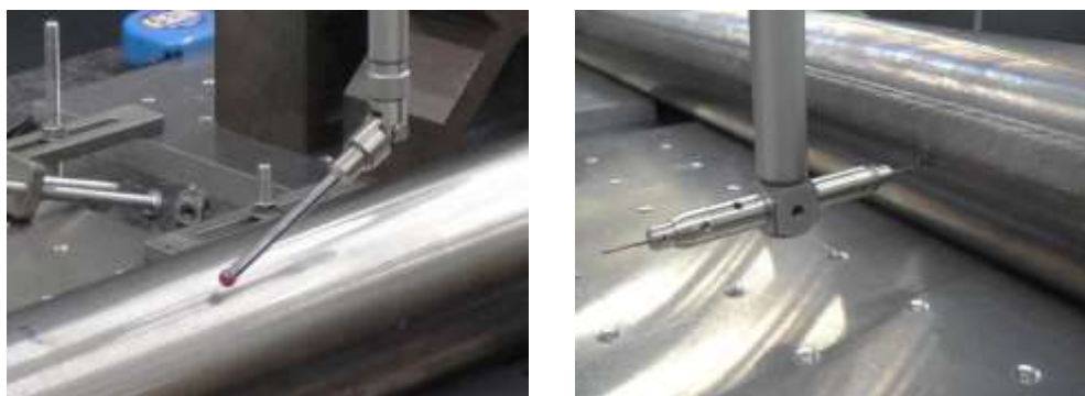
図 3.3.5-4 接触式による3次元計測の様子 (φ8mmプローブ(左)・φ1.5mmプローブ(右))
