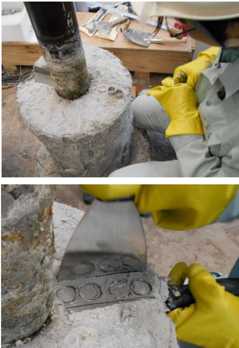
図 3.3.4-11 緩衝材ブロック採取作業 (上：サンプラーの設置、下：採取作業)
