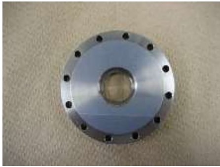
(a) 蓋内側をテフロンテープでマスキング
