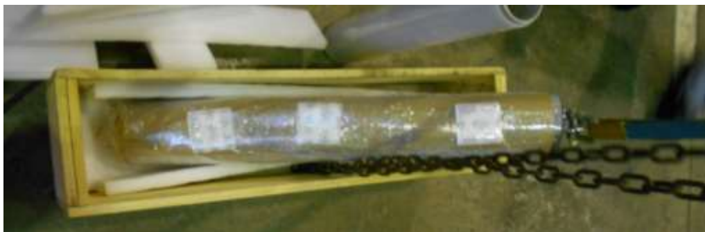
図 3.3.4-17 防錆処理後模擬オーバーパックの梱包作業
