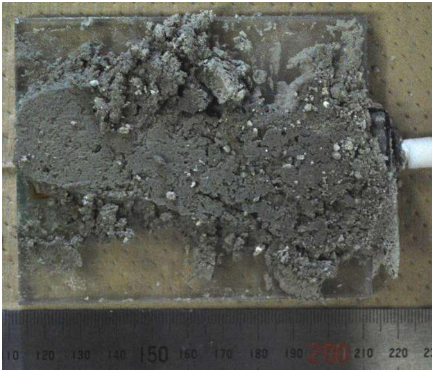
図 3.5.5-34 センサー周囲のベントナイト(2回目)
