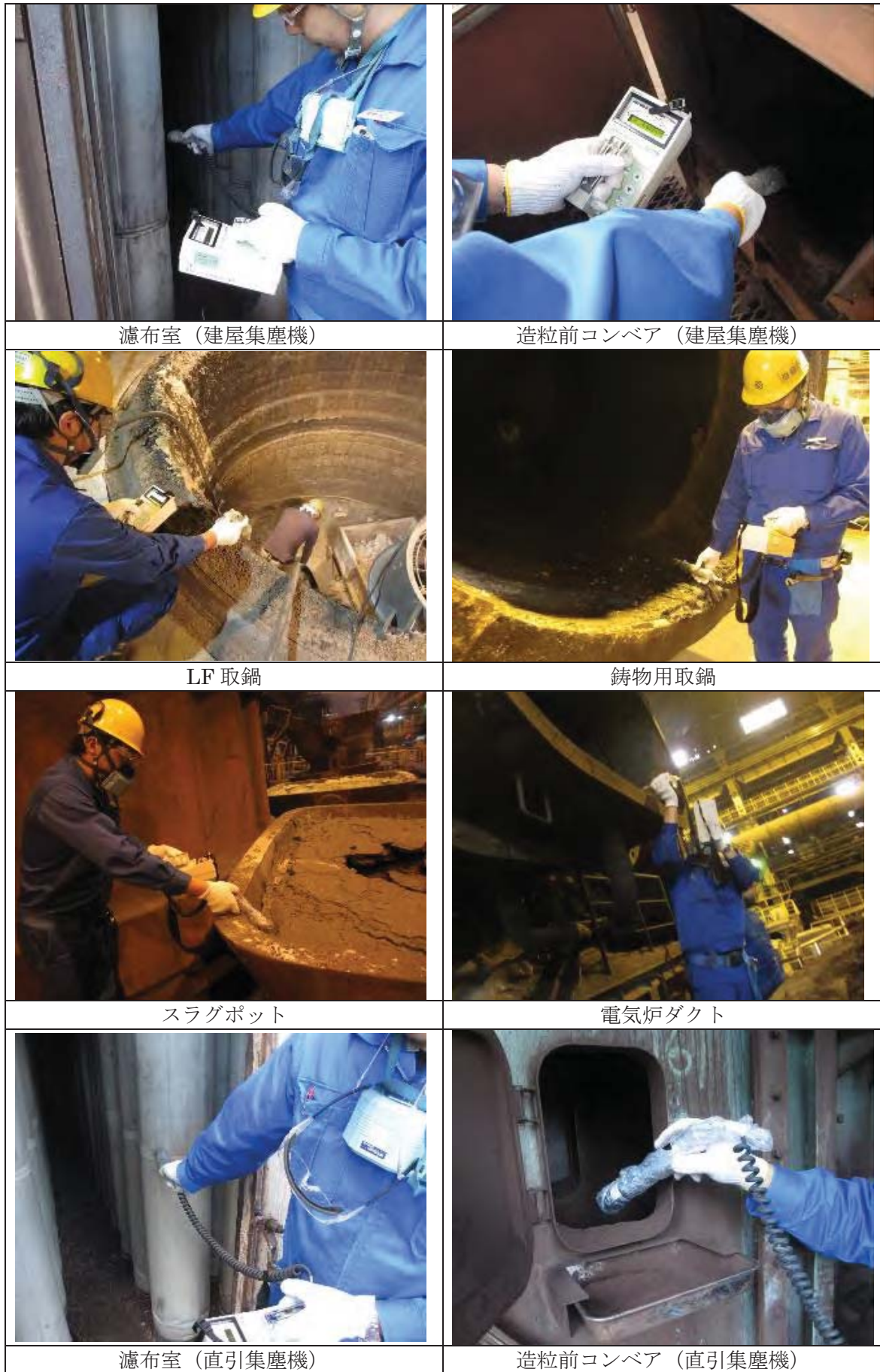
図 4.2.4-2 クリアランス金属使用後の放射線測定の様子（設備：製鋼工場）
