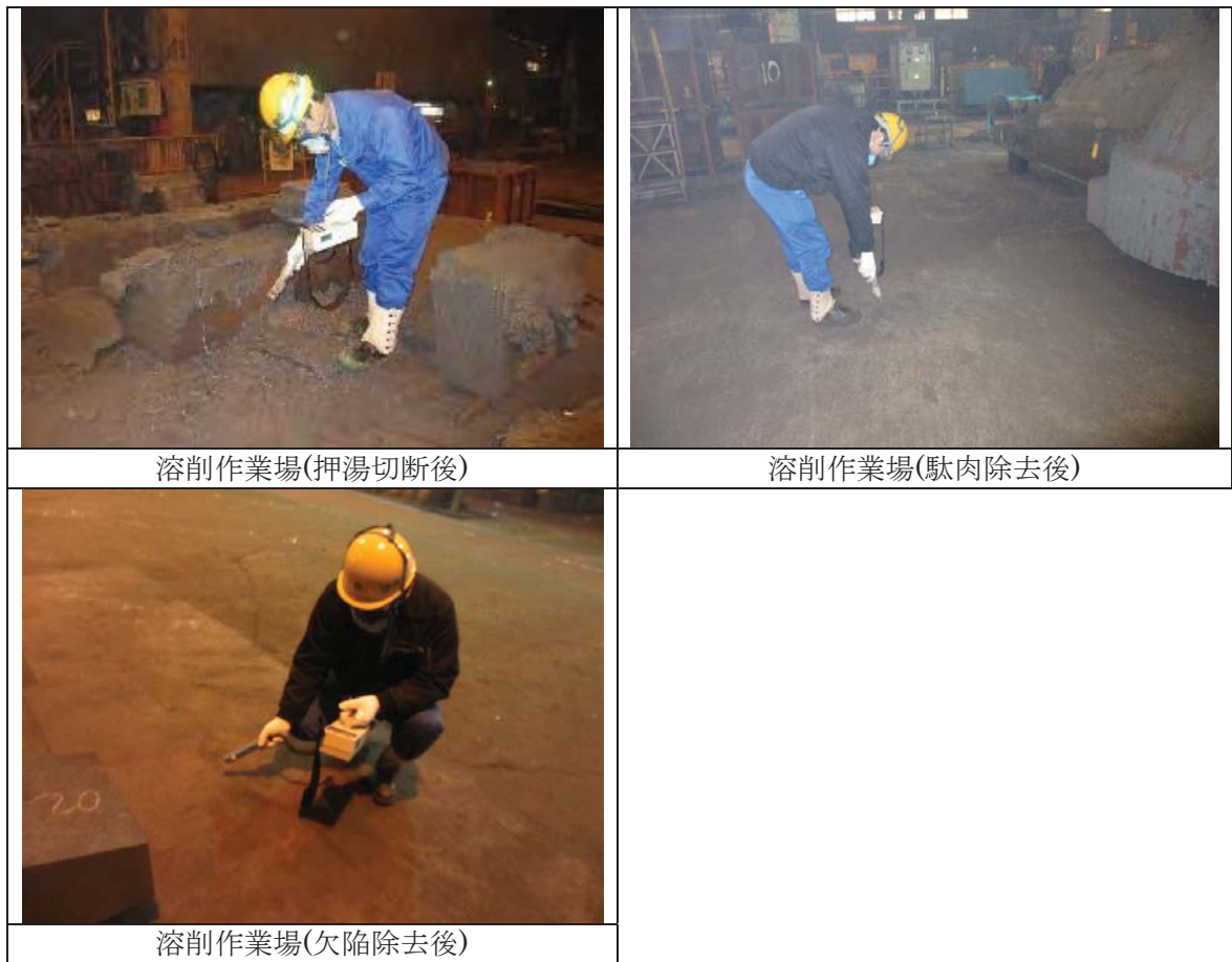
図 4.2.4-3 クリアランス金属使用後の放射線測定の様子（設備：鋳造工場）
