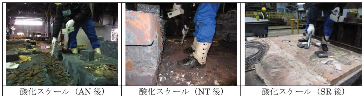
図 4.2.4-9 クリアランス金属使用後の放射線測定の様子 (発生物：熱処理工場)
