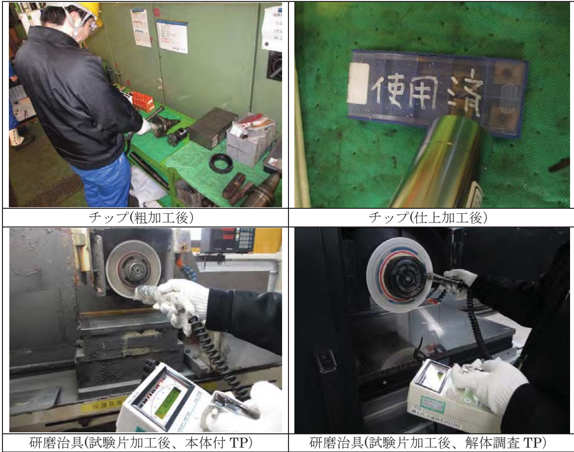
図 4.2.4-11 クリアランス金属使用後の放射線測定の様子（発生物：機械工場）
