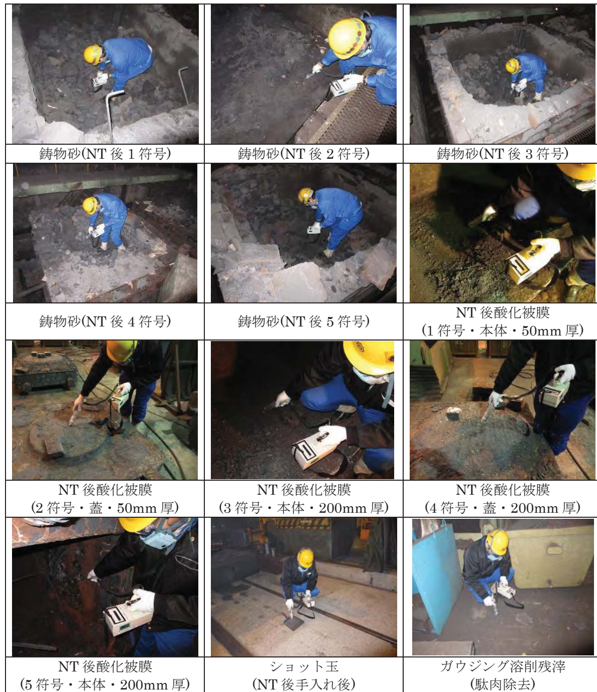
図 4.2.4-10 クリアランス金属使用後の放射線測定の様子 (発生物：鋳造工場)
