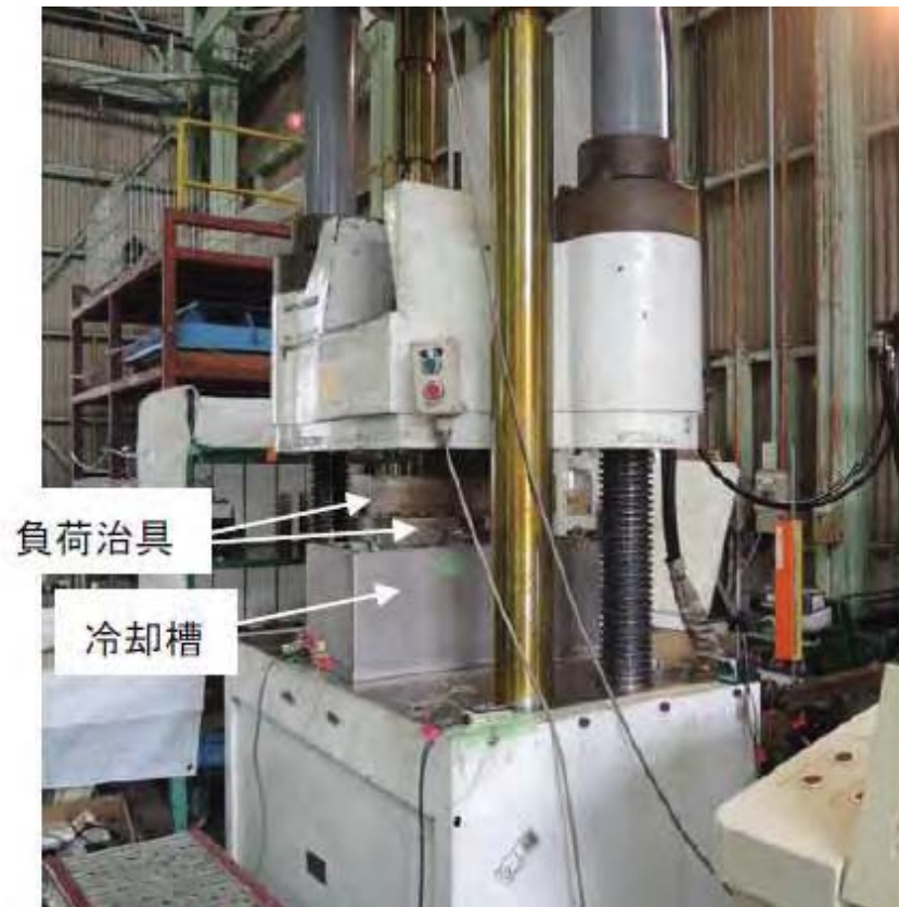
図 3.2.2-13 静的破壊靱性試験の試験要領
