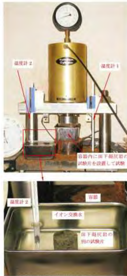
図 3.3.7-2 空圧式クリープ試験機の写真[27]
