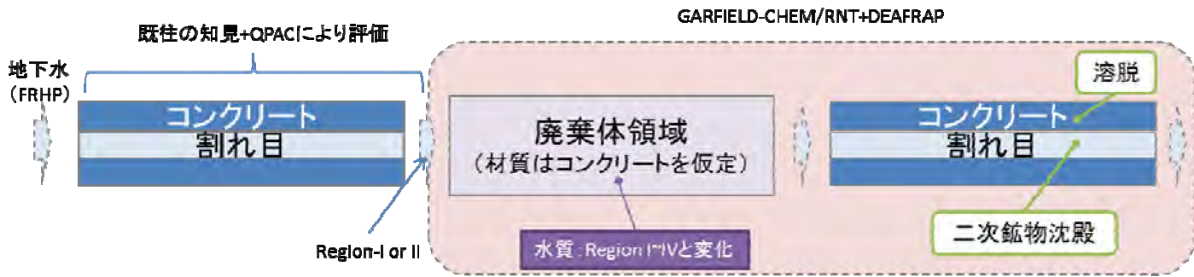
図 2.6.4-21 亀裂発生後の解析モデルの概念図
