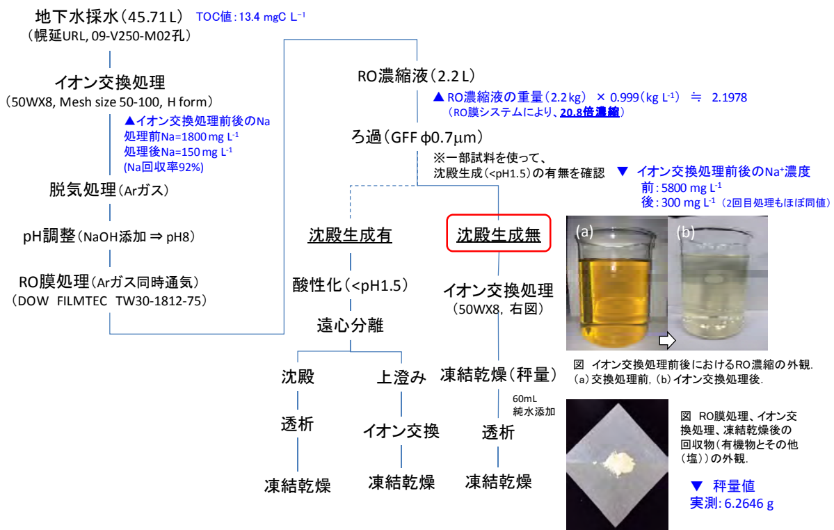
図2.4.3-11 イオン交換-逆浸透 (RO) 膜法による溶存有機物の一括濃縮法の検討
