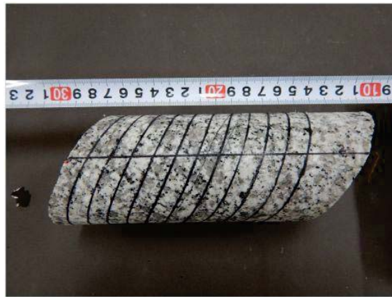
黒線箇所に沿ってコアを切断
