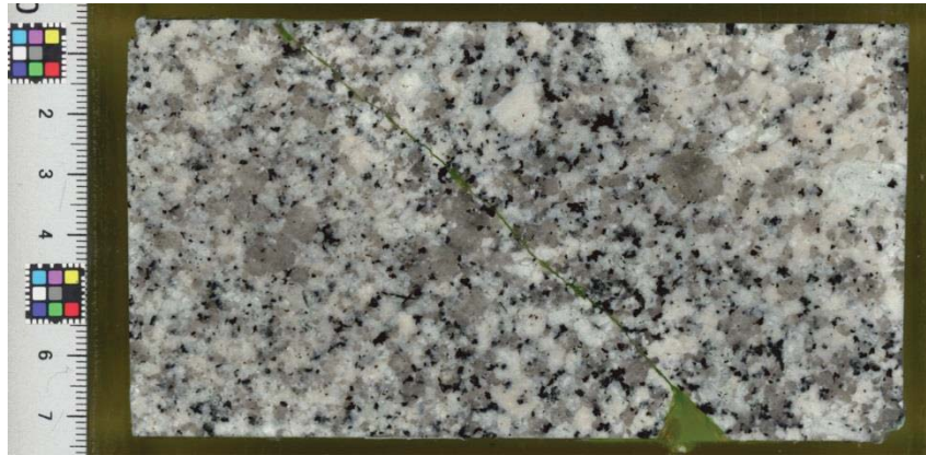
図 5.3-40 イメージスキャナで読み取った研削断面（切り込み深さ：30.40mm）
