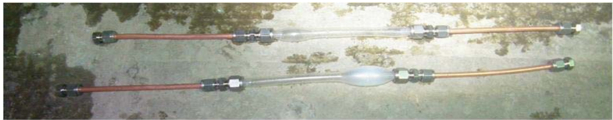
図 6.4.1-2 サンプラーの設置状況(管内)とサンプラーシリコンゴムの膨張
