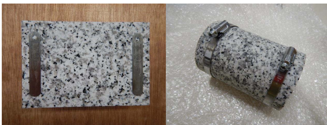
図 5.3-2 模擬亀裂を有する岩石試料
