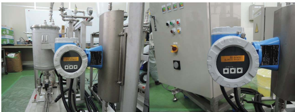
図 5.3-59 コリオリ式質量流量計の外観写真（左：主剤用、右：硬化剤用）
