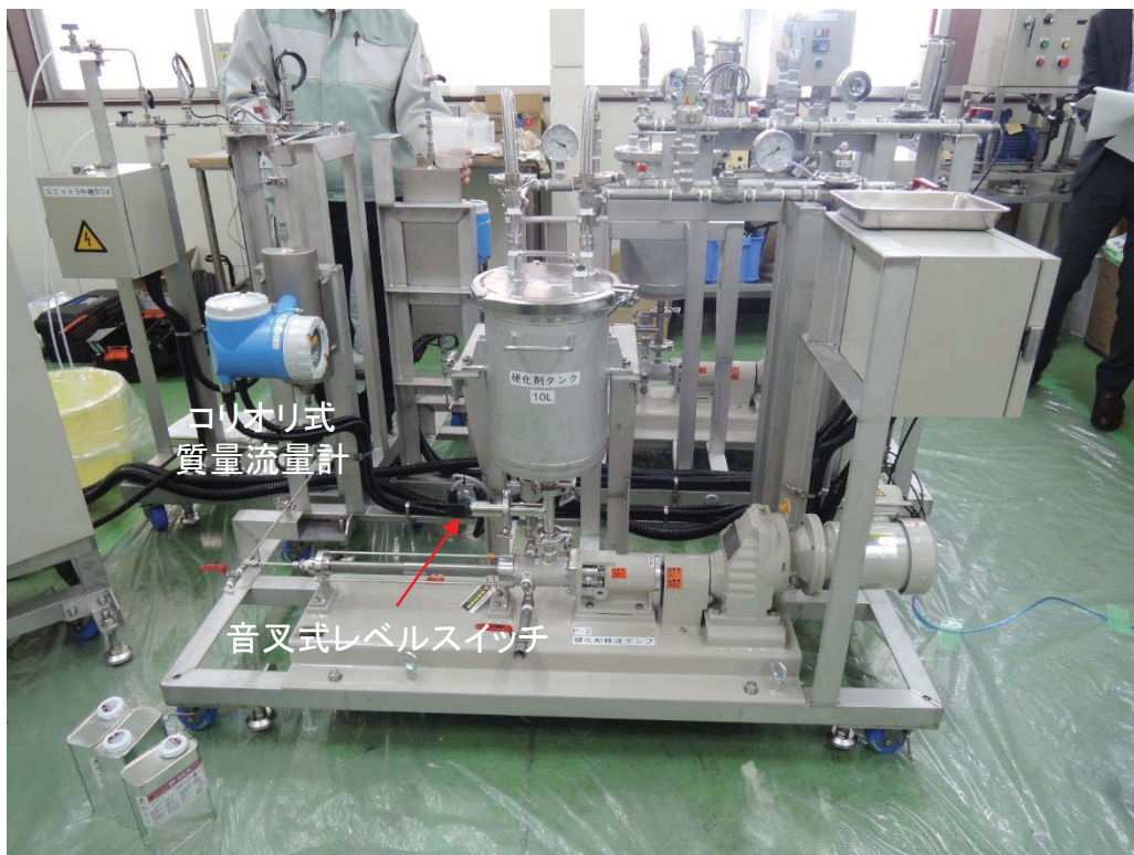
図 5.3-64 ユニット2（硬化剤移送ポンプユニット）の外観写真
