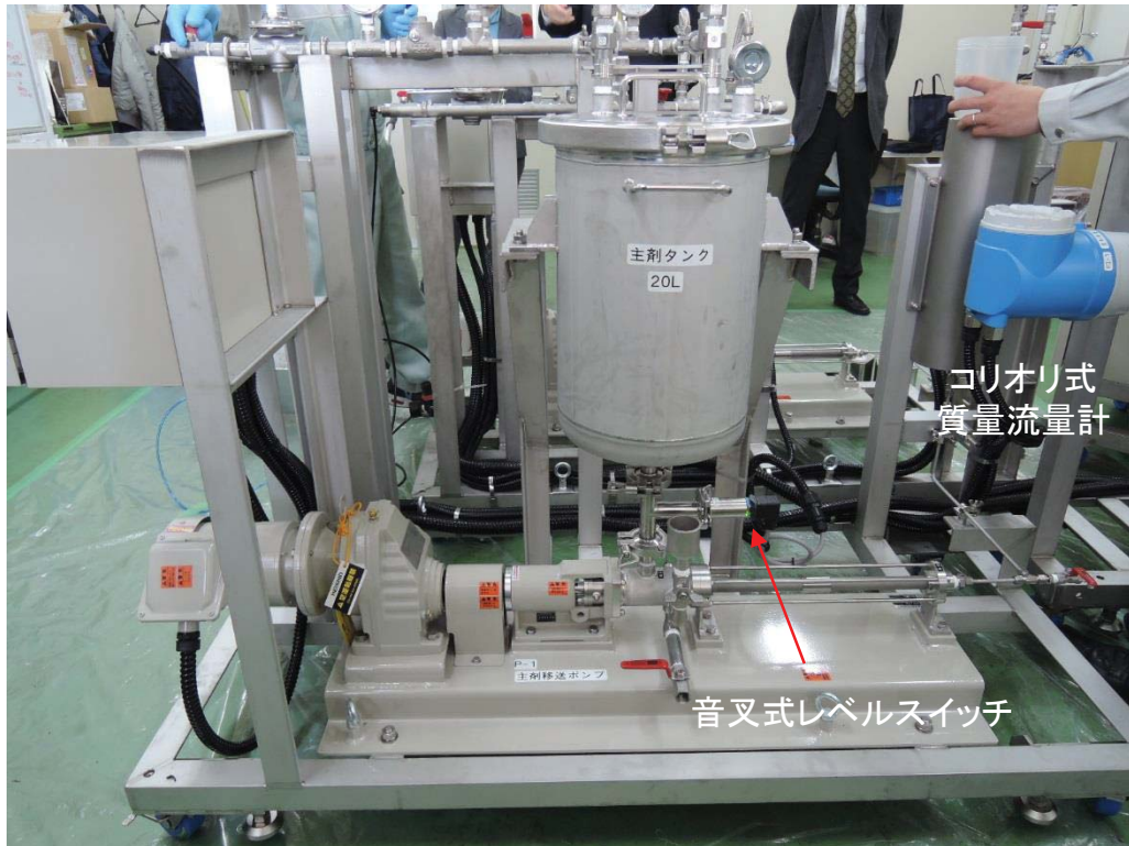
図 5.3-63 ユニット1（主剤移送ポンプユニット）の外観写真
