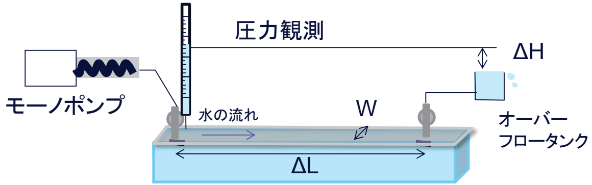
図 5.4.3-1 一次元モデルでの透水試験の概念図
