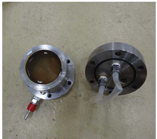
図 6.4.1-3 圧力容器と圧力容器の内部構造
