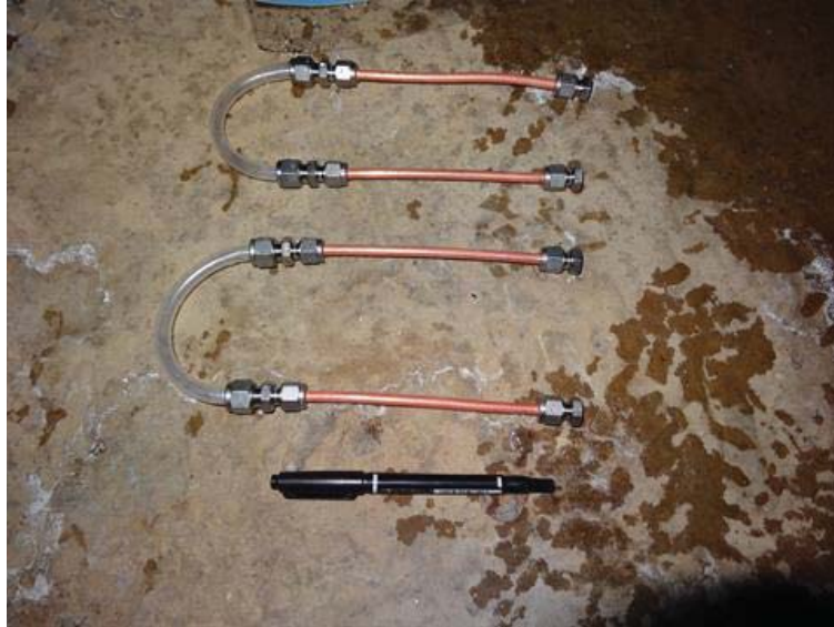
図 6.4.2-9 平衡式サンプラー
