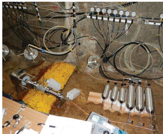
図 5.1.6-2 ラドン循環試験用採水ボトルの配置図と現場での設置状況
