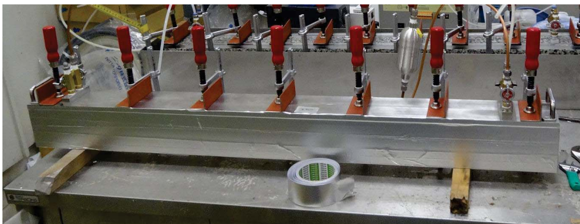
図 5.4.3-4 ラドン濃度計測のための密閉装置
