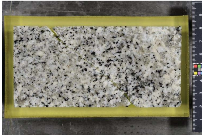
図 5.3-36 蛍光灯光源下の研削断面（切り込み深さ：50.35mm）
