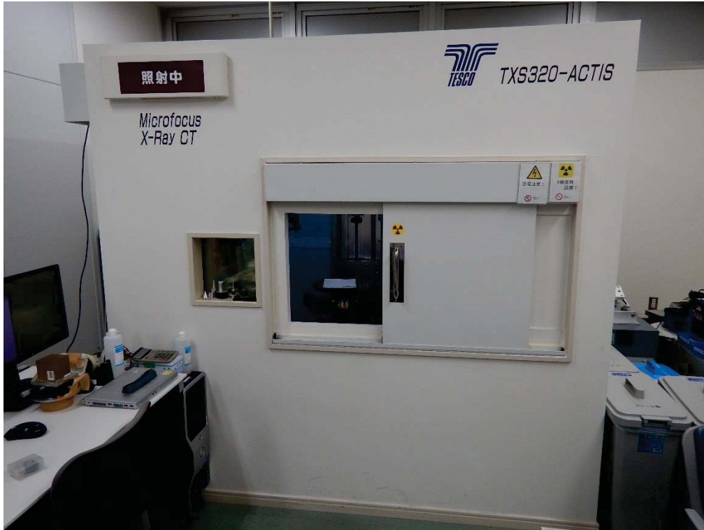
図 5.3-4 マイクロフォーカス X 線 CT システムの外観
