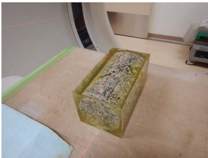
図 5.3-1 包埋固定後の岩石試料
