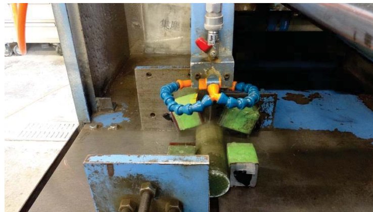
図 5.3-54 アクリルカラム切断状況写真
