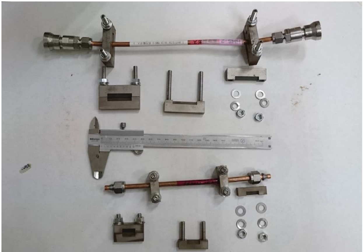
図 6.4.1-6 ガス採取用の銅管とクランプ(上側：中型クランプ、下側：小型クランプ)
