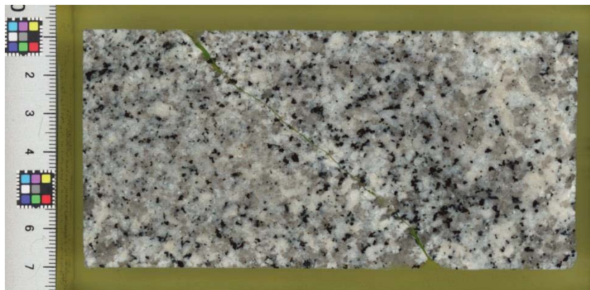
図 5.3-41 イメージスキャナで読み取った研削断面（切り込み深さ：50.35m）
