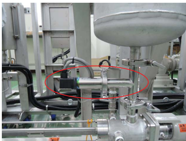
図 5.3-60 音叉式レベルスイッチの外形図と外観写真
