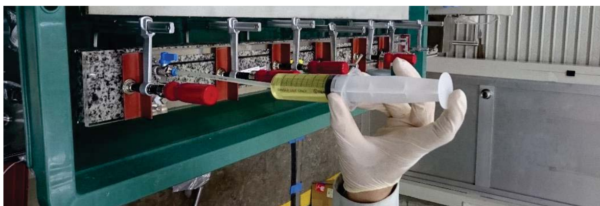
図 5.4.4-7 レジンの注入状況
