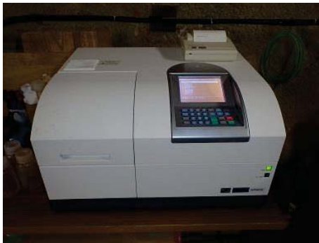
図 2.3.1-11 分光蛍光光度計と蛍光染料濃度計測状況
