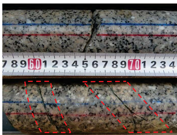
図2.4.1-8 11.59~11.74mabh 付近の割れ目上盤側の変質状況
