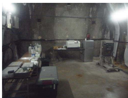
図 4.2.2-3 蛍光分光光度計と蛍光染料濃度測定状況
