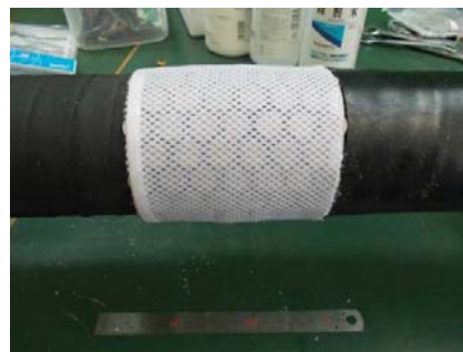
図 4.6.2-5 パッカー一体型孔内装置での試験区間の構築
