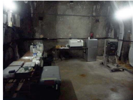
図 2.3.1-11 分光蛍光光度計と蛍光染料濃度計測状況
