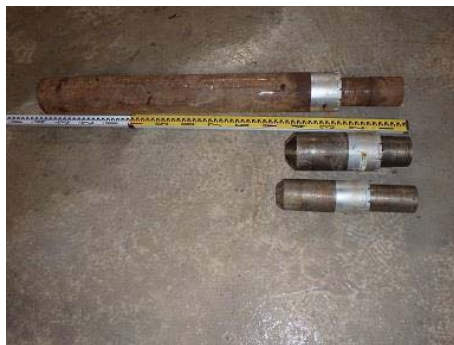
e. 拡径用ビット (上から \Phi 141\text{mm} , 127\text{mm} , 101\text{mm} )
