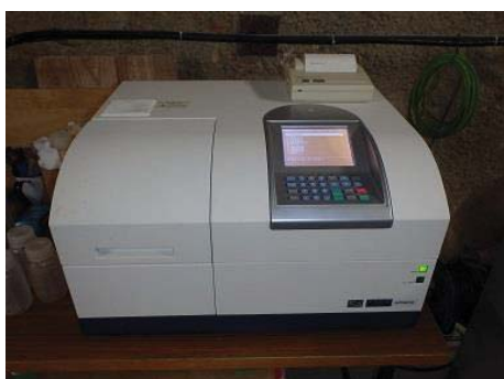
図 4.2.2-3 蛍光分光光度計と蛍光染料濃度測定状況
