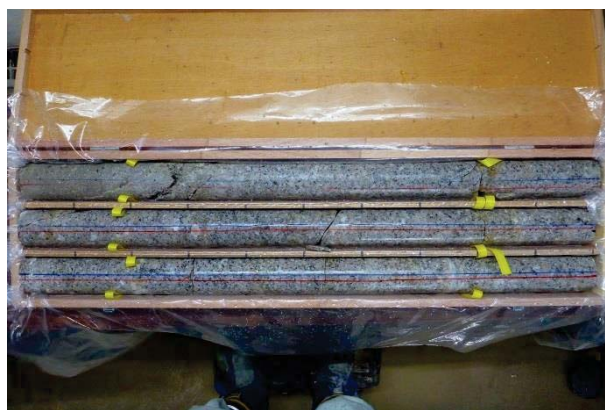
図 2.3.2-2 ボーリングコアのコア箱への収納状況
