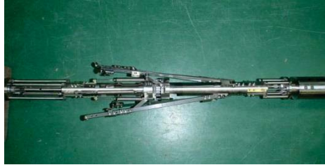
図 2.3.3-1 (上)キャリパープローブの全景 (下)測定用アーム (開いた状態)
