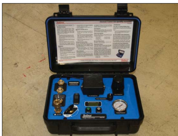
図 6.1-2 ポンプコントロールユニット
