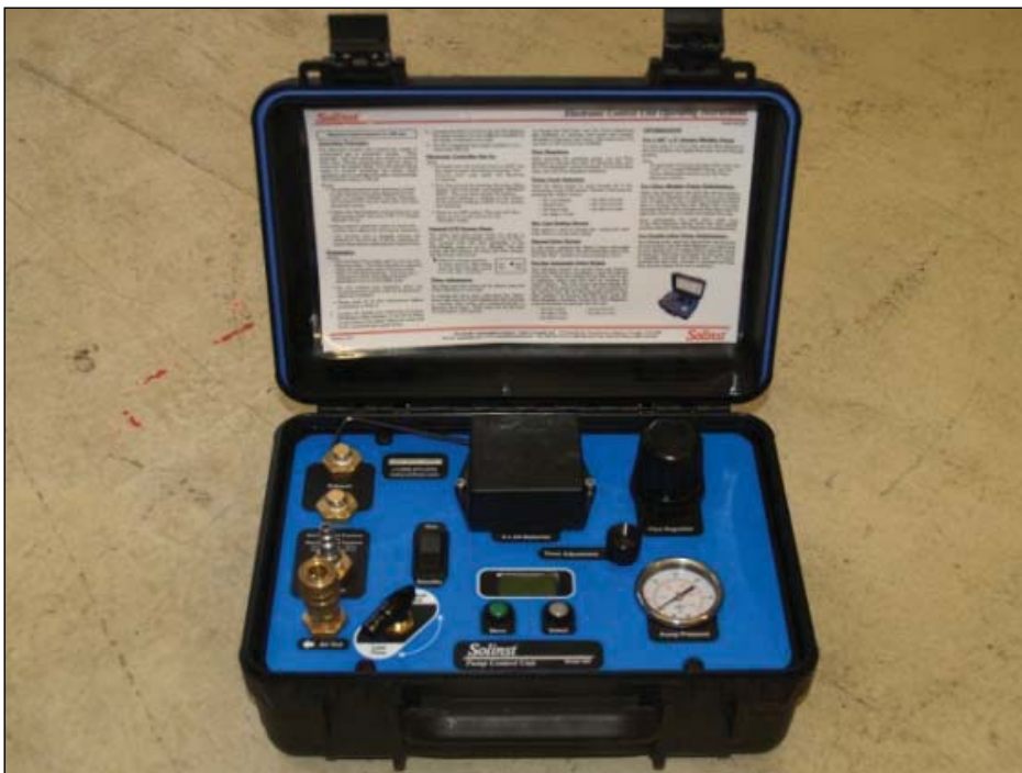
図 8.5-2 ポンプコントロールユニット
