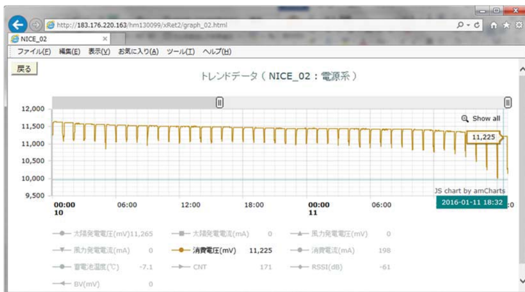
図 7.2-4 システム停止直前のバッテリー電圧
