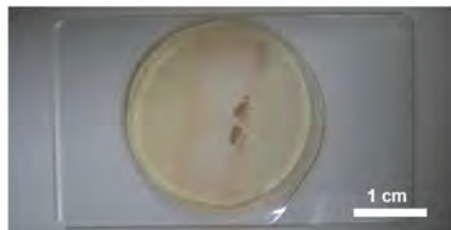
図 3.2-1 土岐花崗岩体中の割れ目に介在する炭酸塩鉱物の試料調製
