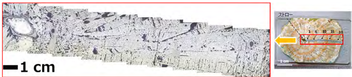
図 4.1-4 鍾乳石試料（AK-1）の落射偏光顕微鏡像
