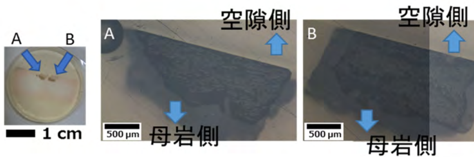
図 4.1-6 花崗岩体中の割れ目に介在する炭酸塩鉱物の落射偏光顕微鏡像
