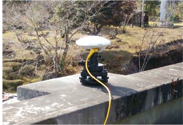
アンテナの設置状況
