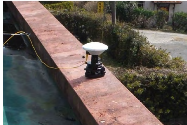
アンテナの設置状況
