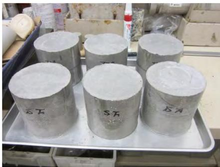
写真 4.3.2-18 真空槽を用いた脱気浸水法によるモルタルの初期飽和状況
