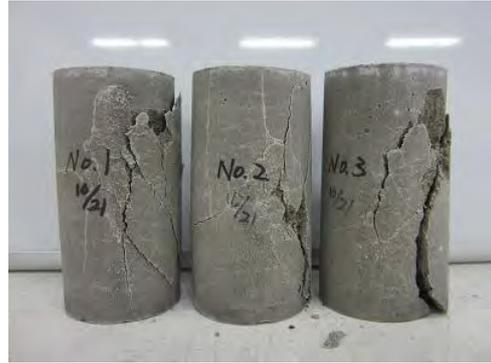
写真 4.3.2-21 一軸圧縮強度試験後のケース 3
