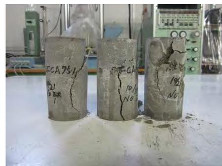
写真 4.3.2-19 一軸圧縮強度試験後のケース 3
