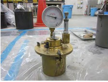
写真 4.3.2-7 エア一量確認試験
