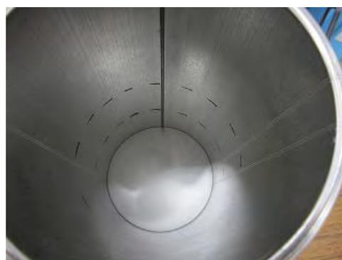
写真 4.3.2-4 打継供試体用サミット管
