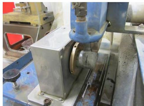
写真 4.3.2-21 コアリングした打継試料の端面カット状況
