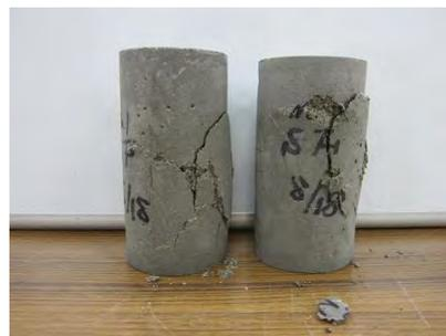
写真 4.3.2-11 一軸圧縮強度試験後のケース 1 配合モルタル状況 (n=2) 28 日
