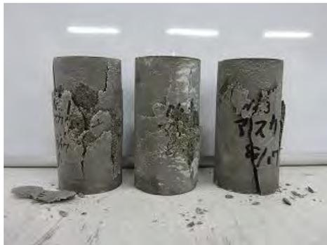
写真 4.3.2-13 一軸圧縮強度試験後のケース 2
