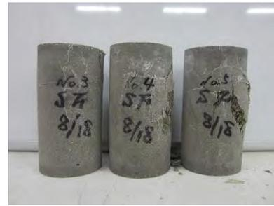
写真 4.3.2-13 一軸圧縮強度試験後のケース 1
