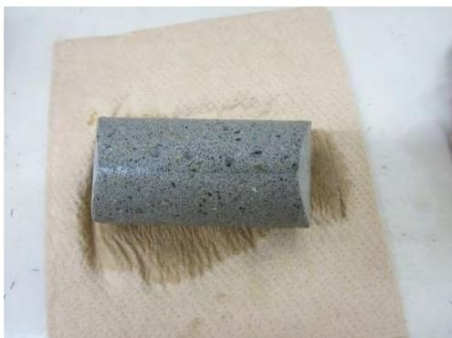
写真 4.3.2-20 コアリングした打継試料
