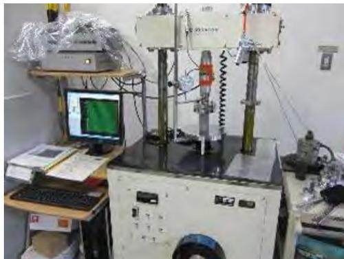
写真 4.3.2-9 モルタルの一軸圧縮強度測定状況 (n=3)
