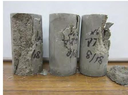
写真 4.3.2-14 一軸圧縮強度試験後のケース 2
