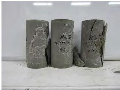
写真 4.3.2-15 一軸圧縮強度試験後のケース 2
