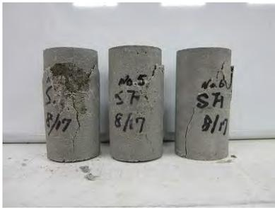
写真 4.3.2-12 一軸圧縮強度試験後のケース 1
