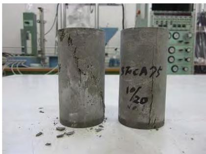
写真 4.3.2-17 一軸圧縮強度試験後のケース 3
