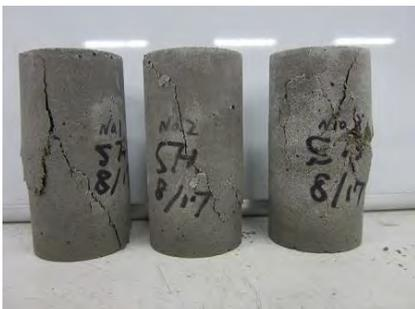
写真 4.3.2-10 一軸圧縮強度試験後のケース 1 配合モルタル状況 (n=3) 28 日
