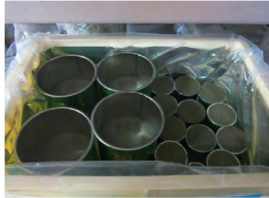
写真 4.3.2-8 供試体の水中養生状況（透水・透気試験用、および一軸圧縮強度確認用）
