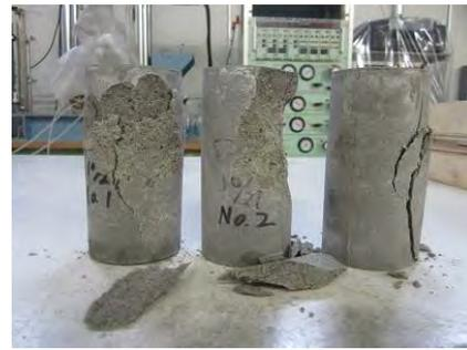
写真 4.3.2-23 一軸圧縮強度試験後のケース 4
