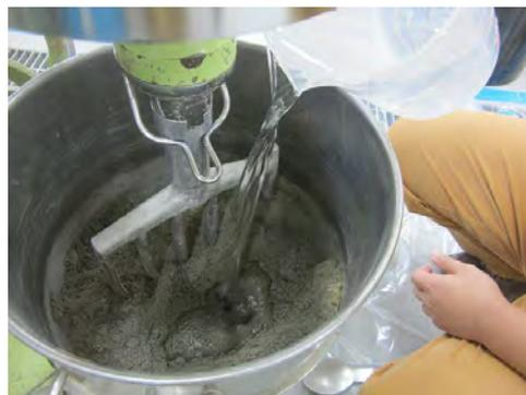
写真 4.3.2-2 ミキサー攪拌状況
