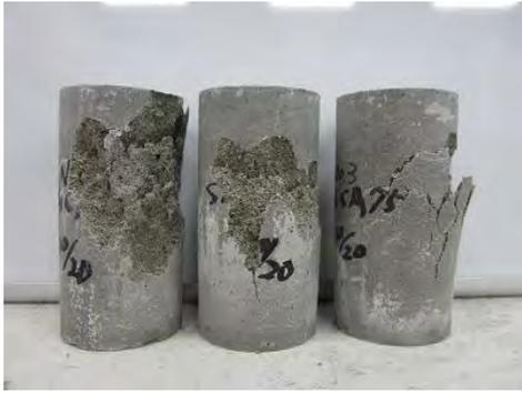
写真 4.3.2-20 一軸圧縮強度試験後のケース 3
