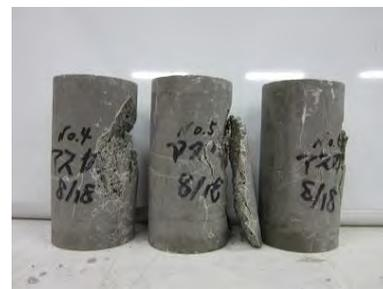
写真 4.3.2-16 一軸圧縮強度試験後のケース 2
