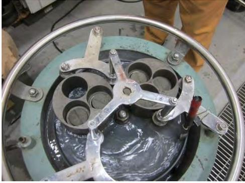
写真 4.3.2-22 コアリングした打継試料の端面整形状況
