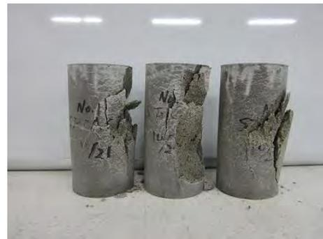
写真 4.3.2-25 一軸圧縮強度試験後のケース 4
