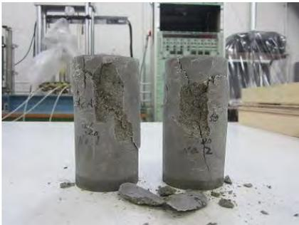
写真 4.3.2-22 一軸圧縮強度試験後のケース 4
