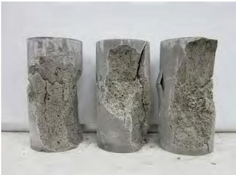
写真 4.3.2-24 一軸圧縮強度試験後のケース 4
