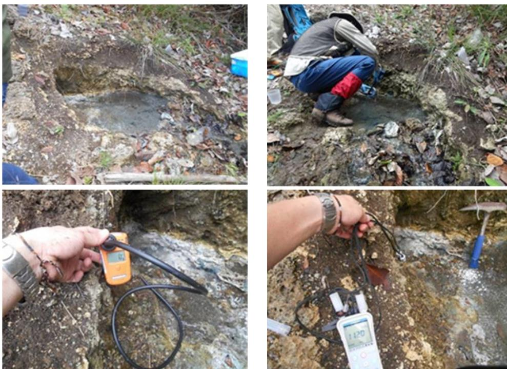
図 2.6.1-2 Narra3-1 アルカリ泉 (試料採取、水質・ガス測定)
