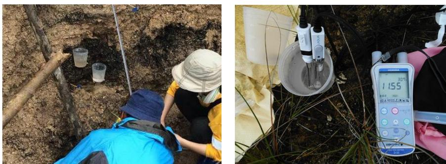
図 2.5.1-25 トレンチ 1 水試料採取および現地水質測定
