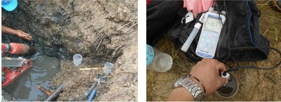
図 2.5.1-26 トレンチ 2 水試料採取および現地水質測定
