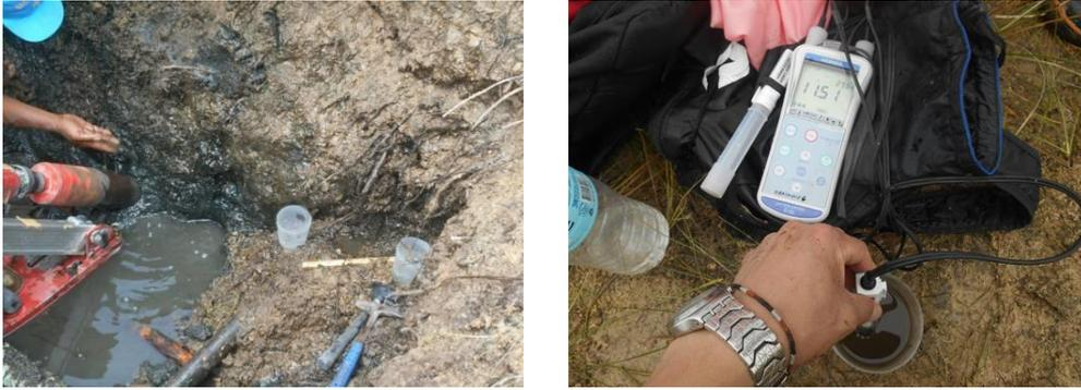
図 2.6.2-11 トレンチ 2 の水試料採取および現地水質測定
