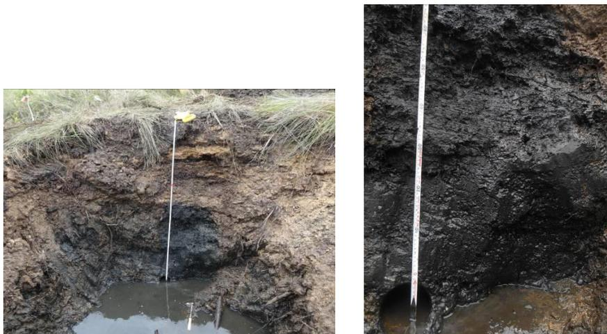
図 2.6.2-8 トレンチ2の壁面全体写真(左)と海洋性堆積物と見られる粘土層(右)
