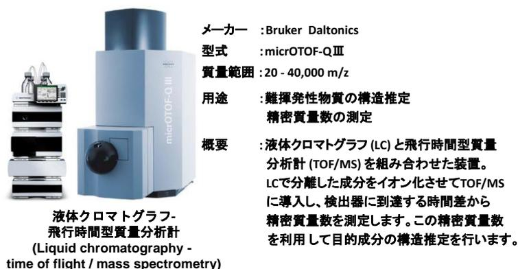
図 4.4.3-1 LC/TOF-MS分析装置の例
