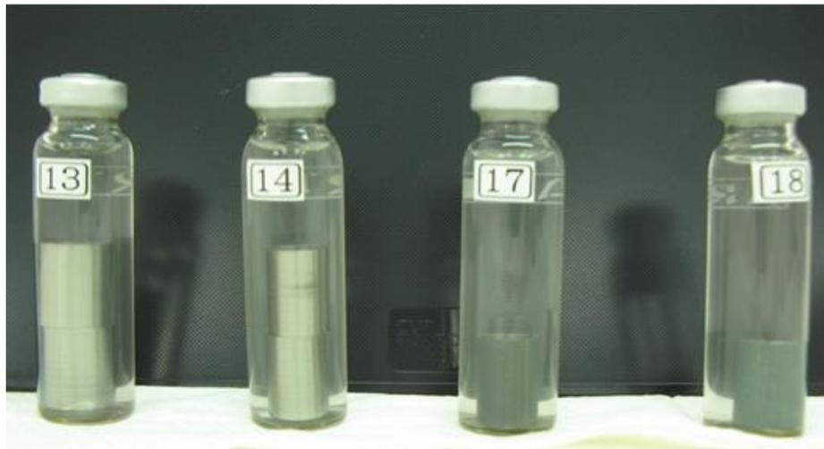
図 2.6.2-4 超音波による析出物溶解・分散後の浸漬試料外観
