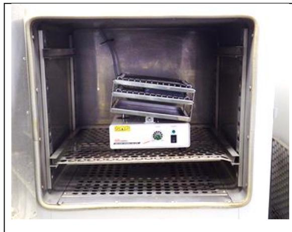
図 2.5.4-7 ジルコニウム水素化物の浸漬試験状況
