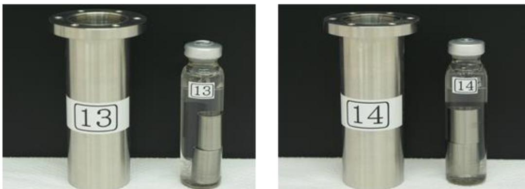
図 2.6.2-2 STEPI 照射済み被覆管母材試料の外観
