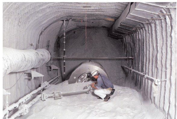
アッセII研究鉱山での実規模キャスクを用いた実験の様相 （写真提供：DBE）
