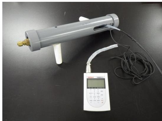
図 8 原位置浸透率測定用プローブケースの模式図（左）と外観（右）
