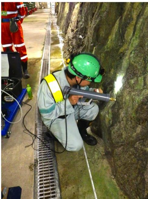
図 9 プローブケースを使用した原位置岩盤の浸透率測定
