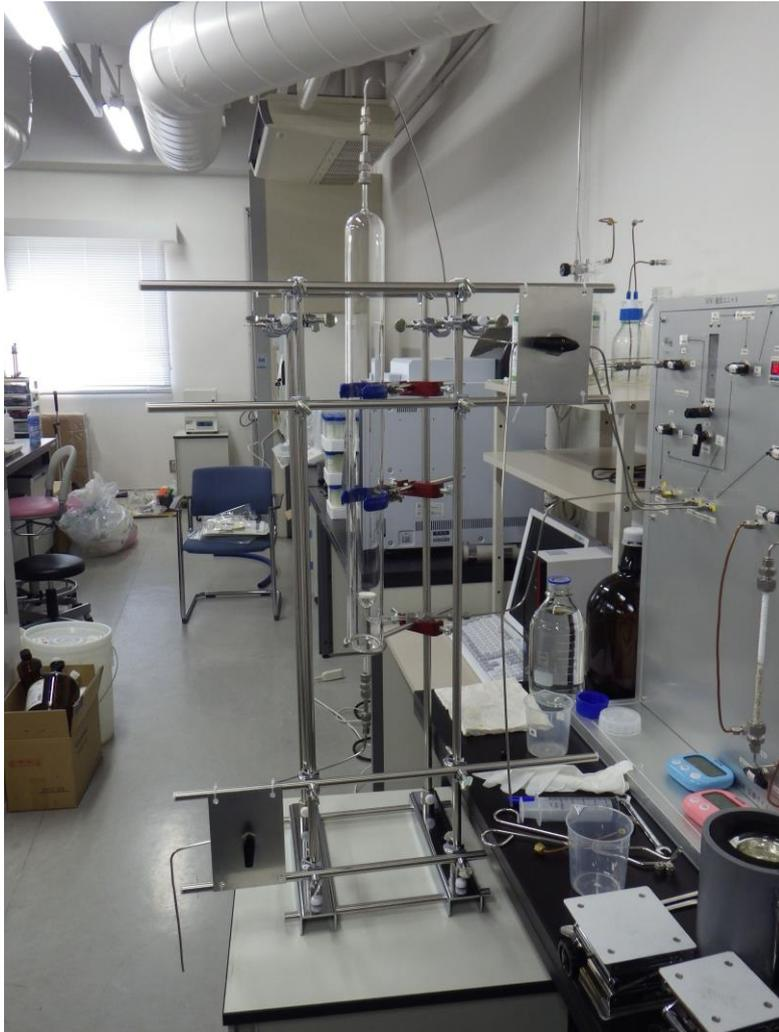
図 50 改良した SF<sub>6</sub>分析システムの脱気瓶外観
