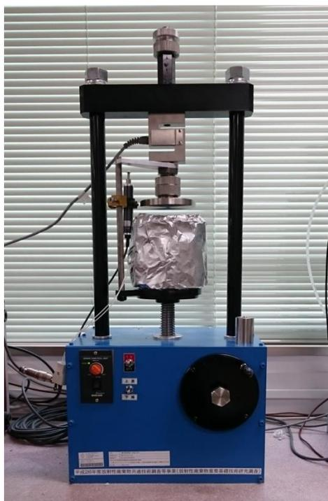
写真 - 1 一軸試験装置
