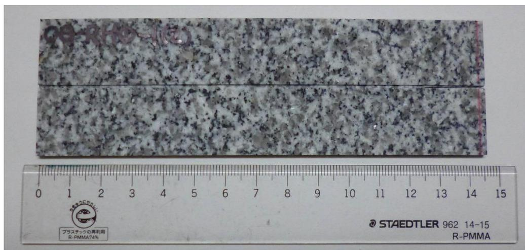
図 19 ダブルトーション試験片の写真
