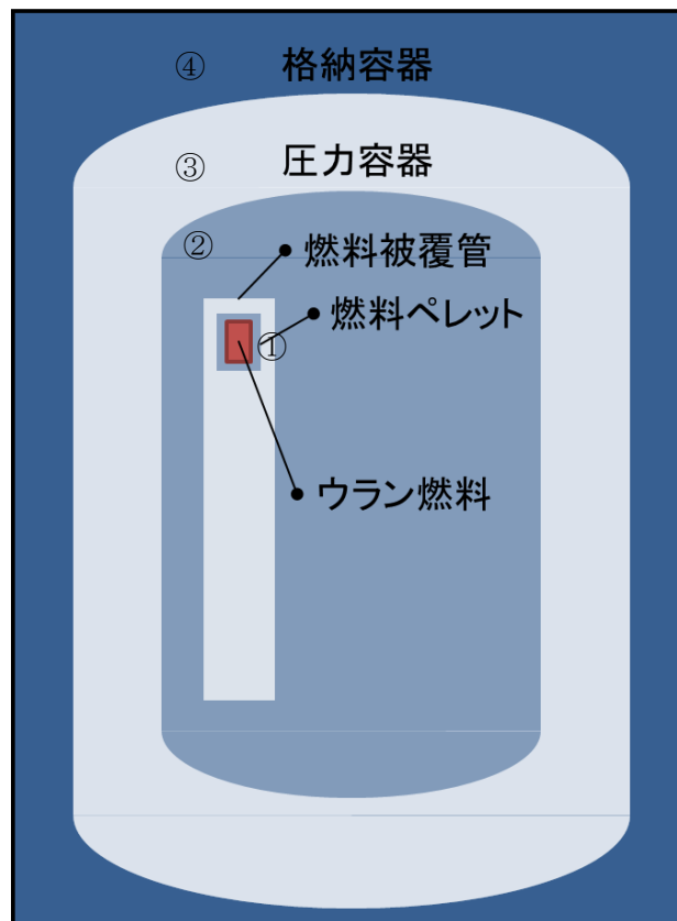
図 3.3.3-3 原子炉施設における多重障壁の概念
