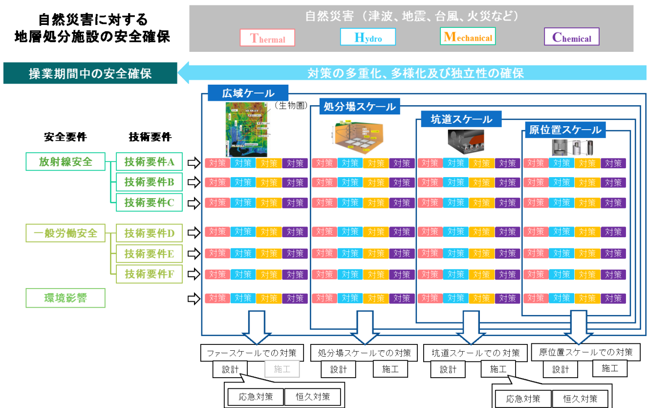
図 3.4.2-1 処分施設のスケールと安全対策技術との関係
