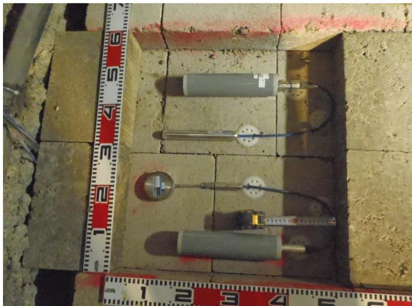
図 2.2.5-2 埋戻し材ブロックへの地中無線送信装置及びセンサの設置状況
