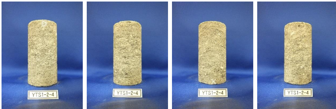
熱伝導率測定供試体③ (110°C炉乾燥状態)
