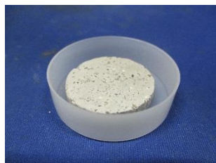
図 3.2.2-14 作成した緩衝材供試体(直径 35mm×高さ 4mm程度)
