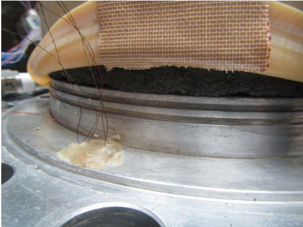
図 4.3.4-3 ひずみゲージのリード線の防水処理状況
