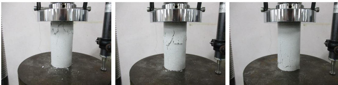
一軸壓縮試驗 後供試體①~③（乾燥密度 1.6\text{Mg/m}^3 初期含水比 10%）
