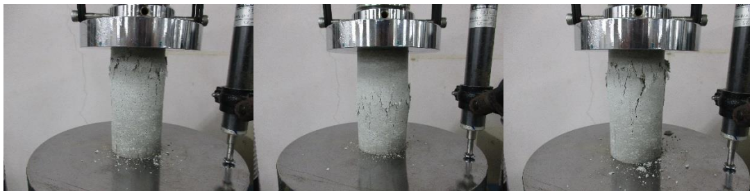
一軸圧縮試験 後供試体④~⑥ (乾燥密度 1.7\text{Mg/m}^3 初期含水比 15%)
