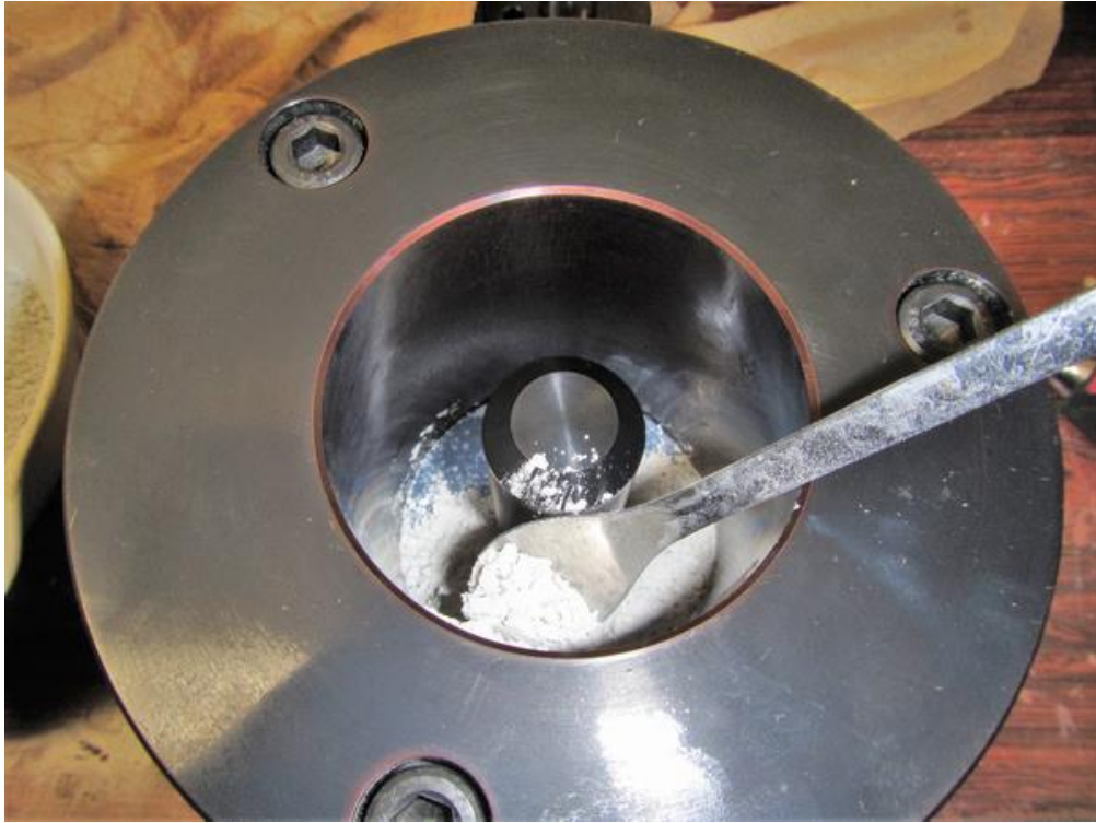
図 4.3.3-3 緩衝材試料（クニゲル V1、70wt%、混合ケイ砂 30wt%）
