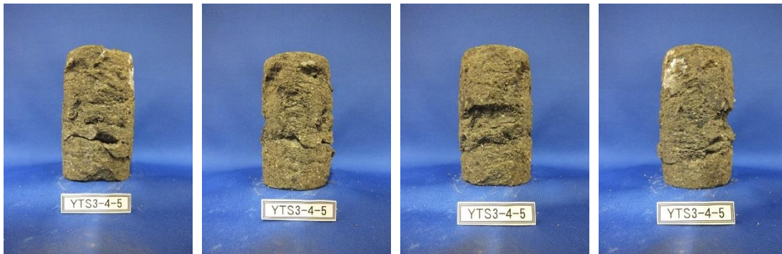
三軸圧縮試験③ 後供試体 ( \sigma'_c=5.0\text{Mpa} )
