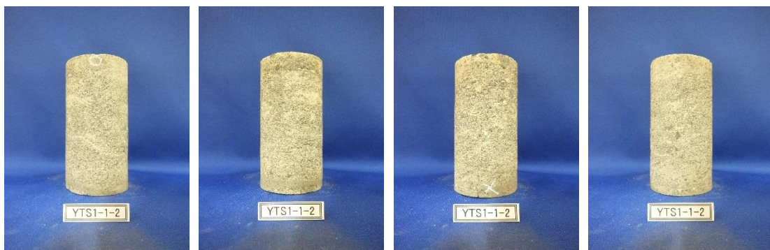
熱伝導率測定供試体①（110°C炉乾燥状態）
