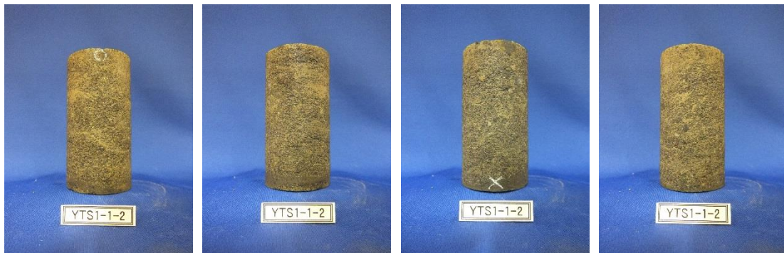
熱伝導率測定供試体①（湿潤状態）
