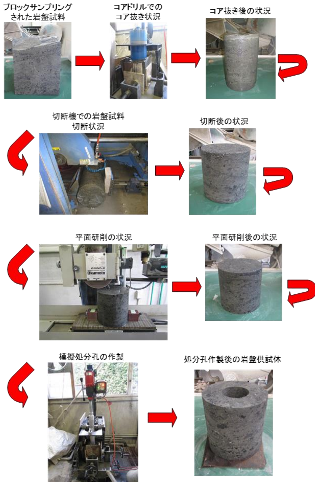
図 4.3.3-7 岩盤試料の整形状況
