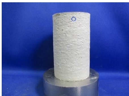
三軸圧縮試験④ 後供試体 ( \sigma_c'=7.0\text{Mpa} )
