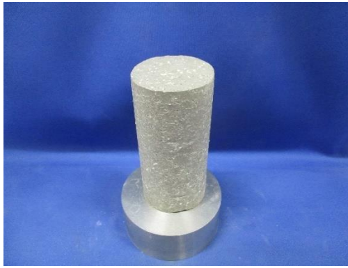
熱伝導率測定供試体② (乾燥密度 1.6\text{Mg/m}^3 初期含水比 24%)
