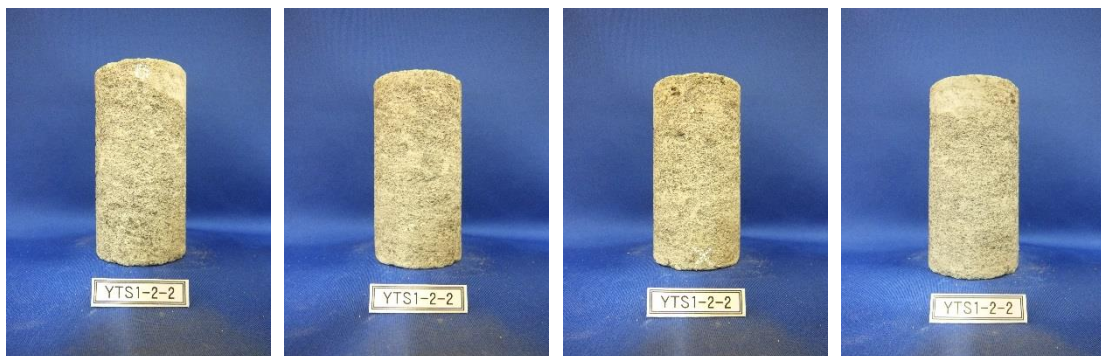
熱伝導率測定供試体②（110°C炉乾燥状態）
