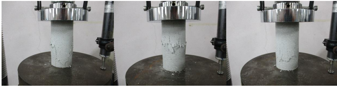
一軸圧縮試験 後供試体①~③ (乾燥密度 1.7\text{Mg/m}^3 初期含水比 12%)
