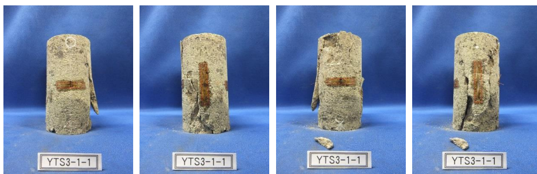
一軸圧縮試験① 後供試体 (乾燥状態)
