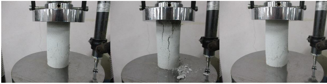
一軸圧縮試験 後供試体①~③ (乾燥密度 1.5\text{Mg}/\text{m}^3 初期含水比 12%)
