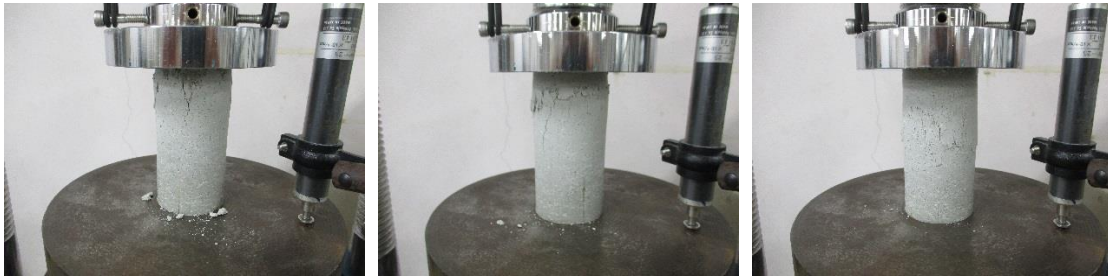
一軸圧縮試験 後供試体①~③ (乾燥密度 1.6\text{Mg}/\text{m}^3 初期含水比 15%)
