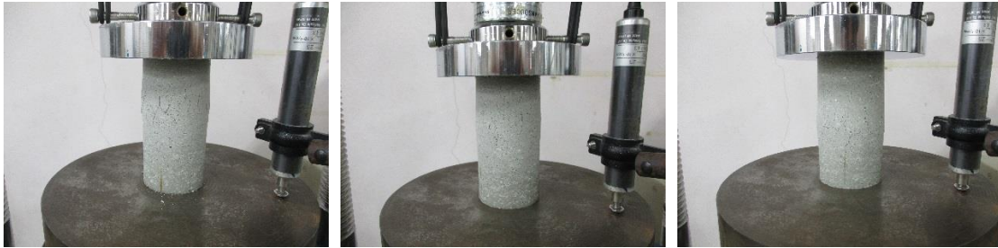
一軸圧縮試験 後供試体①~③ (乾燥密度 1.6\text{Mg}/\text{m}^3 初期含水比 18%)
