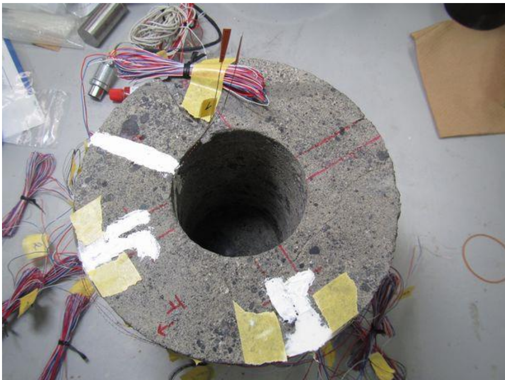
図 4.3.3-14 ひずみゲージ貼付部分へのコーティング状況
