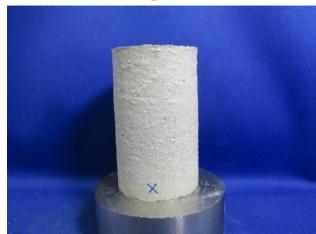
三軸圧縮試験④ 後供試体 ( \sigma_c'=7.0\text{Mpa} )
