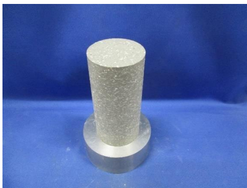
熱伝導率測定供試体① (乾燥密度 1.6\text{Mg/m}^3 初期含水比 24%)
