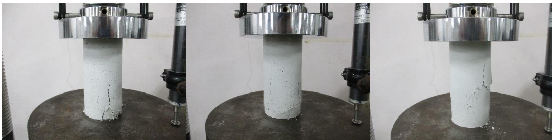
一軸圧縮試験 後供試体①~③ (乾燥密度 1.5\text{Mg}/\text{m}^3 初期含水比 10%)
