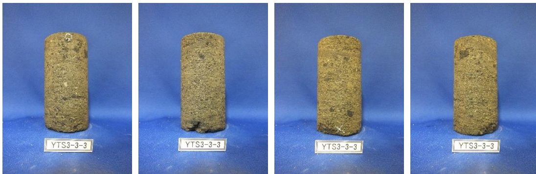
熱伝導率測定供試体⑥ (湿潤状態)
