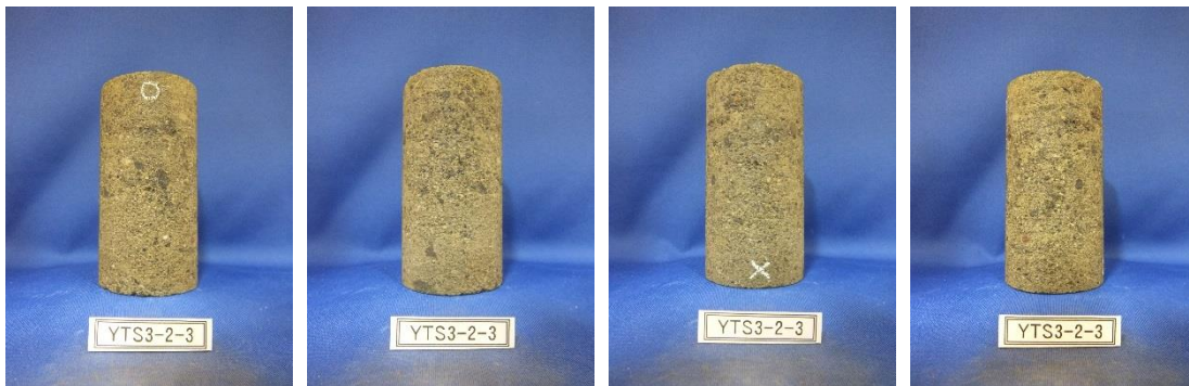
熱伝導率測定供試体④ (湿潤状態)
