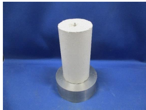
熱伝導率測定供試体② (乾燥密度 1.7\text{Mg/m}^3 初期含水比 10%)
