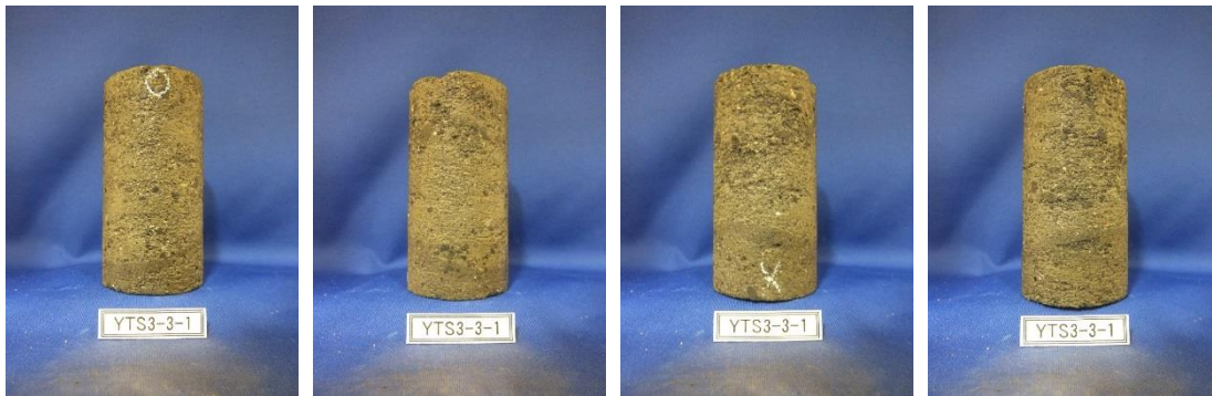
三軸圧縮試験① 前供試体 ( \sigma_c' = 1.5\text{Mpa} )
