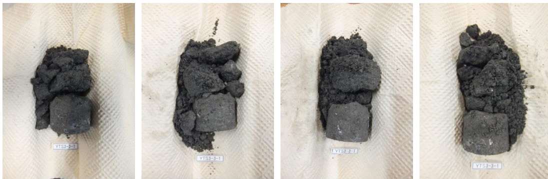
三軸圧縮試験① 後供試体 ( \sigma_c' = 1.5\text{Mpa} )
