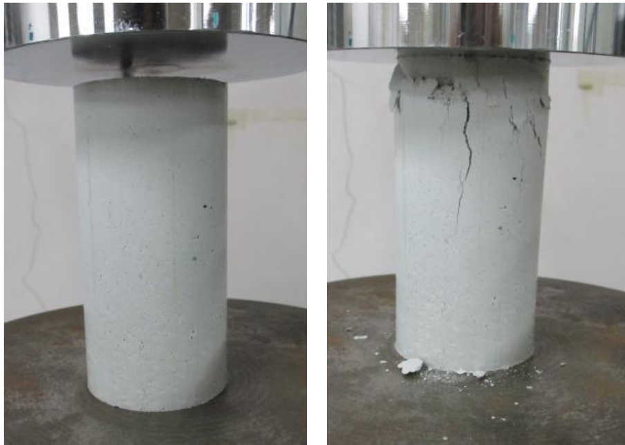
一軸圧縮試験前
