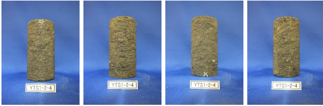
熱伝導率測定供試体③ (湿潤状態)
