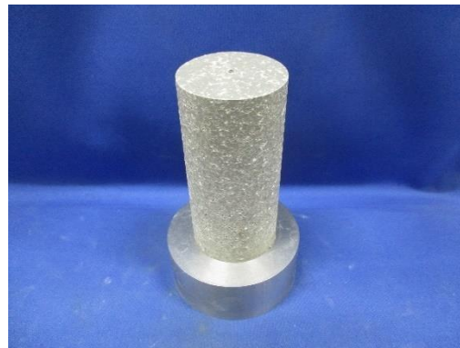
熱伝導率測定供試体② (乾燥密度 1.6\text{Mg/m}^3 初期含水比 23%)
