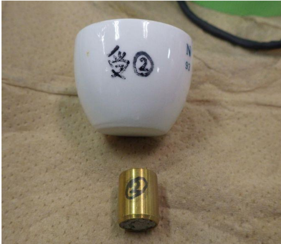
図 4.4.2-1 実験後の含水比計測に使用した試料採取ロッド
