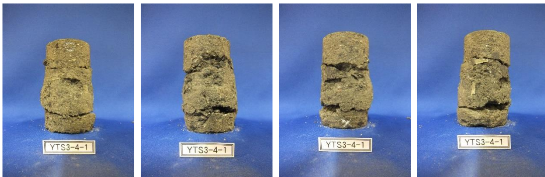
三軸圧縮試験② 後供試体 ( \sigma_c' = 3.0\text{Mpa} )
