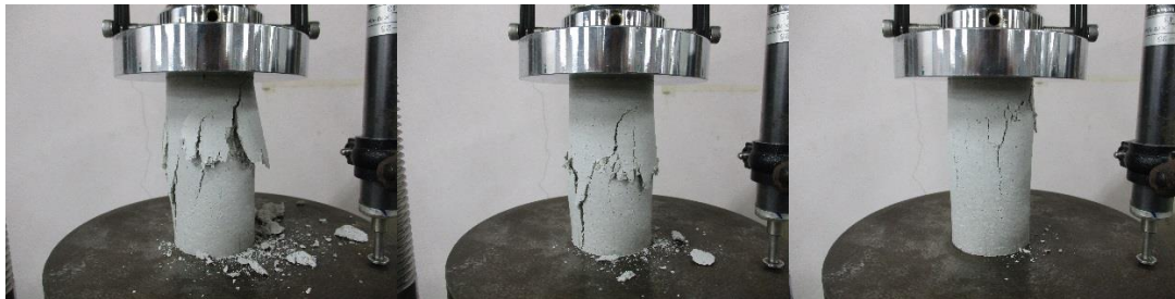
一軸圧縮試験 後供試体④~⑥ (乾燥密度 1.7\text{Mg/m}^3 初期含水比 12%)
