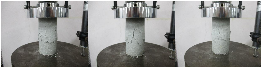
一軸圧縮試験 後供試体①~③ (乾燥密度 1.7\text{Mg/m}^3 初期含水比 15%)
