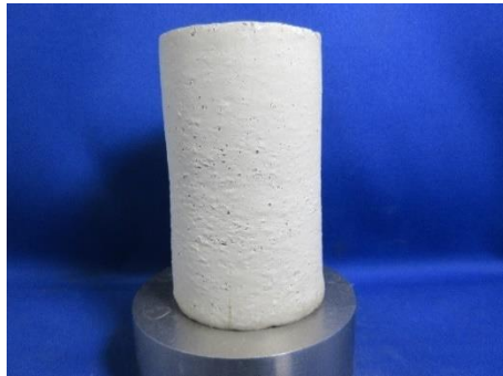
三軸圧縮試験① 後供試体 ( \sigma_c'=1.5\text{Mpa} )
