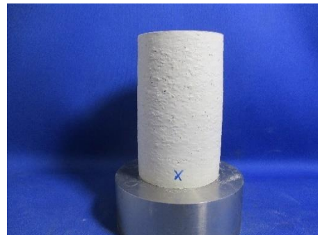
三軸圧縮試験③ 後供試体 ( \sigma_c'=5.0\text{Mpa} )
