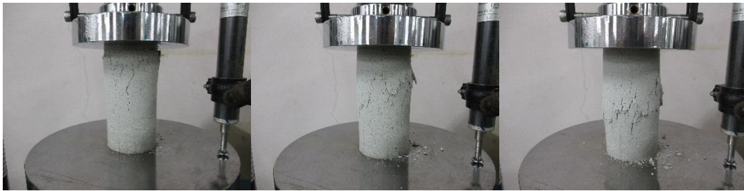
一軸圧縮試験 後供試体①~③ (乾燥密度 1.5\text{Mg}/\text{m}^3 初期含水比 15%)
