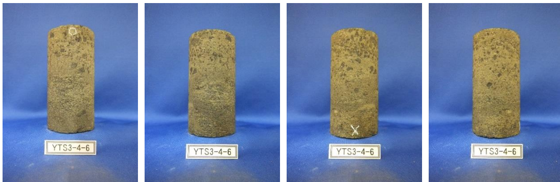
三軸圧縮試験④ 前供試体 ( \sigma'_c=7.0\text{Mpa} )
