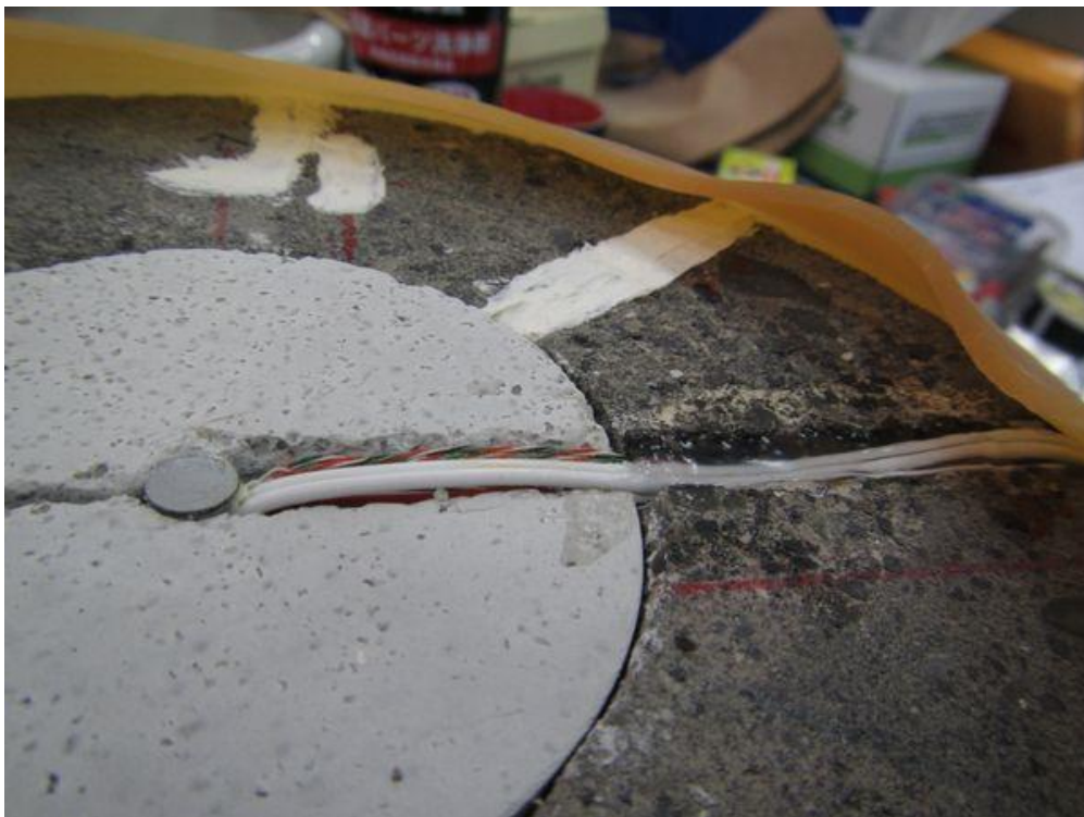
図 4.3.3-20 オーバーパックケーブル類埋設状況
