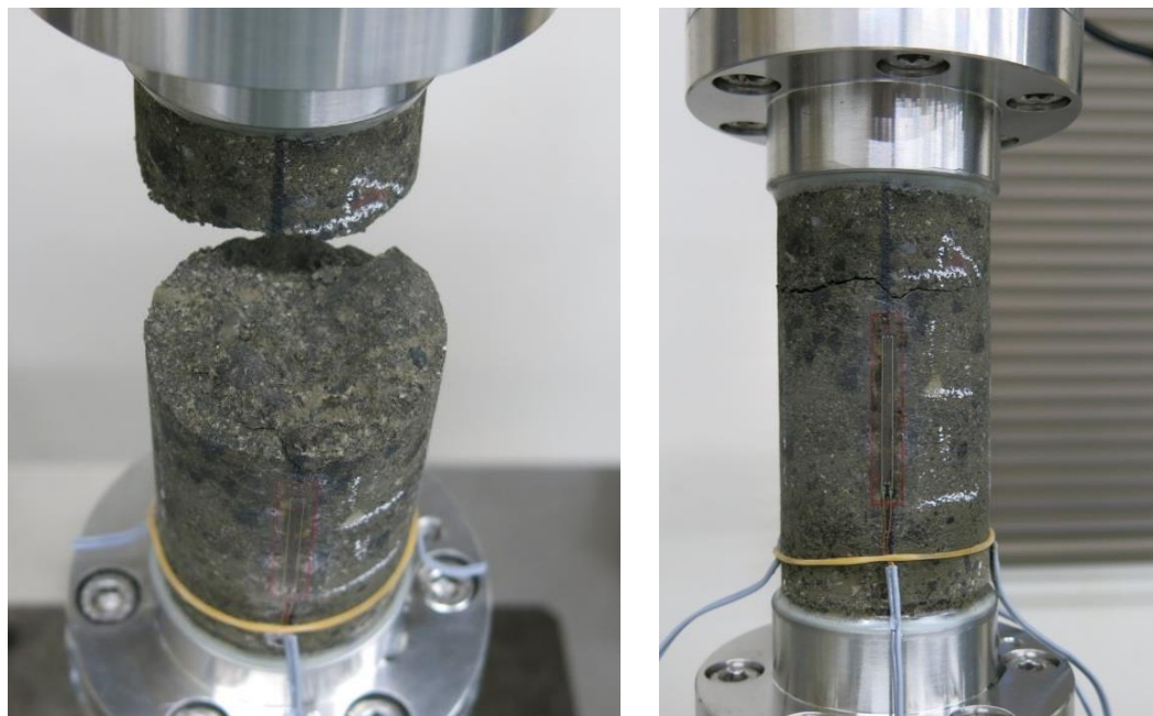
図 3.2.2-48 一軸引張試験後の供試体状況
