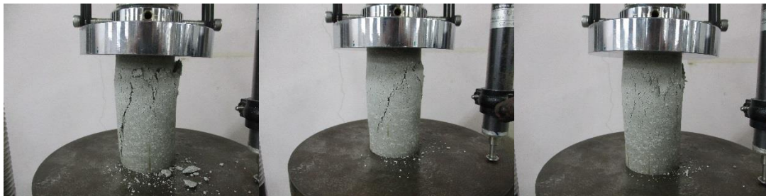
一軸圧縮試験 後供試体①~③ (乾燥密度 1.7\text{Mg/m}^3 初期含水比 18%)
