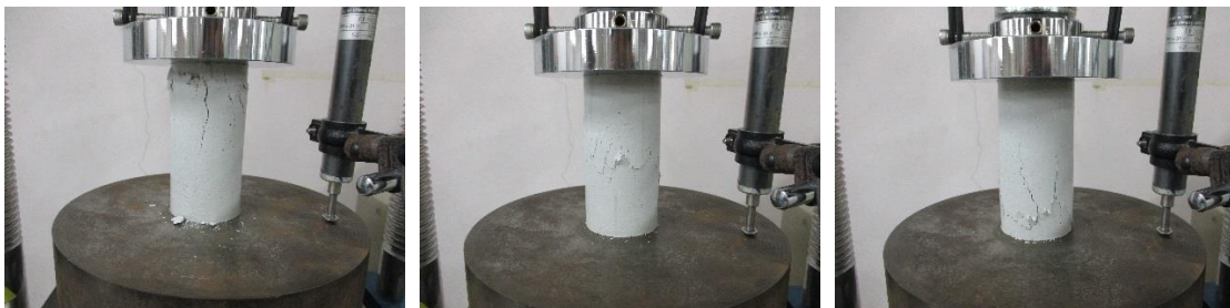
一軸壓縮試驗 後供試體④~⑥（乾燥密度 1.6\text{Mg/m}^3 初期含水比 10%）
