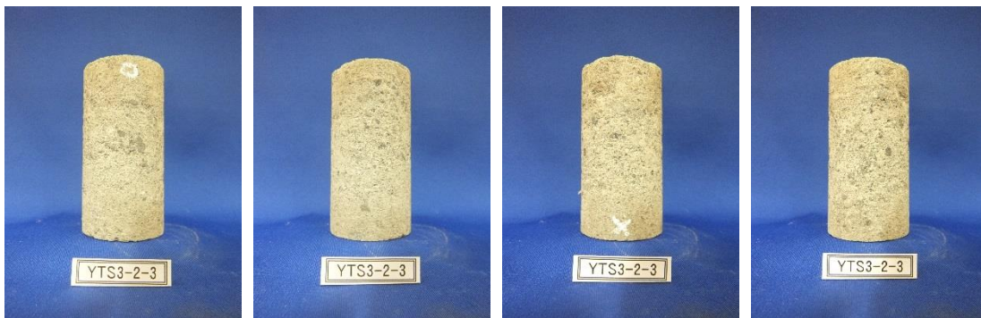
熱伝導率測定供試体④ (110°C炉乾燥状態)
