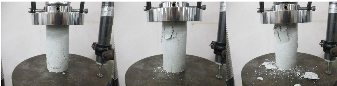
一軸圧縮試験 後供試体①~③ (乾燥密度 1.7\text{Mg}/\text{m}^3 初期含水比 10%)
