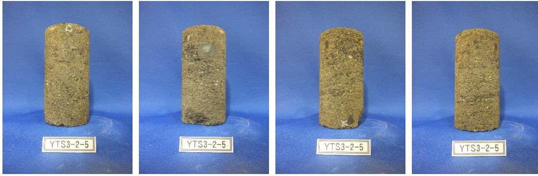
熱伝導率測定供試体⑤ (湿潤状態)
