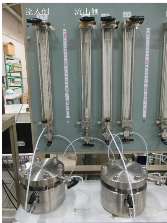
図 3.2.2-5 膨潤圧測定状況 (供試体下部より給水)
