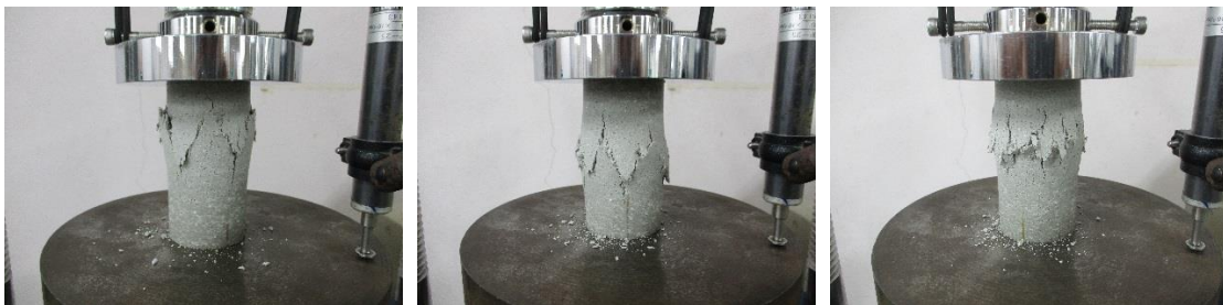
一軸圧縮試験 後供試体④~⑥ (乾燥密度 1.6\text{Mg}/\text{m}^3 初期含水比 18%)
