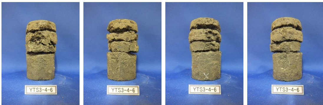
三軸圧縮試験④ 後供試体 ( \sigma'_c=7.0\text{Mpa} )
