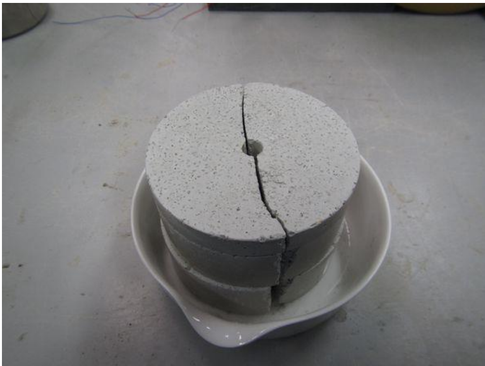
図 4.3.3-18 緩衝材ブロックの切断状況
