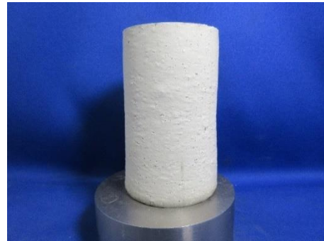
三軸圧縮試験① 後供試体 ( \sigma_c'=1.5\text{Mpa} )
