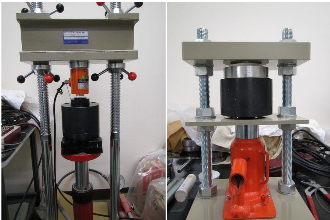
図 4.3.3-4 ベントナイト締め機（左）、圧縮ベントナイト取出し機（右）
