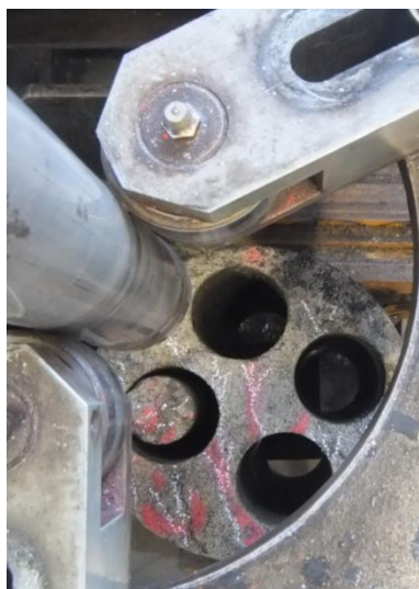
図 3.2.2-15 周辺岩盤供試体 (直径 35mm×高さ 4mm程度)
