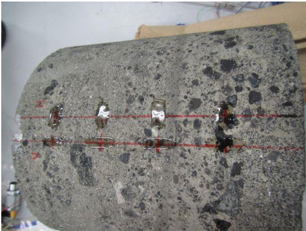
図 4.3.3-12 下地剤塗布状況
