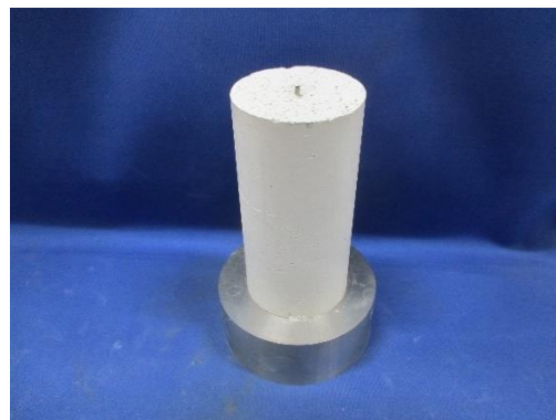
熱伝導率測定供試体①（乾燥密度 1.6\text{Mg/m}^3 初期含水比 5%）
