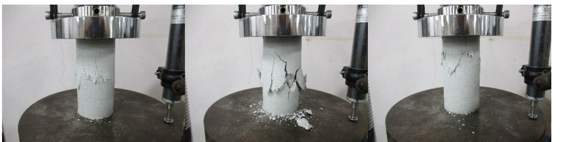
一軸壓縮試驗 後供試體④~⑥（乾燥密度 1.6\text{Mg/m}^3 初期含水比 12%）
