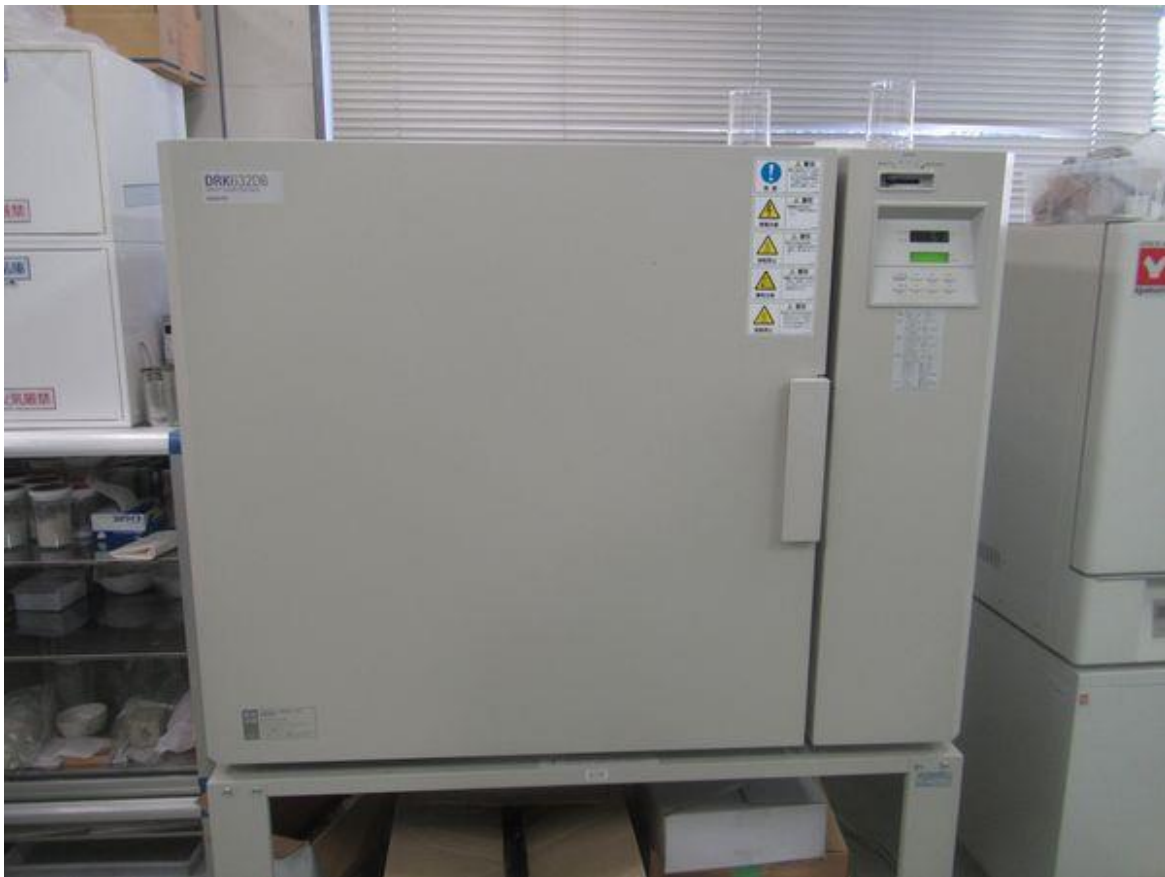
図 4.3.3-8 ADVANTEC DRK632DB 送風定温乾燥機
