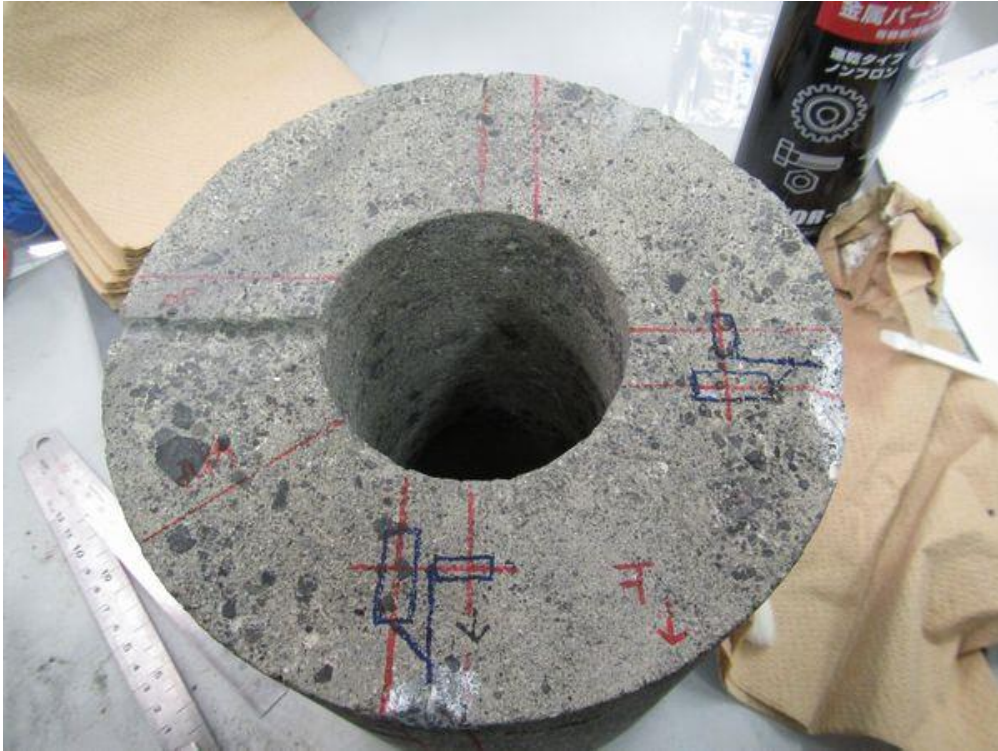
図 4.3.3-9 岩盤供試体へのマーキング状況
