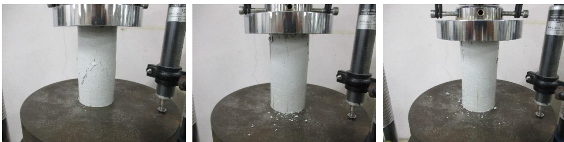
一軸壓縮試驗 後供試體①~③（乾燥密度 1.6\text{Mg/m}^3 初期含水比 12%）
