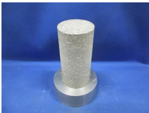
熱伝導率測定供試体① (乾燥密度 1.6\text{Mg/m}^3 初期含水比 20%)
