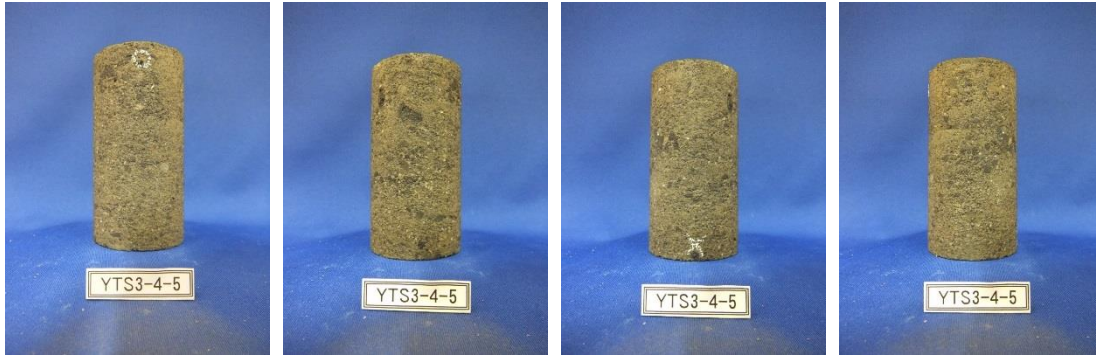
三軸圧縮試験③ 前供試体 ( \sigma'_c=5.0\text{Mpa} )
