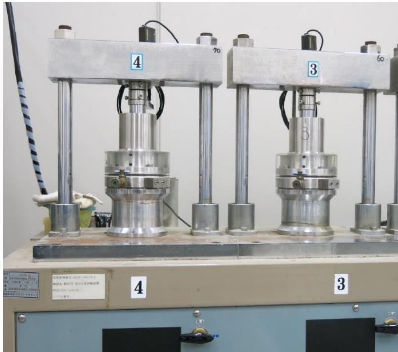
図 3.2.2-33 圧密試験装置
