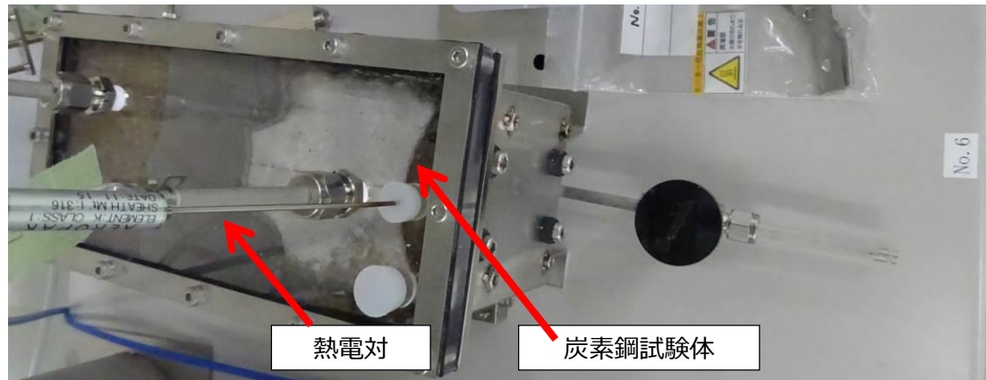
図 3.6.2-3 経時変化確認試験外観（炭素鋼試験体）
