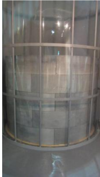
図 3.5.2-22 模擬処分孔への定置 (5 段) [18]
