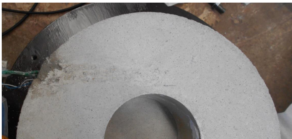
図 3.5.2-26 不均質条件試験装置 無加水ベントナイトによるセンサーの充填
