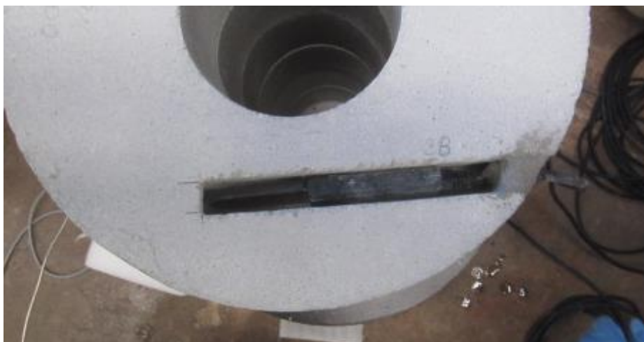
図 3.4.2-12 地上工学規模試験装置 加水ベントナイトによるセンサーの充填
