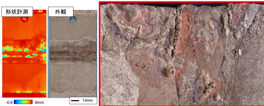
図 2.2.2-1 酸化性雰囲気での浸漬試験による TIG 溶接試験片の選択腐食
