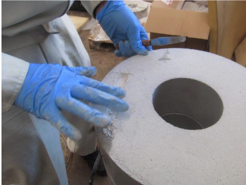
図 3.4.2-13 地上工学規模試験装置 無加水ベントナイトによるセンサーの充填
