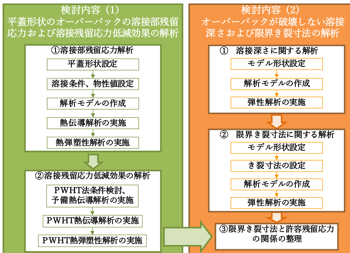
図 3.7.4-1 溶接部の限界き裂寸法（平蓋形状）に関する検討手順
