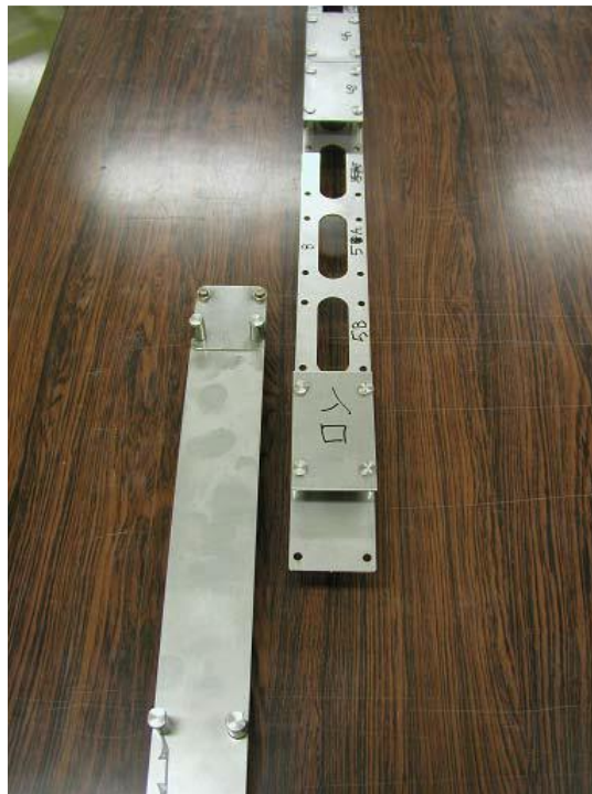
図 5.5.1-5 試験片固定治具の外観
