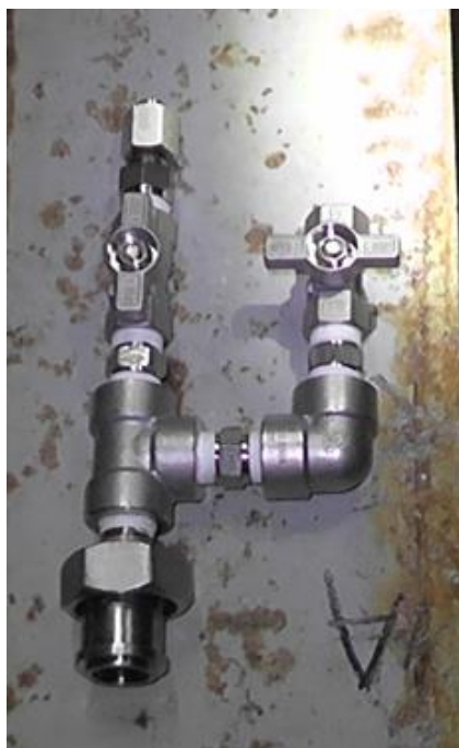
図 3.4.1-5 地下工学規模試験装置 新設したベント管
