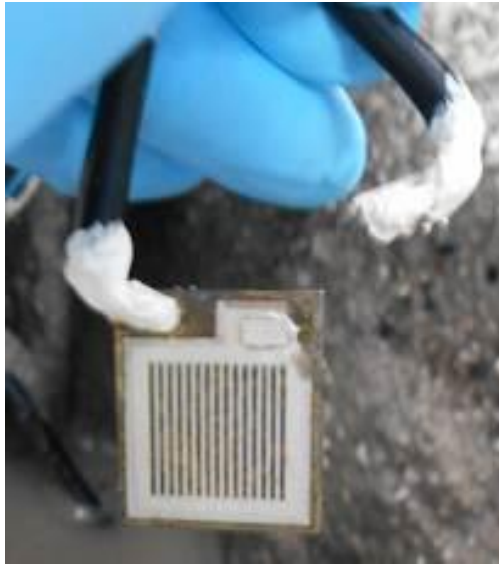
図 3.4.2-20 117 日試験後の砂層の ACM センサー
