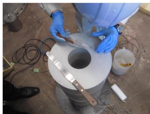
図 3.7.4-2 プローブ電極のベントナイトへの埋め込み
