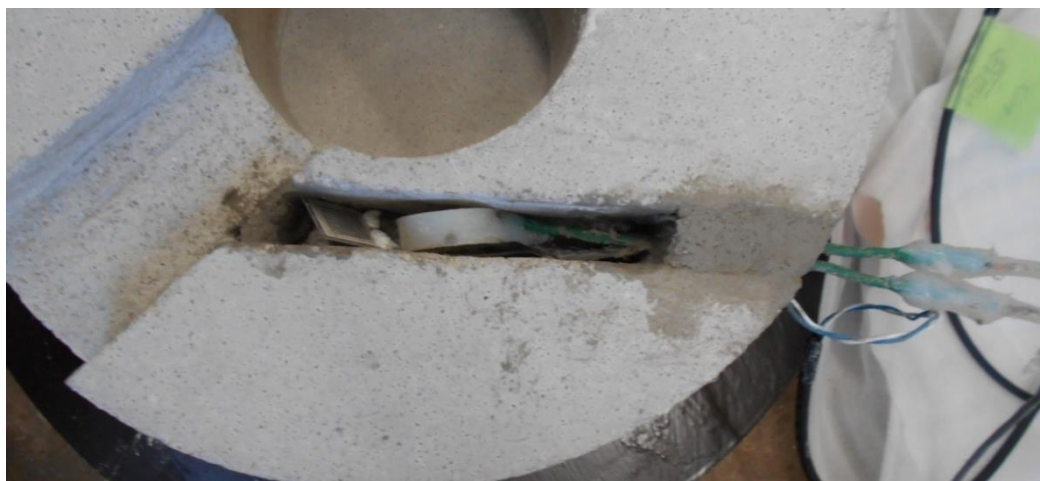
図 3.5.2-25 不均質条件試験装置 加水ベントナイトによるセンサーの充填
