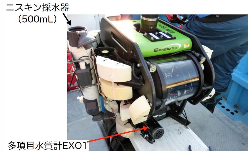
図 3-2-2-1 ROV の概観 (前面に光学カメラを備える)
